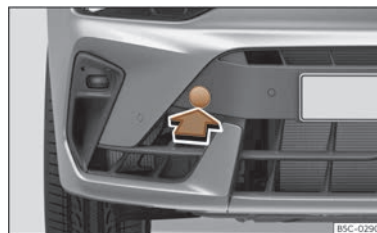
Fig. 219 En el lado derecho del paragolpes delantero: retirar la tapa.
