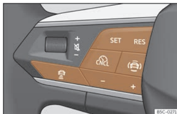
Fig. 140 En el volante multifunción: botones para manejar el ACC.
