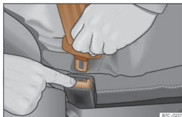
Fig. 23 Soltar la lengüeta del cierre del cinturón.
