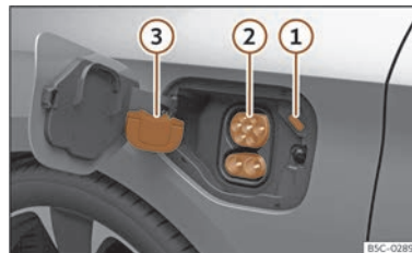
Fig. 62 Detrás de la tapa de la toma de carga de la batería, en la parte trasera derecha: toma de carga.
