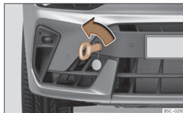
Fig. 220 Parte derecha del parachoques delantero: argolla de remolque enroscada.
