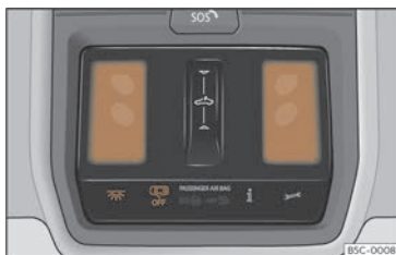
Fig. 109 Detalle del revestimiento del techo: iluminación delantera del habitáculo.
