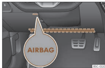
Fig. 35 En el lado del conductor: ubicación del airbag para las rodillas.
