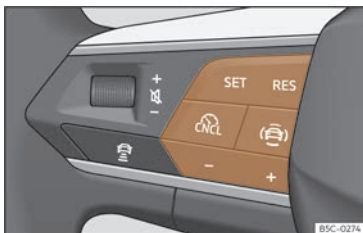
Fig. 136 En el volante multifunción: botones para manejar el regulador de velocidad.
