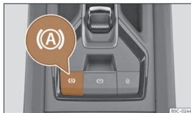
Fig. 155 En la parte inferior de la consola central: tecla de la función Auto Hold.
