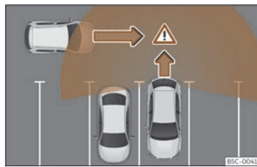
Fig. 165 Representación esquemática del asistente de desaparcamiento: zona vigilada alrededor del vehículo que está desaparcando.
