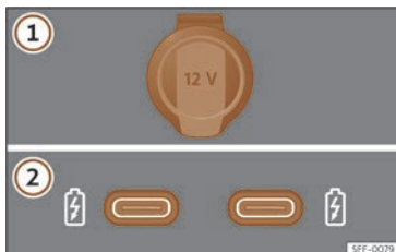
Fig. 171 Tomas de corriente de 12 voltios del vehículo.
