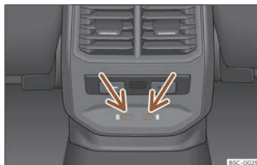
Fig. 174 Parte posterior consola central: conectores USB con función de toma de corriente.
