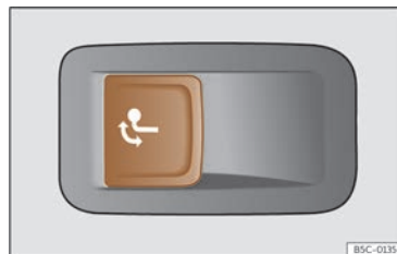
Fig. 205 En el lado izquierdo del maletero: tecla para desbloquear el gancho de remolque.
