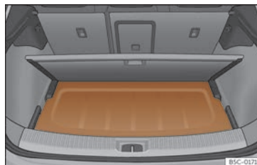
Fig. 184 En el maletero: colocación de la bandeja.
