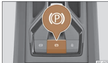
Fig. 154 En la parte inferior de la consola central: tecla del freno de estacionamiento electrónico.
