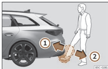
Fig. 85 Portón del maletero con apertura controlada por sensor (Easy Open).
