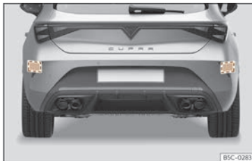
Fig. 133 Vista trasera del vehículo: zonas de los sensores de radar.
