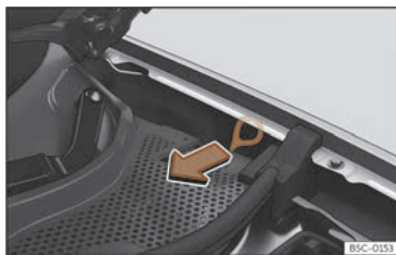
Fig. 65 Entre la aleta izquierda y la bisagra del capó del motor: Tirador para el desbloqueo manual de emergencia del conector de carga.
