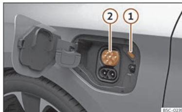
Fig. 60 Detrás de la tapa de carga de la batería en la parte delantera izquierda: Toma de carga.
