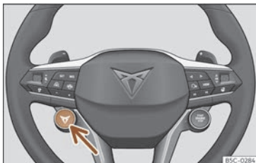
Fig. 127 Volante multifunción: botón para cambiar el perfil de conducción.
