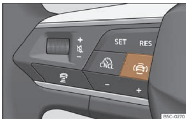
Fig. 129 Lado izquierdo del volante multifunción: tecla para los sistemas de asistencia al conductor (según versiones).
