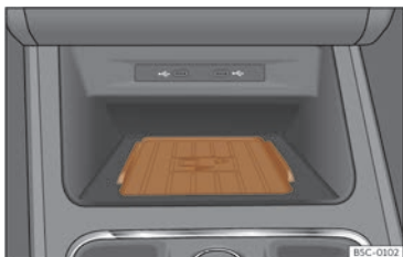
Fig. 180 En la consola central: alojamiento para la conexión del teléfono móvil.
