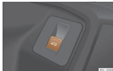
Fig. 84 En la puerta del conductor: tecla para abrir y cerrar el portón trasero.
