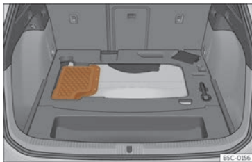
Fig. 238 Vehículos híbridos (PHEV): ubicación de la batería en el maletero
