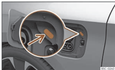
Fig. 63 Detrás de la tapa de la toma de carga de la batería: indicador del proceso de carga.
