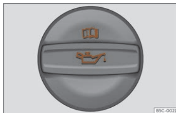
Fig. 237 Tapa de la boca de llenado de aceite del motor en el vano motor.
