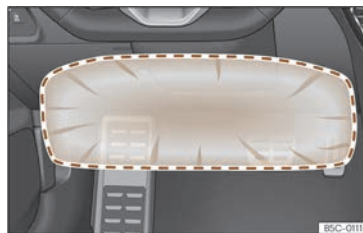
Fig. 36 En el lado del conductor: radio de acción del airbag para las rodillas.
