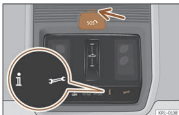
Fig. 51 En la consola del techo: mandos para los servicios de voz.
