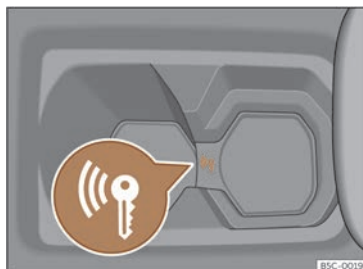
Fig. 121 En la consola central: arranque de emergencia.
