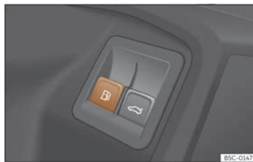
Fig. 210 Puerta del conductor: desbloqueo de la tapa del depósito.
