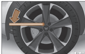
Fig. 248 Cambio de rueda: aflojar los tornillos de rueda.
