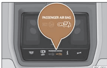
Fig. 29 En la consola del techo: testigo de control de la desactivación del airbag del acompañante.
