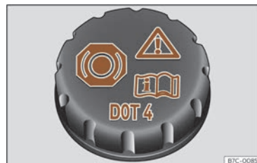
Fig. 231 Vano delantero: tapón del depósito del líquido de frenos.
