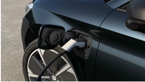
Toma de carga
