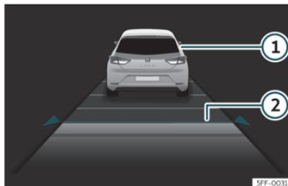
**Fig. 152** En la pantalla del cuadro de instrumentos: ACC activo.
