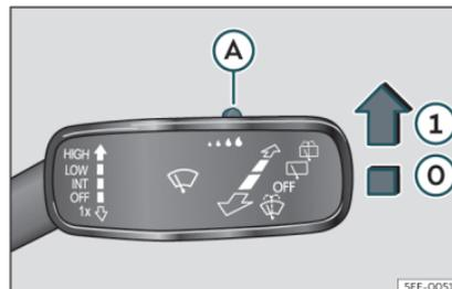
Fig. 91 Palanca del limpiaparabrisas: ajustar el sensor de lluvia (A).
