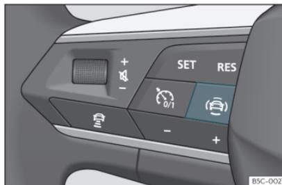
**Fig. 58** Lado izquierdo del volante multifunción: tecla para los sistemas de asistencia al conductor (según versiones).
