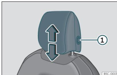
**Fig. 97** Asiento delantero: regulación del apoyacabezas.
