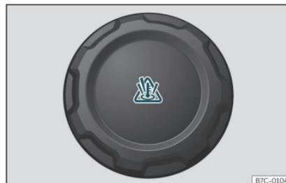
Fig. 189 Vano motor: tapón del depósito de expansión del líquido refrigerante.
