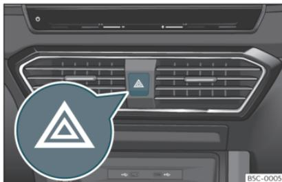
**Fig. 87** Tablero de instrumentos: conmutador de los intermitentes de emergencia.
