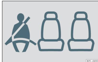
**Fig. 5** Cuadro de instrumentos: indicación de plaza posterior izquierda ocupada y abrochado el cinturón correspondiente.
