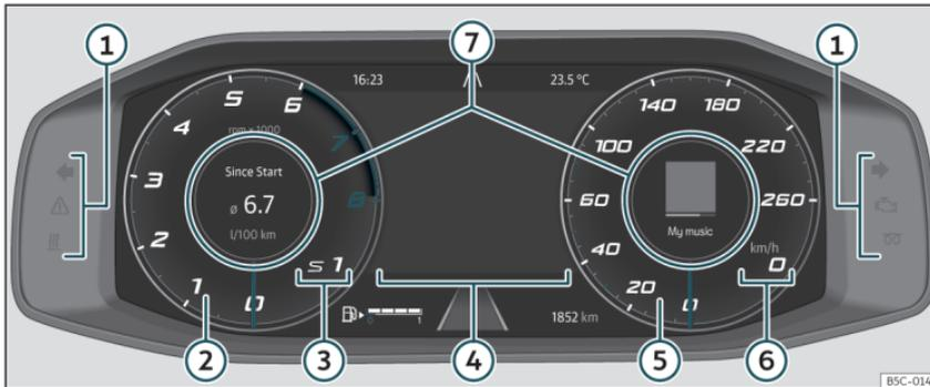
Fig. 51 Digital Cockpit en el tablero de instrumentos (vista clásica).
