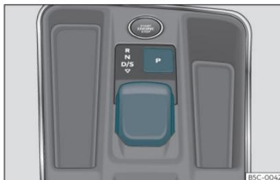
Fig. 137 En la consola central: mando selector.
