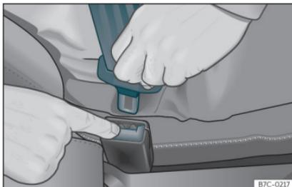
**Fig. 10** Soltar la lengüeta del cierre del cinturón.
