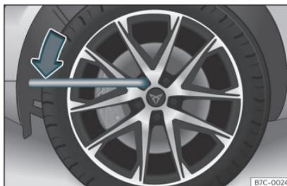
Fig. 37 Cambio de rueda: aflojar los tornillos de rueda.
