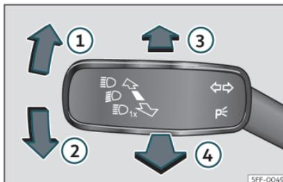
**Fig. 86** Palanca de intermitentes y de luz de carretera (según versiones).
