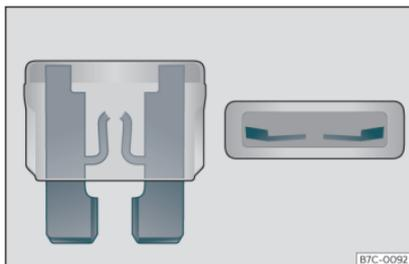
Fig. 49 Representación de un fusible fundido.
