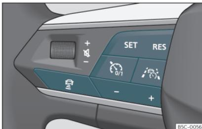
**Fig. 159** Lado izquierdo del volante multifunción: teclas para el manejo del Travel Assist.
