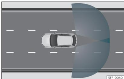
**Fig. 144** Zonas de detección de los sensores
