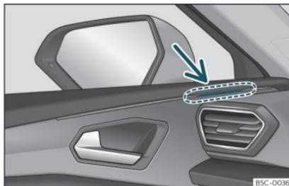
Fig. 160 Testigo de control del asistente de cambio de carril.
