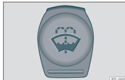
Fig. 191 En el vano motor: tapón del depósito de limpiacristales.
