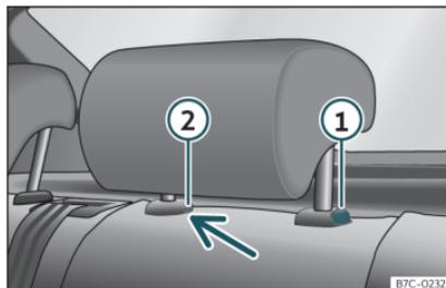
**Fig. 99** Apoyacabezas trasero: desmontaje.
