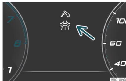
Fig. 54 Indicación de la asistencia para una conducción ecoeficiente (representación esquemática).
