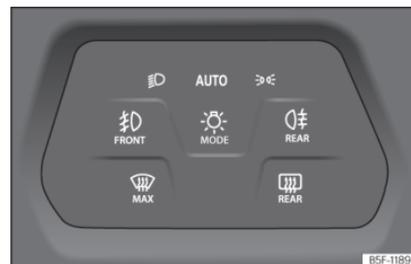
Fig. 85 Tablero de instrumentos: mando de las luces.
