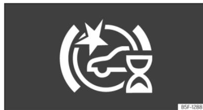
Fig. 149 En la pantalla del cuadro de instrumentos: indicación de autocalibración inicial del sistema.
