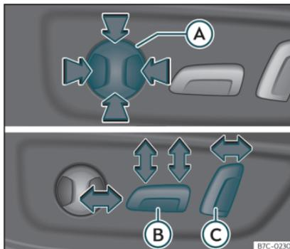
Fig. 96 Asiento del conductor: ajuste eléctrico del asiento.
