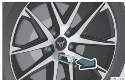
**Fig. 35** Rueda: tornillos de la rueda con capuchones.
