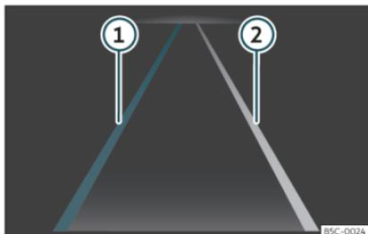
**Fig. 156** En la pantalla del cuadro de instrumentos: indicaciones del sistema de aviso de salida del carril.
