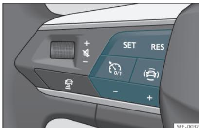
Fig. 147 En el volante multifunción: botones para manejar el limitador de velocidad
