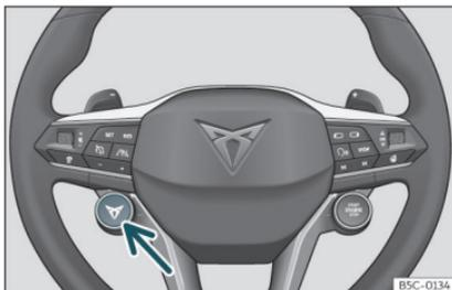
**Fig. 139** Volante multifunción\*: botón para cambiar el perfil de conducción.
