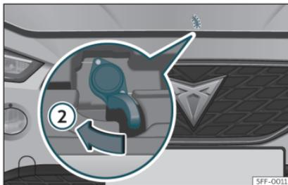
**Fig. 184** Palanca bajo el capó.
