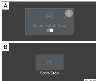
**Fig. 136** En la pantalla del sistema de infotainment: sistema Start-Stop conectado. **[A]** Vista en el menú principal. **[B]** Vista con el sistema de infotainment apagado.
