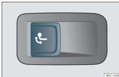
**Fig. 179** En el lado izquierdo del maletero: tecla para desbloquear el gancho de remolque.
