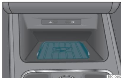
**Fig. 131** En la consola central: alojamiento para la conexión del teléfono móvil.
