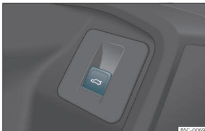
Fig. 79 En la puerta del conductor: tecla para abrir y cerrar el portón trasero.
