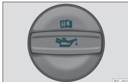
Fig. 187 Tapón de la boca de llenado de aceite del motor en el vano motor.
