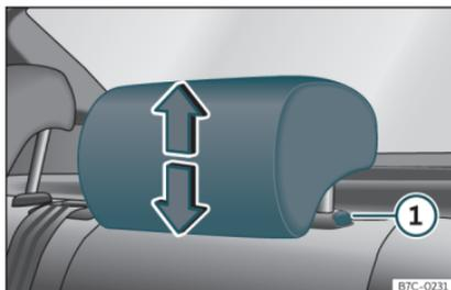
**Fig. 98** Apoyacabezas trasero: regulación del apoyacabezas.
