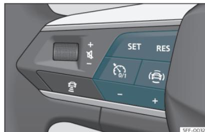
Fig. 146 En el volante multifunción: botones para manejar el regulador de velocidad
