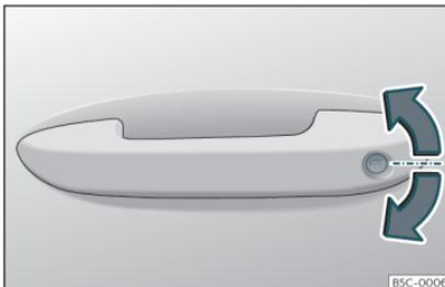
Fig. 74 Manecilla de la puerta del conductor: bombín de cierre.
