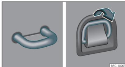
Fig. 111 En el maletero: argollas de amarre fija y desplegable.
