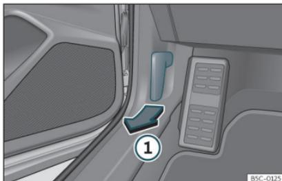
**Fig. 183** Palanca de desbloqueo en el espacio reposapiés del conductor.
