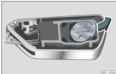
**Fig. 69** Llave del vehículo: extracción de la pila.
