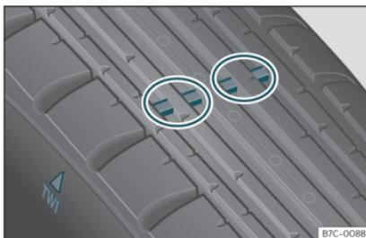
**Fig. 194** Perfil del neumático: indicadores de desgaste.
