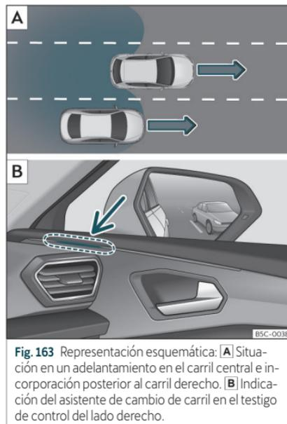
**Fig. 163** Representación esquemática: **A** Situación en un adelantamiento en el carril central e incorporación posterior al carril derecho. **B** Indicación del asistente de cambio de carril en el testigo de control del lado derecho.
