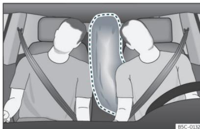
**Fig. 20** Airbag central completamente inflado (zona de despliegue).
