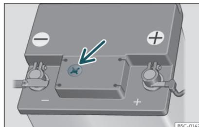
Fig. 192 Mirilla en la parte superior de la batería de 12 voltios (representación esquemática).
