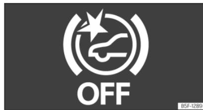
**Fig. 150** En la pantalla del cuadro de instrumentos: indicación de Front Assist desactivado.
