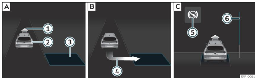
**Fig. 173** En la pantalla del cuadro de instrumentos: aparcar en batería. **[A]** Buscar un hueco de aparcamiento. **[B]** Posición para aparcamiento. **[C]** Maniobrar.
