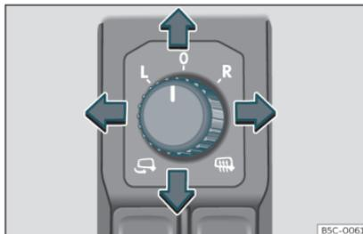
Fig. 93 Detalle de la puerta del conductor: mando para el retrovisor exterior.
