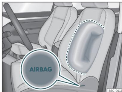
Fig. 21 Airbag lateral en el asiento del conductor.
