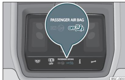
Fig. 16 En la consola del techo: testigo de control de la desactivación del airbag del acompañante.
