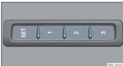
**Fig. 100** En el lateral exterior del asiento del conductor: teclas de memoria.
