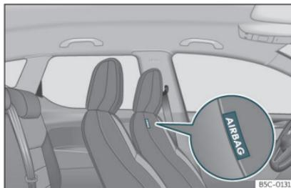
**Fig. 19** En el acolchado interior del respaldo del asiento del conductor: airbag central.
