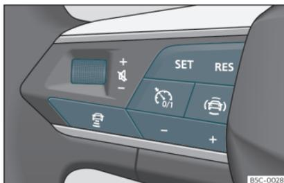
**Fig. 151** En el volante multifunción: botones para manejar el ACC
