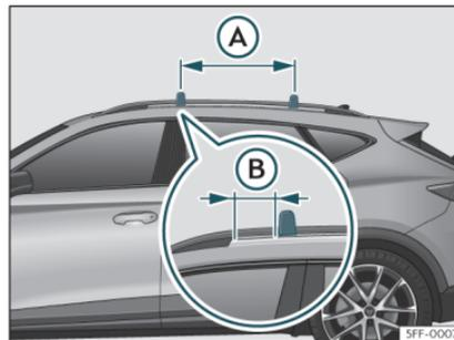
**Fig. 117** Puntos de fijación de las barras longitudinales para el portaequipajes del techo.
