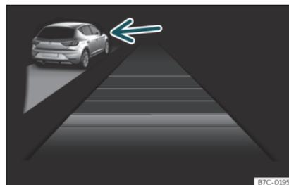
**Fig. 153** En la pantalla del cuadro de instrumentos: ACC activo, vehículo detectado por la izquierda
