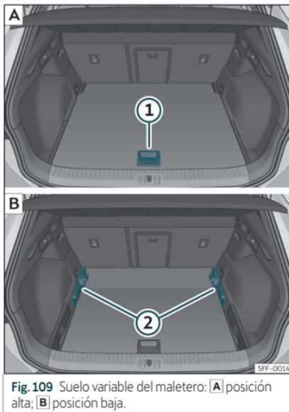
**Fig. 109** Suelo variable del maletero: [A] posición alta; [B] posición baja.
