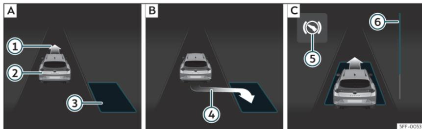
**Fig. 172** En la pantalla del cuadro de instrumentos: aparcar en línea. **[A]** Buscar un hueco de aparcamiento. **[B]** Posición para aparcamiento. **[C]** Maniobrar.
