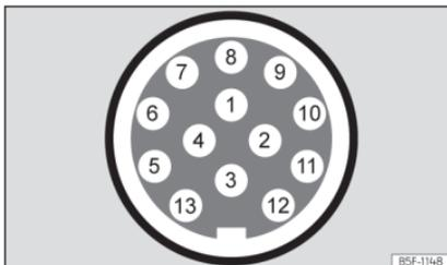
**Fig. 178** Representación esquemática: asignación de los pines de la toma de corriente para remolque.
