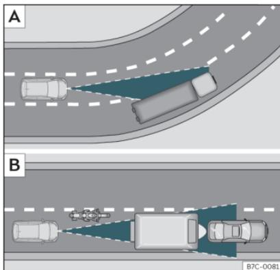
**Fig. 154** **A** Vehículo en una curva. **B** Motociclista circulando por delante fuera del radio de acción del sensor de radar.
