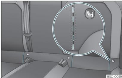
**Fig. 27** Asiento trasero: ranuras troqueladas para acceder a las anillas de sujeción ISOFIX/i-Size.
