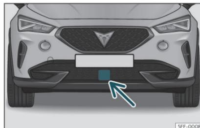
Fig. 140 En el paragolpes delantero: sensor de radar.
