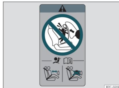
Fig. 26 Adhesivo del airbag: en el marco posterior de la puerta del acompañante
