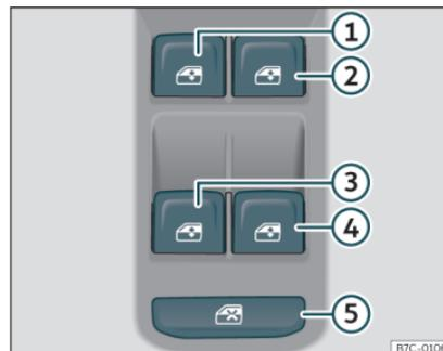
Fig. 82 Detalle de la puerta del conductor: mandos para las ventanillas.
