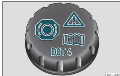
Fig. 190 Vano motor: tapón del depósito del líquido de frenos.
