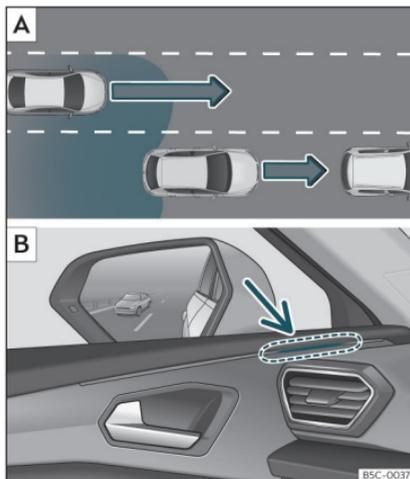
**Fig. 162** Representación esquemática: **A** Situación en un adelantamiento con tráfico en la parte trasera. **B** Indicación del asistente de cambio de carril en el testigo de control del lado izquierdo.
