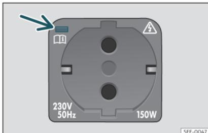
**Fig. 122** En el lado derecho del maletero: toma de corriente de 230 voltios.
