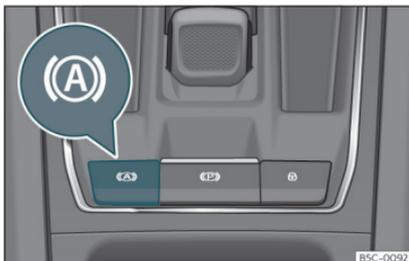
**Fig. 168** En la parte inferior de la consola central: tecla de la función Auto Hold.
