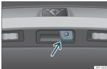
**Fig. 145** En la manecilla del portón trasero: ubicación de la cámara del asistente para marcha atrás.
