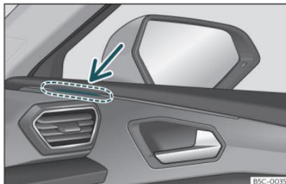
Fig. 161 Testigo de control del asistente de cambio de carril.
