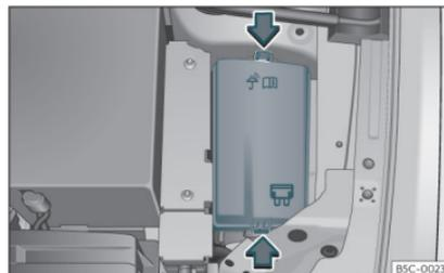
**Fig. 48** En el vano motor: tapa de la caja de fusibles.
