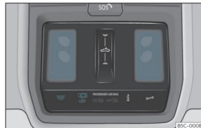
Fig. 88 Detalle del revestimiento del techo: iluminación delantera del habitáculo.
