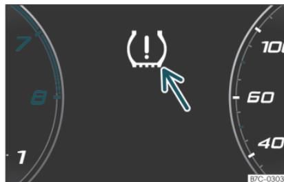
**Fig. 196** Cuadro de instrumentos: aviso de pérdida de presión de los neumáticos.
