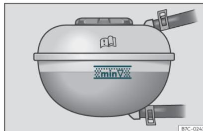
Fig. 188 En el vano motor: marca en el depósito de expansión del líquido refrigerante.
