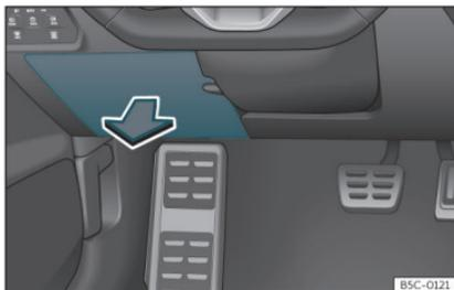
**Fig. 47** En el tablero de instrumentos del lado del conductor: tapa de la caja de fusibles.
