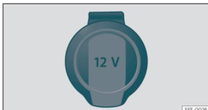
**Fig. 121** Toma de corriente de 12 voltios: ① en el interior del reposabrazos delantero.
