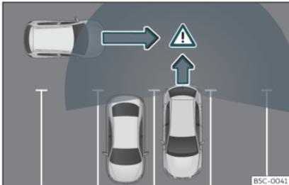
**Fig. 164** Representación esquemática del asistente de desaparcamiento: zona vigilada alrededor del vehículo que está desaparcando.
