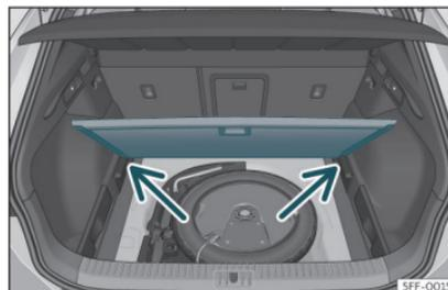
**Fig. 110** Suelo variable del maletero: posición inclinada.
