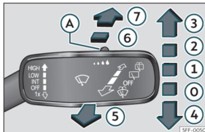
Fig. 90 Manejo del limpiaparabrisas y limpialuneta.
