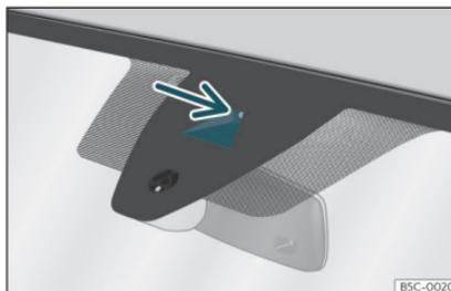
**Fig. 142** En el parabrisas: área de campo visual del sistema de aviso de salida del carril.
