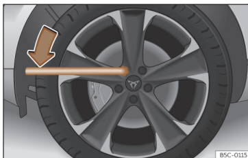
Fig. 167 Cambio de rueda: aflojar los tornillos de rueda.
