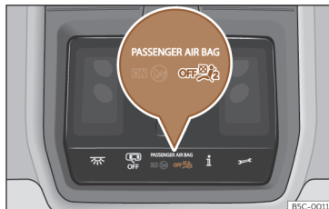
Fig. 26 En la consola del techo: testigo de control de la desactivación del airbag del acompañante.
