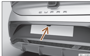
Fig. 100 En el parachoques trasero: ubicación de la cámara del asistente para marcha atrás.
