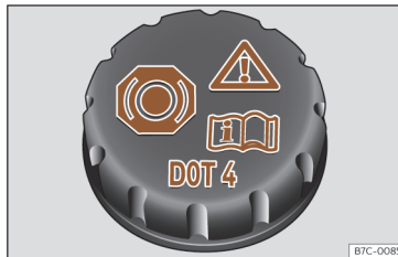
Fig. 159 Vano delantero: tapón del depósito del líquido de frenos.
