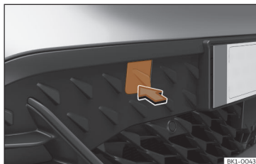
Fig. 149 En el lado derecho del paragolpes delantero: retirar la tapa.
