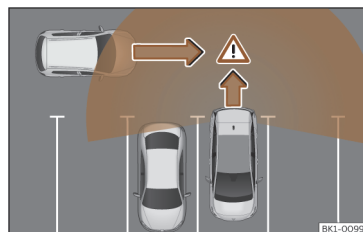
Fig. 115 Representación esquemática del asistente de desaparcamiento: zona vigilada alrededor del vehículo que está desaparcando.
