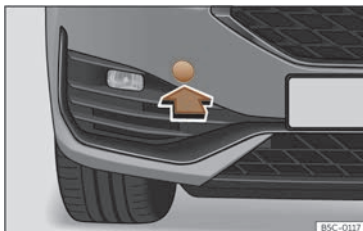
Fig. 206 No lado dereito do parachoques dianteiro: retirar a tapa.
