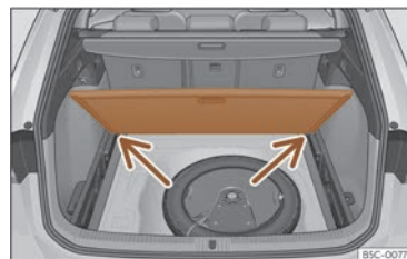
Fig. 180 Piso variable do maletreiro: posición inclinada.
