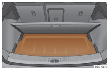
Fig. 174 No maletreiro: colocación da bandexa.
