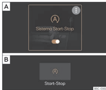
Fig. 113 Na pantalla do sistema de infotainment: sistema Start-Stop conectado. [A] Vista no menú principal. [B] Vista co sistema de Infotainment apagado.
