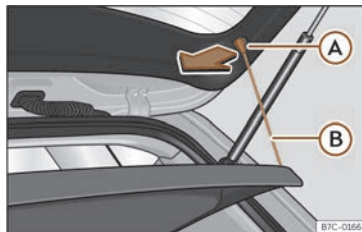
Fig. 171 No maleteiro: desmontar e montar a bandexa.
