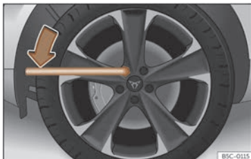
Fig. 234 Cambio de roda: afrouxar os parafusos de roda.
