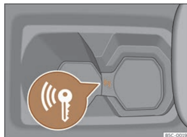
Fig. 112 Na consola central: arranque de emerxencia.
