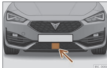
Fig. 121 No parachoques dianteiro: sensor de radar.
