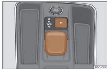
Fig. 115 Na consola central: mando selector.
