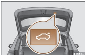
Fig. 76 Portón traseiro: tecla para pechar o portón.
