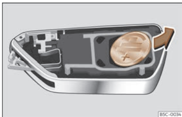
Fig. 67 Chave do vehículo: extracción da pila.
