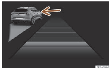
Fig. 131 Na pantalla do quadro de instrumentos: ACC activo, vehículo detectado pola esquerda.
