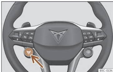
Fig. 117 Volante multifunción: botón para cambiar o perfil de condución.
