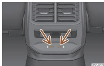
Fig. 164 Parte posterior consola central: conectores USB con función de toma de corrente.
