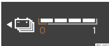
Fig. 5 Cadro de instrumentos dixital: indicador do nivel de batería.
