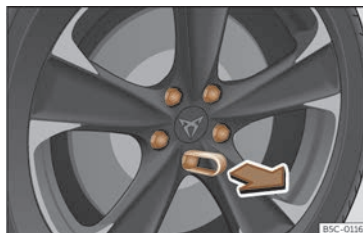
Fig. 232 Roda: parafusos da roda con capuchóns.
