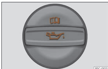
Fig. 223 Tapa da boca de carga de aceite do motor no van motor.
