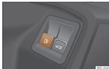
Fig. 200 Porta do condutor: desbloqueo da tapa do depósito.
