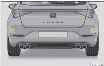
Fig. 124 Vista traseira do vehículo: áreas dos sensores de radar.
