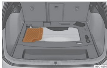
Fig. 224 Vehículos híbridos (PHEV): localización da batería no maleteiro
