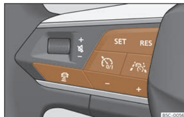
Fig. 139 Lado esquerdo do volante multifunción.
