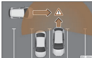
Fig. 155 Representación esquemática do asistente de desaparcamento: área vixiada en torno ao vehículo que está a desparcar.
