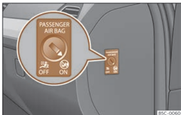
Fig. 29 Conmutador con chave para activar e desactivar o airbag do acompañante.
