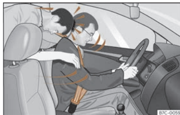
Fig. 22 O ocupante do asento traseiro que non leva posto o cinto de seguridade verase proxeitado cara adiante sobre o condutor que si leva o cinto.
