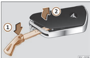
Fig. 66 Chave do vehículo: abrir a tapa do compartimento da pila.
