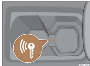
Fig. 112 Na consola central: arranque de emerxencia.
