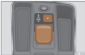
Fig. 115 Na consola central: mando selector.
