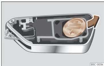
Fig. 67 Chave do vehículo: extracción da pila.
