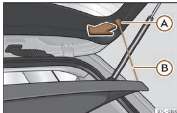
Fig. 171 No maleteiro: desmontar e montar a bandexa.
