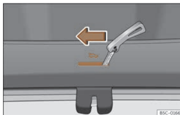
Fig. 79 Detalle do maletreiro: desbloqueo de emerxencia (Leon).
