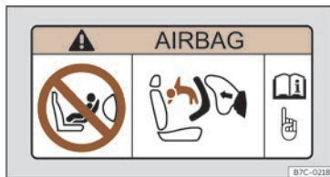
Fig. 39 Adhesivo do airbag: no parasol do lado do acompañante.
