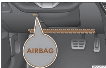
Fig. 36 No lado do condutor: localización do airbag para os xeonllos.
