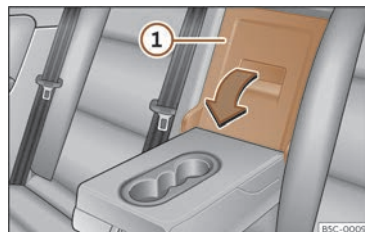
Fig. 190 No respaldo do asento traseiro: apertura da trapela.
