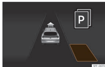
Fig. 149 Na pantalla do cadro de instrumentos: visualización do sistema de aparcamento asistido con visualización reducida.
