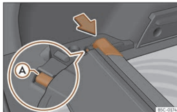
Fig. 178 No maletreiro: aloxamento para gardar a bandexa enrolable.
