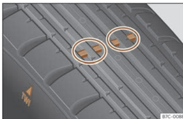
Fig. 227 Perfil do pneumático: indicadores de desgaste.
