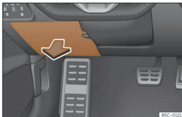
Fig. 210 No taboleiro de instrumentos do lado do condutor: tapa da caixa de fusibles.
