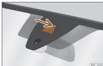
Fig. 123 No parabrisas: área de campo visual do sistema de aviso de saída de carril.
