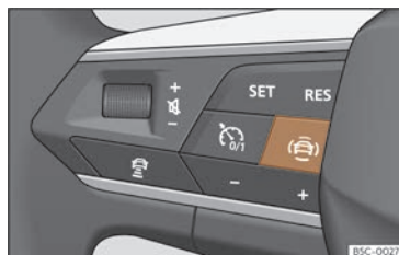
Fig. 120 Lateral esquerdo do volante multifunción: tecla para os sistemas de asistencia ao condutor (segundo versións).
