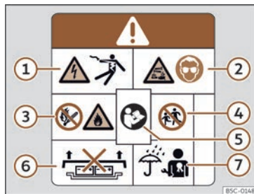
Fig. 53 Rótulo de advertencia na batería de alta voltaxe.
