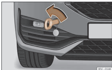
Fig. 207 Parte dereita do parachoques dianteiro: argola de remolque enroscada.
