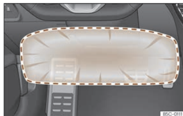
Fig. 22 No lado do condutor: radio de acción do airbag para os xeonllos.
