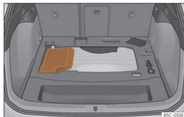
Fig. 227 Vehículos híbridos (PHEV): localización da batería no maleteiro
