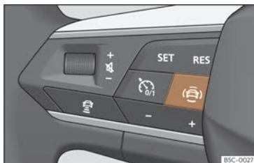
Fig. 66 Lado esquerdo do volante multifunción: tecla para os sistemas de asistencia ao condutor (dependendo das versións).
