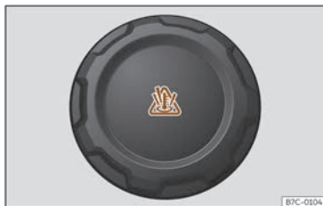
Fig. 224 Van motor: tapón do depósito de expansión do líquido refrixerante.
