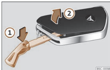
Fig. 77 Chave do vehículo: abrir a tapa do compartimento da pila.
