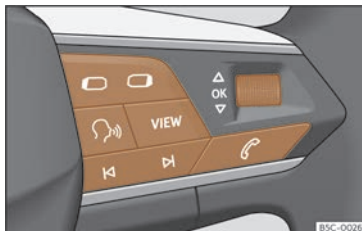
Fig. 64 Lado dereito do volante multifunción: teclas para usar os menús e as indicacións informativas do cadro de instrumentos (segundo versións).
