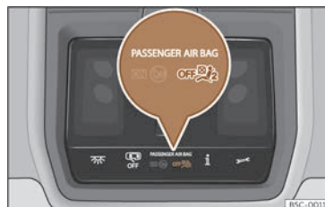
Fig. 20 Na consola do teito: indicador de control da desactivación do airbag do acompañante.
