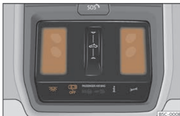
Fig. 98 Detalle do revestimento do teito: iluminación dianteira do habitáculo.
