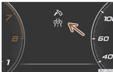
Fig. 59 Indicación de asistencia para unha condución ecoeficiente (representación esquemática).
