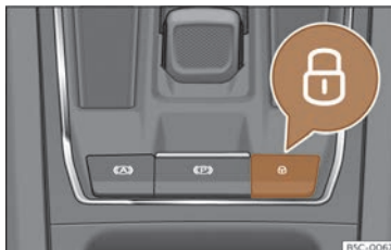
Fig. 80 En consola central: conmutador do peche centralizado
