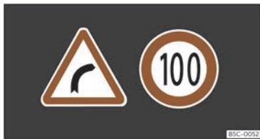
Fig. 58 Na pantalla do cadro de instrumentos: exemplos de sinais recoñecidos.
