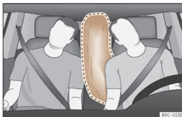
Fig. 24 Airbag central completamente inflado (zona de despregamento).
