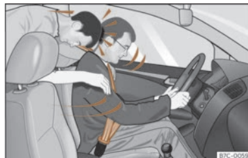
Fig. 12 O ocupante do asento traseiro que non leve posto o cinto de seguridade será lanzado cara adiante sobre o condutor que leva o cinto.
