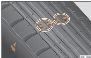
Fig. 230 Perfil do pneumático: indicadores de desgaste.
