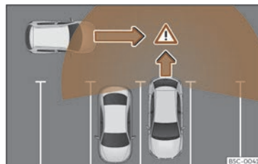
Fig. 184 Representación esquemática do asistente de desaparcamento: zona viaxiada ao redor do vehículo que está a desaparcarse.
