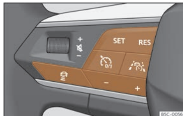
Fig. 179 Lado esquerdo do volante multifunción: teclas para o manexo do Travel Assist.
