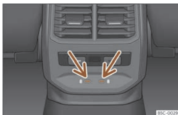
Fig. 153 Parte posterior consola central: conectores USB con función de toma de corriente.
