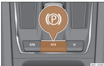
Fig. 187 Na parte inferior da consola central: tecla do freio de estacionamento electrónico.
