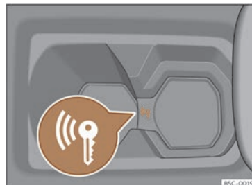
Fig. 155 Na consola central: arranque de emerxencia
