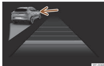
Fig. 173 Na pantalla do cadro de instrumentos: ACC activo, vehículo detectado pola esquerda
