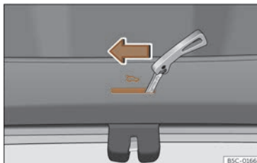
Fig. 90 Detalle do maletreiro:desbloqueo de emerxencia (León).
