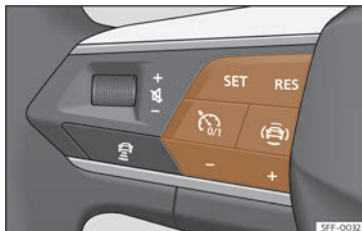
Fig. 168 No volante multifunción: botóns para manexar o regulador de velocidade
