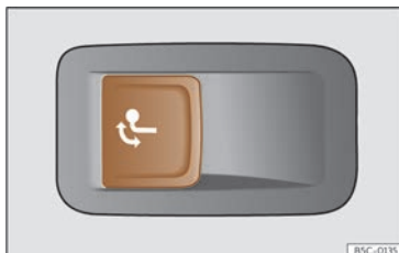
Fig. 201 No lado esquerdo do maletreiro: tecla para desbloquear o gancho de remolque.
