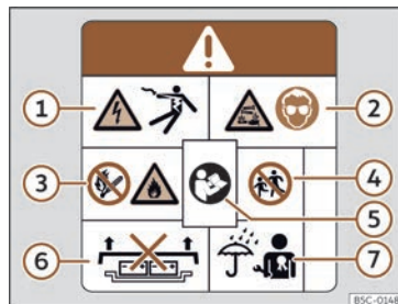
Fig. 204 Rótulo de advertencia na batería de alta voltaxe.
