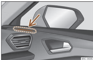
Fig. 183 Indicador de control do asistente de cambio de carril.
