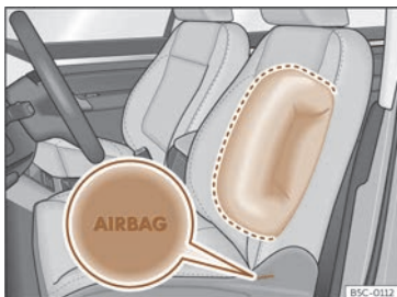
Fig. 25 Airbag lateral no asento do condutor.
