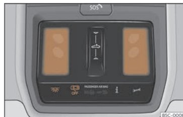
Fig. 99 Detalle do revestimento do teito: iluminación dianteira do habitáculo.
