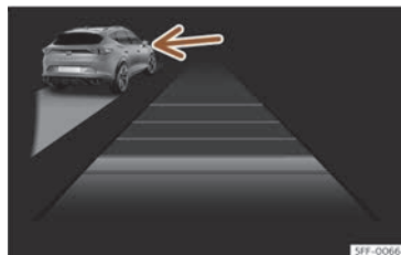
Fig. 175 Na pantalla do cadro de instrumentos: ACC activo, vehículo detectado pola esquerda
