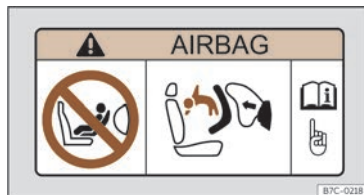
Fig. 29 Adhesivo do airbag: no parasol do lado do acompañante
