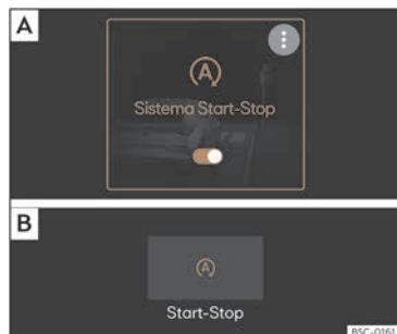
Fig. 158 Na pantalla do sistema de Infotainment: Sistema Start-Stop conectado. [A] Vista no menú principal. [B] Vista co sistema de Infotainment apagado.
