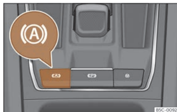
Fig. 190 Na parte inferior da consola central:tecla da función Auto Hold.
