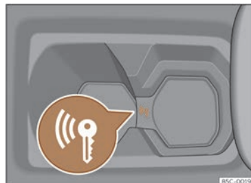
Fig. 157 Na consola central: arranque de emerxencia
