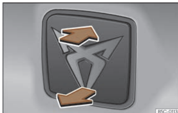
Fig. 87 Portón traseiro: apertura dende o exterior.
