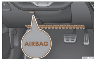
Fig. 21 No lado do condutor: localización do airbag para os xeonllos.
