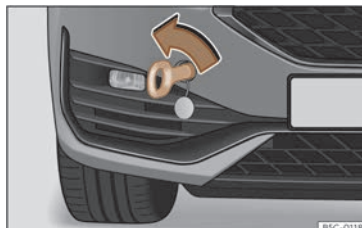
Fig. 49 Parte dereita do parachoques dianteiro:argola de remolque rosca.
