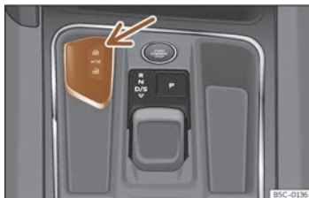
Fig. 76 Consola central: Aloxamento para a chave do vehículo.
