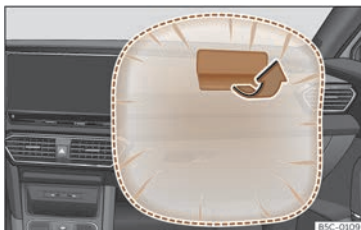
Fig. 18 Airbag do acompañante no taboleiro de instrumentos.
