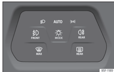
Fig. 96 Taboleiro de instrumentos:mando das luces.
