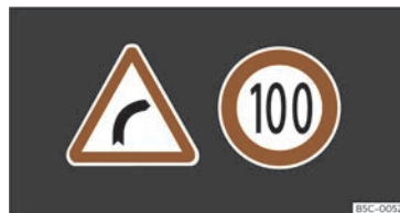
Fig. 59 Na pantalla do cadro de instrumentos: exemplos de sinais recoñecidos.
