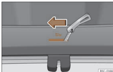
Fig. 91 Detalle do maletreiro:desbloqueo de emerxencia (León).
