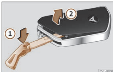
Fig. 78 Chave do vehículo: abrir a tapa do compartimento da pila.
