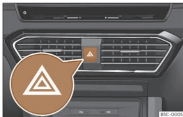
Fig. 98 Taboleiro de instrumentos: conmutador dos intermitentes de emerxencia.
