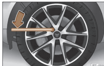
Fig. 42 Cambio de roda:afrouxar os parafusos de roda.
