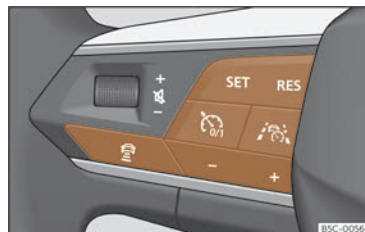
Fig. 181 Lado esquerdo do volante multifunción: teclas para o manexo do Travel Assist.
