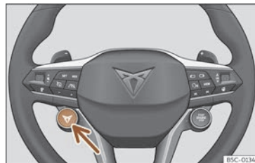
Fig. 161 Volante multifunción: botón para cambiar o perfil de condución.
