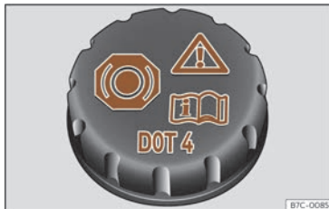
Fig. 227 Van motor: tapón do depósito do líquido de freos.
