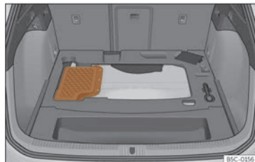
Fig. 229 Vehículos híbridos (PHEV): localización da batería no maleteiro
