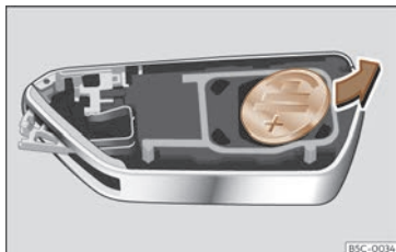
Fig. 79 Chave do vehículo: extracción da pila.
