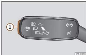
Fig. 66 Na panca de intermitentes e de luz de estrada: tecla para os sistemas de asistencia ao condutor (dependendo das versións).
