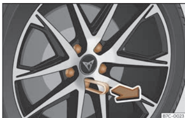
Fig. 40 Roda:parafusos da roda con capuchóns.
