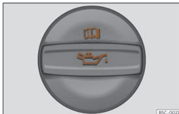
Fig. 223 Tapón da boca de carga de aceite do motor no van motor.
