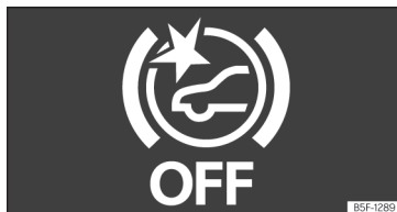
Fig. 172 Na pantalla do cadro de instrumentos: indicación de Front Assist desactivado.
