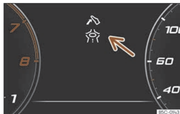
Fig. 60 Indicación de asistencia para unha condución ecoeficiente (representación esquemática).
