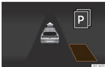
Fig. 192 Na pantalla do cadro de instrumentos: visualización do sistema de aparcamento asistido con visualización reducida.
