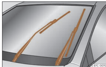
Fig. 45 Limpapara-brisas en posición de servizo.
