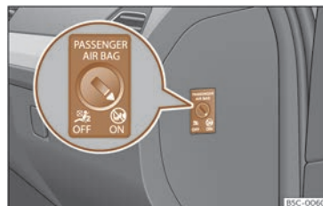
Fig. 19 Conmutador con chave para activar e desactivar o airbag do acompañante.
