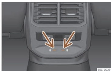
Fig. 155 Parte posterior consola central: conectores USB con función de toma de corrente.
