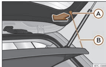
Fig. 117 No maleteiro: desmontar e montar a bandexa.
