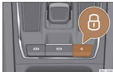
Fig. 81 En consola central: conmutador do peche centralizado
