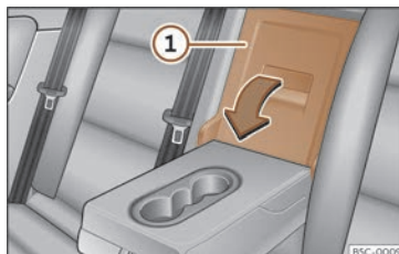
Fig. 132 No respaldo do asento traseiro:apertura da trapela.
