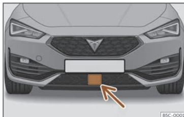
Fig. 162 No parachoques dianteiro: sensor de radar.
