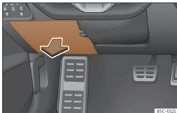
Fig. 52 No taboleiro de instrumentos do lado do condutor: tapa da caixa de fusibles.
