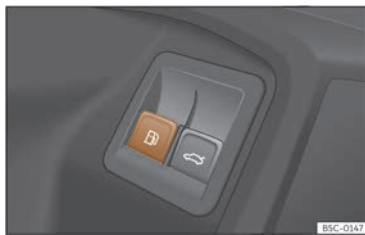
Fig. 214 Porta do condutor:desbloqueo da tapa do depósito.
