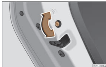
Fig. 86 Seguro para nenos da porta da esquerda.
