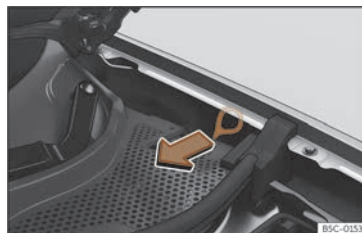
Fig. 210 Entre a á esquerda e a bisagra do capó do motor: Empuñadura para o desbloqueo manual de emerxencia do conector de carga.
