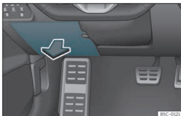
Fig. 51 No taboleiro de instrumentos do lado do condutor: tapa da caixa de fusibles.
