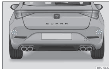
Fig. 162 Vista traseira do vehículo: zonas dos sensores de radar.
