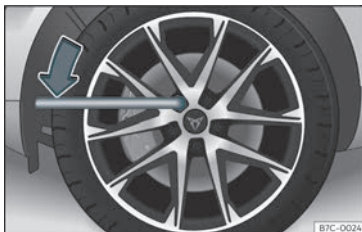
Fig. 41 Cambio de roda:afrouxar os parafusos de roda.
