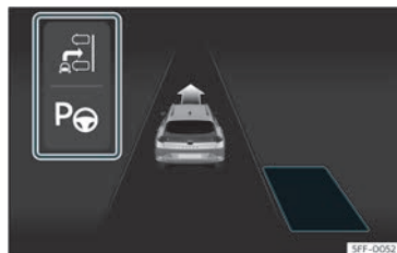
Fig. 189 Na pantalla do cadro de instrumentos: visualización do sistema de aparcamento asistido con visualización reducida.
