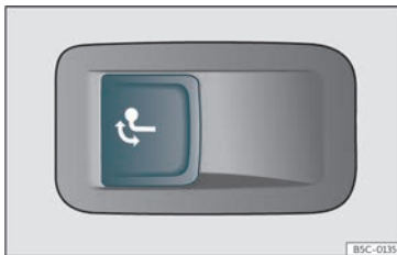
Fig. 198 No lado esquerdo do maleteiro: tecla para desbloquear o gancho de remolque.
