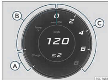
Fig. 61 Cadro de instrumentos dixital: Powermeter (vista Cupra)
