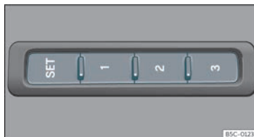
Fig. 109 No lateral exterior do asento do condutor: teclas de memoria.
