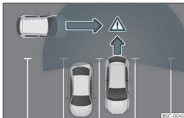
Fig. 183 Representación esquemática do asistente de desaparcamento: zona vixiada ao redor do vehículo que está a desparcar.
