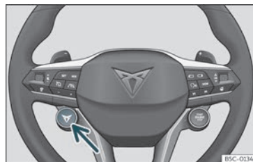
Fig. 158 Volante multifunción*: botón para cambiar o perfil de condución.
