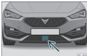
Fig. 159 No parachoques dianteiro: sensor de radar.
