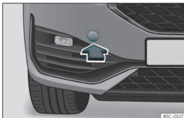
Fig. 47 No lado dereito do parachoques dianteiro: retirar a tapa.
