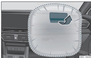
Fig. 18 Airbag do acompañante no taboleiro de instrumentos.
