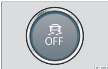
Fig. 188 Na parte inferior da consola central: botón para conectar/desconectar o ESC
