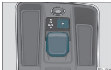
Fig. 156 Na consola central:mando selector.
