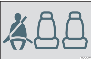
Fig. 9 Cadro de instrumentos: indicación de praza posterior esquerda ocupada e abrochado o cinto correspondente.
