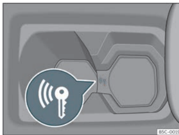
Fig. 154 Na consola central: arranque de emerxencia
