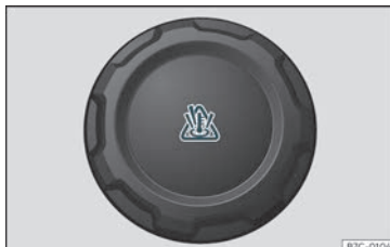
Fig. 218 Van motor: tapón do depósito de expansión do líquido refrixerante.
