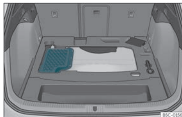
Fig. 222 Localización da batería no maleteiro
