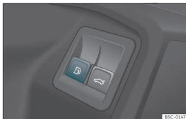
Fig. 209 Porta do condutor: desbloqueo da tapa do depósito.
