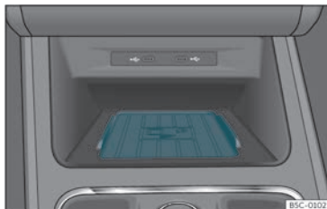
Fig. 150 Na consola central: aloxamento para a conexión do teléfono móbil.
