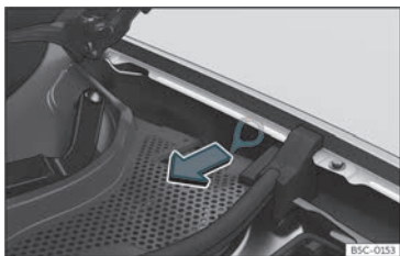
Fig. 205 Entre a á esquerda e a bisagra do capó do motor: Empuñadura para o desbloqueo manual de emerxencia do conector de carga.
