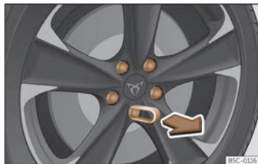
232. irudia Gupila: gupilaren torlojuak txanoekin.
