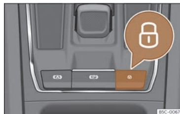
71. irudia Erdiko konsolan: ixte-sistema zentralizatuaren kommutadorea
