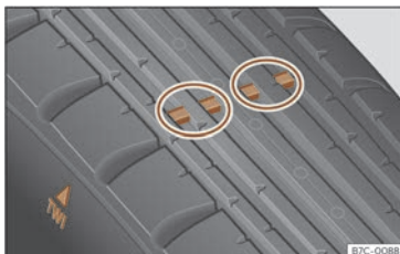
228. irudia Pneumatikoaren profila: higadura-adierazleak.
