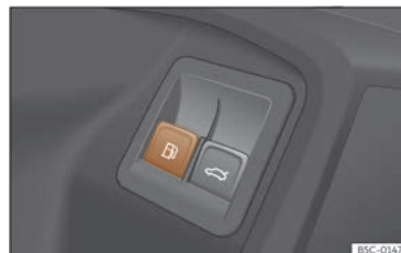
200. irudia Gidariaren atea: deposituko estalkia desblokeatzea.
