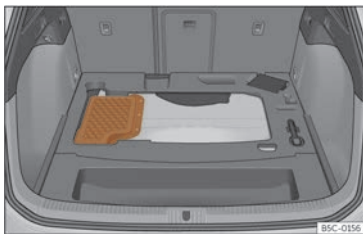
224. irudia Ibilgailu hibridoak (PHEV): bateriaren kokapena maletategian
