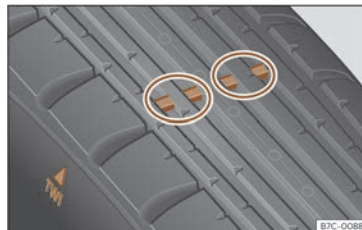
230 ir. Pneumatikoaren profila:higadura- seinaleak.
