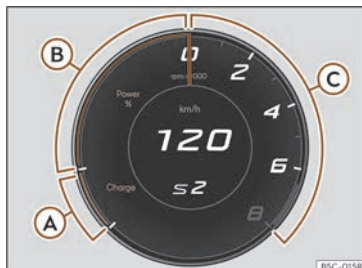
61 ir. Tresnen koadro digitala:Powermeter (Cupra ikuspegia)
