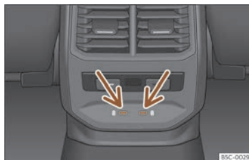
155 ir. Kotsola zentralaren atzeko atala:korrante-harguneko funtzioa duten USB konektoreak.
