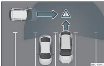
183 ir. Desaparkatzeko laguntzailearen adierazpen eskematikoa:desaparkatzen ari den ibilgailuaren inguruko eremu zaindua.
