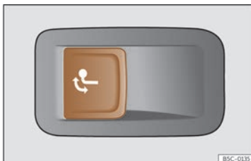
Fig. 195 Al costat esquerre del maleter: tecla per desbloquejar el ganxo de remolc.
