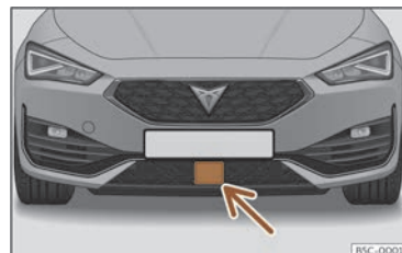
Fig. 121 Al para-xocs davanter: sensor de radar.
