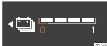
Fig. 5 Quadre d'instruments digital: indicador del nivell de bateria.
