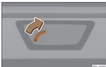
Fig. 80 Detall del maletger: desbloqueig d'emergència (Leon Sportstourer).
