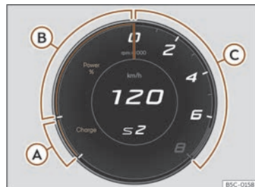
Fig. 7 Quadre d'instruments digital: Powermeter (vista Cupra)
