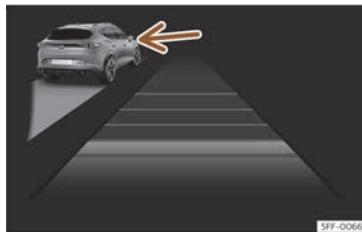
Fig. 131 A la pantalla del quadre d'instruments: ACC actiu, vehicle detectat per l'esquerra.
