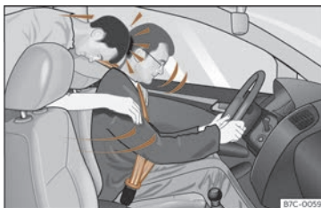
Fig. 22 L'ocupant del seient del darrere que no porti el cinturó de seguretat es veurà projectat cap endavant sobre el conductor que sí que porta el cinturó.
