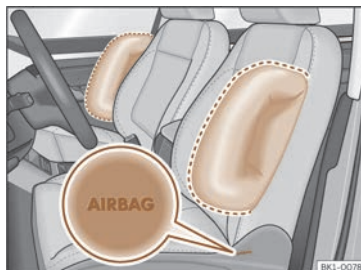
Fig. 33 Coixí de seguretat lateral al seient del conductor i de l'acompanyant.
