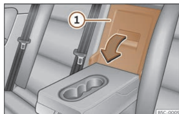
Fig. 190 Al respall del seient del darrere: obertura de la trapa.
