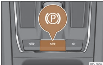
Fig. 145 A la part inferior de la consola central: tecla del fre d'estacionament electrònic.
