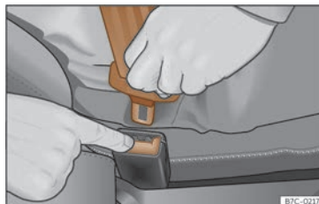
Fig. 24 Deixar anar la llengüeta del tancament del cinturó.
