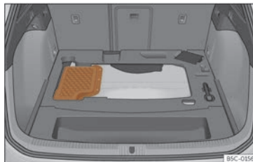
Fig. 224 Vehicles híbrids (PHEV): ubicació de la bateria al maleter
