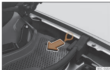
Fig. 59 Entre l'aleta esquerra i la frontissa del capó del motor: Tirador per al desbloqueig manual d'emergència del connector de càrrega.
