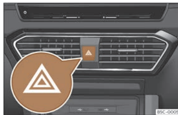
Fig. 49 Tauler d'instruments: commutador dels intermitents d'emergència.
