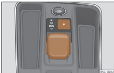
Fig. 115 A la consola central: comandament selector.
