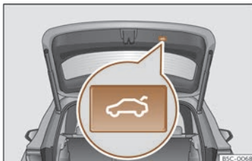
Fig. 76 Porta posterior: tecla per a tancar la porta.
