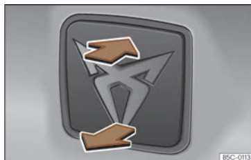
Fig. 75 Porta posterior: obertura des de fora.
