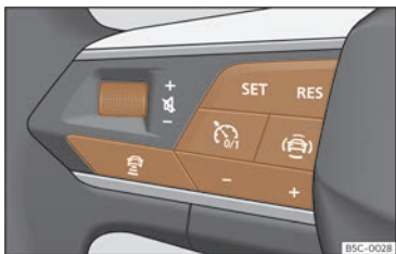
Fig. 130 Al volant multifunció: botons per fer servir l'ACC.
