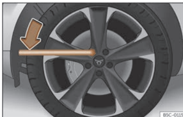
Fig. 234 Canvi de roda: afluixar els caragols de roda.
