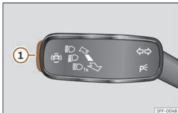
Fig. 119 A la palanca d'intermitents i de llum de carretera: tecla per als sistemes d'assistència al conductor (segons versions).
