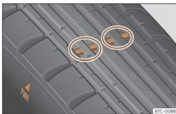
Fig. 228 Perfil del pneumàtic: indicadors de desgast.
