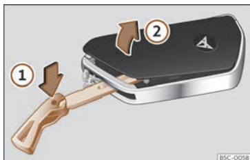
Fig. 66 Clau del vehicle: obrir la tapa del compartiment de la pila.
