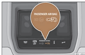
Fig. 30 A la consola del sostre: indicador de control de la desactivació del coixí de seguretat de l'acompanyant.
