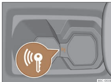
Fig. 112 A la consola central: arrencada d'emergència.
