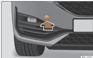
Fig. 206 A la part dreta del para-xocs davanter: retirar la tapa.
