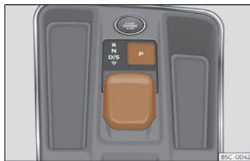
Fig. 115 A la consola central: comandament selector.
