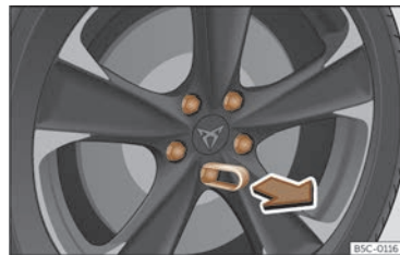
Fig. 231 Roda: caragols de la roda amb caputxons.
