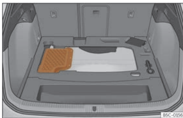
Fig. 224 Vehicles híbrids (PHEV): ubicació de la bateria al maletger
