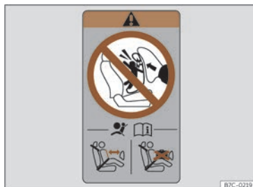
Fig. 40 Adhesiu del coixí de seguretat: al marc posterior de la porta de l'acompanyant.
