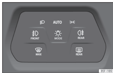
Fig. 99 Tauler d'instruments: comandament dels llums.
