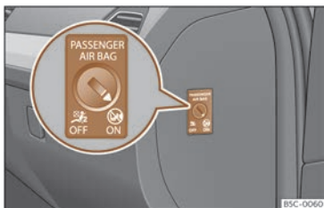
Fig. 29 Commutador amb clau per activar i desactivar el coixí de seguretat de l'acompanyant.
