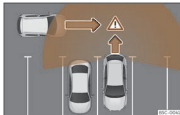
Fig. 155 Representació esquemàtica de l'assistent de sortida de l'aparcament: zona vigilada al voltant del vehicle que està sortint de l'aparcament.
