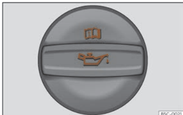
Fig. 223 Tapa de la boca d'ompliment d'oli del motor al compartiment del motor.
