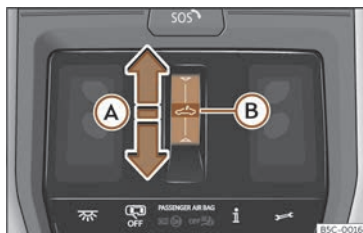
Fig. 82 En el revestiment interior del sostre: tecla del sostre de vidre.
