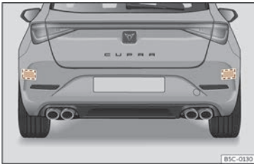
Fig. 124 Vista posterior del vehicle: zones dels sensors de radar.
