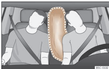
Fig. 32 Coixí de seguretat central completament inflat (zona de desplegament).
