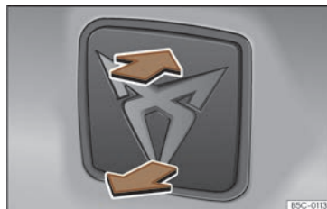
Fig. 75 Porta posterior: obertura des de fora.
