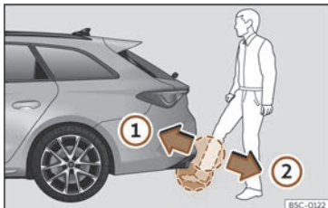
Fig. 78 Porta del maletser amb obertura controlada per sensor (Easy Open).
