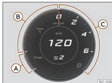
Fig. 7 Quadre d'instruments digital: Powermeter (vista Cupra)
