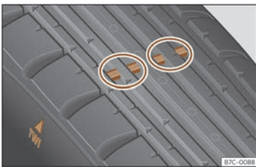
Fig. 227 Perfil del pneumàtic: indicadors de desgast.
