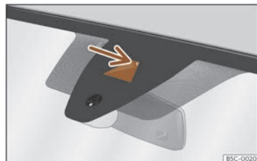
Fig. 123 Al parabrisa: àrea de camp visual del sistema d'avís de sortida del carril.
