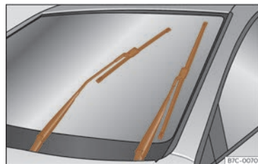
Fig. 203 Eixugaparabrises en posició de servei.
