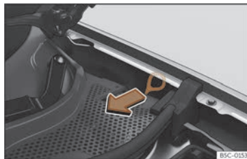
Fig. 208 Entre l'aleta esquerra i la frontissa del capó del motor: Tirador per al desbloqueig manual d'emergència del connector de càrrega.
