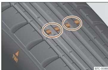
Fig. 230 Perfil del pneumàtic: Indicadors de desgast.
