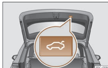
Fig. 87 Porta posterior: tecla per tancar la porta posterior.
