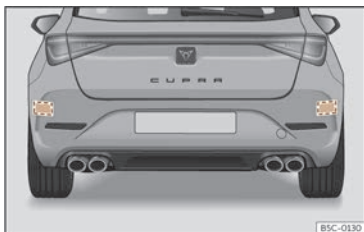
Fig. 163 Vista posterior del vehicle: zones dels sensors de radar.
