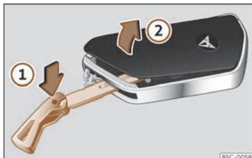
Fig. 77 Clau del vehicle: obrir la tapa del compartiment de la pila.
