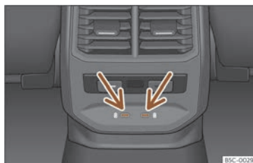
Fig. 153 Part posterior consola central: connectors USB amb funció de presa de corrent.
