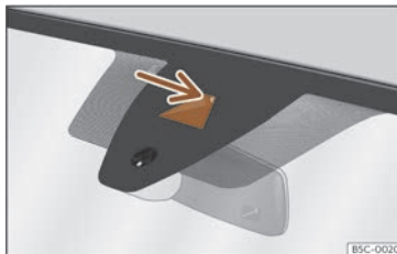
Fig. 162 Al parabrisa: àrea de camp visual del sistema d'avís de sortida del carril.
