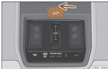
Fig. 36 A la consola del sostre: comandaments per als serveis de veu
