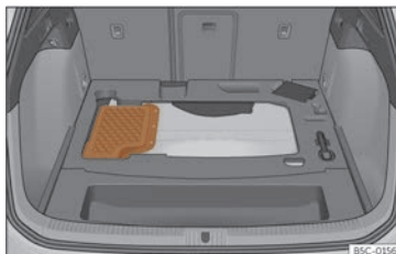
Fig. 227 Vehicles híbrids (PHEV): ubicació de la bateria al maleter
