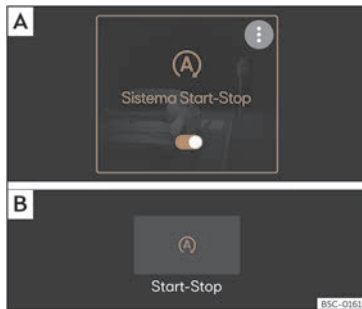
Fig. 156 A la pantalla del sistema d'Infotainment: sistema Start-Stop connectat. [A] Vista al menú principal. [B] Vista amb el sistema d'Infotainment apagat.
