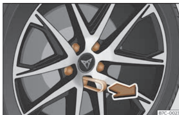
Fig. 39 Roda: caragols de la roda amb caputxons.
