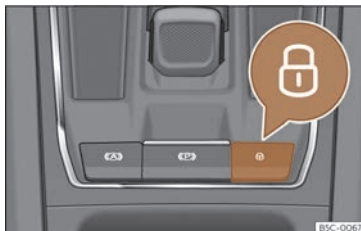
Fig. 80 A la consola central: commutador del tancament centralitzat
