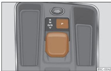
Fig. 157 A la consola central: comandament selector.
