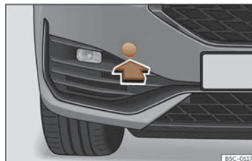
Fig. 48 A la part dreta del para-xocs davanter:retirar la tapa.
