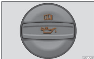
Fig. 223 Tap de la boca d'ompliment d'oli del motor al compartiment del motor.
