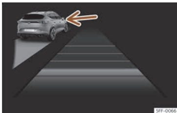
Fig. 175 A la pantalla del quadre d'instruments: ACC actua, vehicle detectat per l'esquerra
