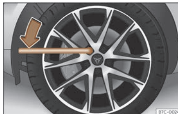
Fig. 42 Canvi de roda: afluixar els caragols de roda.
