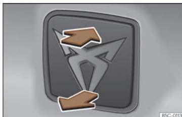
Fig. 87 Porta posterior: obertura des de fora.
