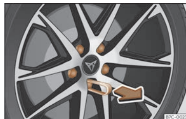
Fig. 40 Roda: caragols de la roda amb caputxons.
