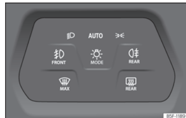
Fig. 96 Tauler d'instruments: comandament dels llums.
