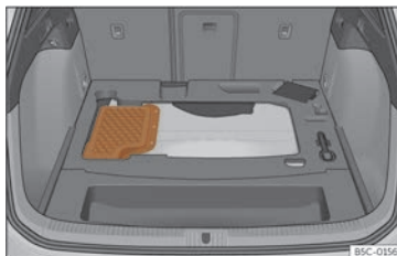
Fig. 229 Vehicles híbrids (PHEV): ubicació de la bateria al maleter
