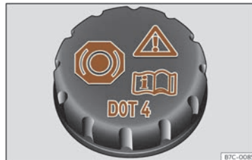
Fig. 227 Compartiment del motor: tap del dipòsit del líquid de frens.
