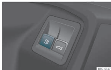
Fig. 209 Porta del conductor: desbloqueig de la tapa del dipòsit.
