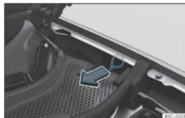
Fig. 205 Entre l'ala esquerra i la frontissa del capó del motor: Tirador per al desbloqueig manual d'emergència del connector de càrrega.
