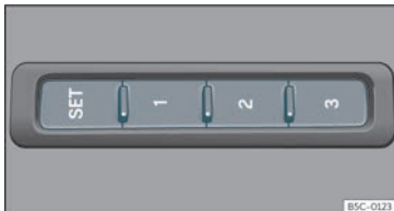
Fig. 109 Al lateral exterior del seient del conductor: tecles de memòria
