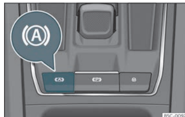
Fig. 187 A la part inferior de la consola central: tecla de la funció Auto Hold.
