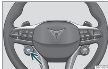
Fig. 158 Volant multifunció*: botó per canviar el perfil de conducció.
