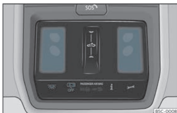
Fig. 97 Detall del revestiment del sostre: il·luminació davantera de l'habitacle.
