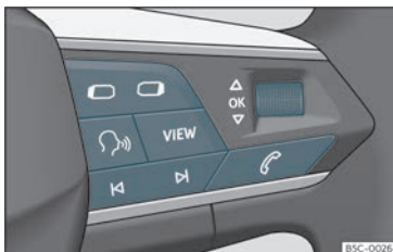
Fig. 64 Costat dret del volant multifunció:teclades per utilitzar els menús i les indicacions informatives del quadre d'instruments (segons les versions).
