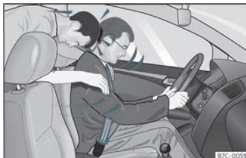
Fig. 12 L'ocupant del seient posterior que no porti el cinturó de seguretat es veurà llançat cap endavant sobre el conductor que sí que porta el cinturó.
