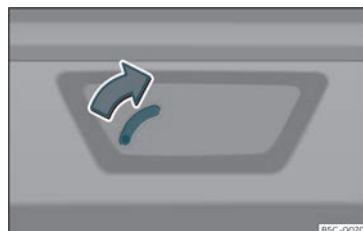
Fig. 90 Detall del maleter: desbloqueig d'emergència (Leon Sportstourer).
