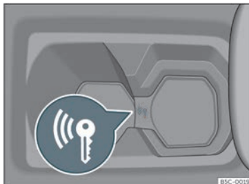
Fig. 154 A la consola central: arrencada d'emergència.
