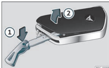
Fig. 76 Clau del vehicle: obrir la tapa del compartiment de la pila.
