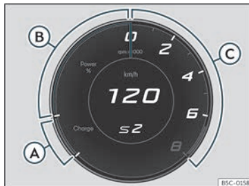
Fig. 61 Quadre d'instruments digital: Powermeter (vista Cupra)
