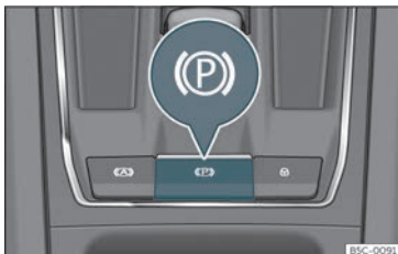
Fig. 186 A la part inferior de la consola central: Commutador del fre d'estacionament electrònic.
