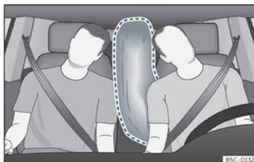
Fig. 24 Coixí de seguretat central completament inflat (zona de desplegament).
