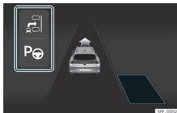
Fig. 189 A la pantalla del quadre d'instruments: visualització del sistema d'aparcament assistit amb visualització reduïda.
