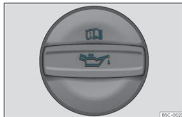
Fig. 216 Tap de la boca d'ompliment d'oli del motor al compartiment del motor.
