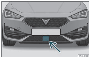
Fig. 159 En el para-xocs davanter: sensor de radar.
