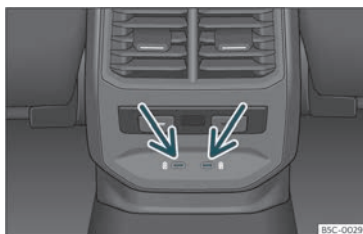
Fig. 152 Part posterior consola central: connectors USB amb funció de presa de corrent.
