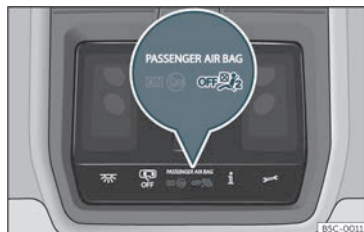
Fig. 20 A la consola del sostre: indicador de control de la desactivació del coixí de seguretat de l'acompanyant.
