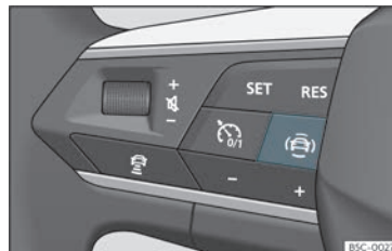
Fig. 66 Costat esquerre del volant multifunció:tecla per als sistemes d'assistència al conductor (segons versions).
