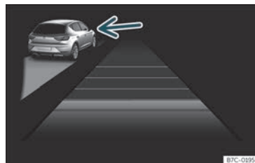
Fig. 172 A la pantalla del quadre d'instruments: ACC actiu, vehicle detectat per l'esquerra
