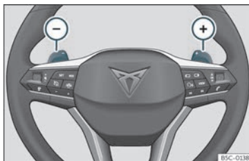
Fig. 157 Volant: palanques per a canvi automàtic.
