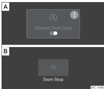
Fig. 155 A la pantalla del sistema d'Infotainment: sistema Start-Stop connectat. [A] Vista al menú principal. [B] Vista amb el sistema d'Infotainment apagat.
