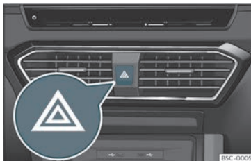
Fig. 96 Tauler d'instruments: commutador dels intermitents d'emergència
