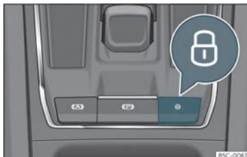
Fig. 79 A la consola central: commutador del tancament centralitzat
