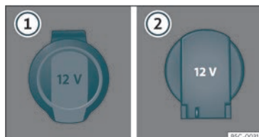
Fig. 140 Presa de corrent de 12 volts: ① a l'interior del reposabraços davanter, ② al maleter.
