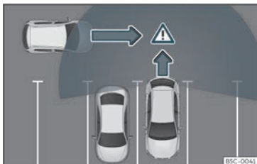
Fig. 183 Representació esquemàtica de l'assistència de sortida de l'aparcament: zona vigilada al voltant del vehicle que està sortint de l'aparcament.
