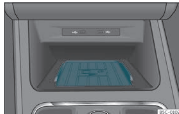
Fig. 150 A la consola central: allotjament per a la connexió del telèfon mòbil.
