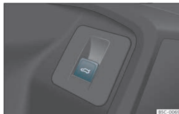
Fig. 87 A la porta del conductor:tecla per obrir i tancar la porta posterior.
