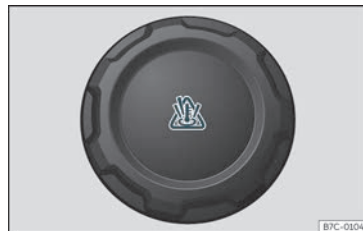
Fig. 218 Compartiment del motor: tap del dipòsit d'expansió del líquid refrigerant.
