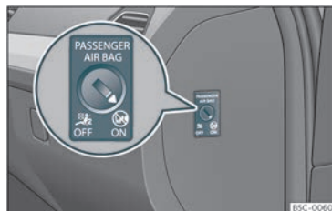
Fig. 19 Commutador amb clau per activar i desactivar el coixí de seguretat de l'acompanyant.
