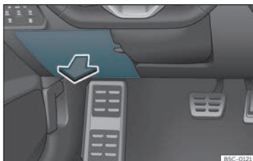
Fig. 51 En el tauler d'instruments del costat del conductor: tapa de la caixa de fusibles.
