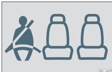
Fig. 9 Quadre d'instruments: indicació de placa posterior esquerra ocupada i cordada el cinturó corresponent.
