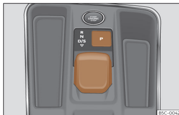
Fig. 115 En la consola central: mando selector.
