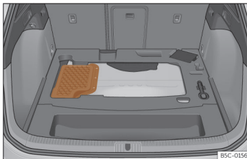
Fig. 224 Vehículos híbridos (PHEV): ubicación de la batería en el maletero
