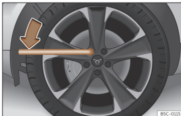
Fig. 233 Cambio de rueda: aflojar los tornillos de rueda.
