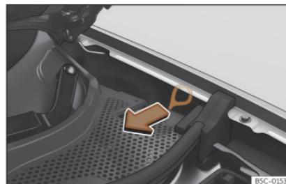
**Fig. 208** Entre la aleta izquierda y la bisagra del capó del motor: Tirador para el desbloqueo manual de emergencia del conector de carga.
