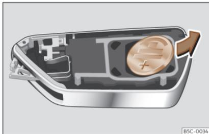
Fig. 78 Llave del vehículo: extracción de la pila.
