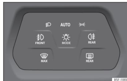
Fig. 95 Tablero de instrumentos: mando de las luces.
