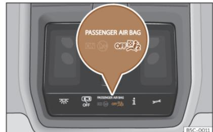
Fig. 20 En la consola del techo: testigo de control de la desactivación del airbag del acompañante. BSC-0011
