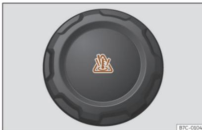
**Fig. 224** Vano motor: tapón del depósito de expansión del líquido refrigerante.
