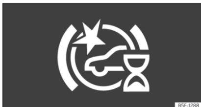
**Fig. 169** En la pantalla del cuadro de instrumentos: indicación de autocalibración inicial del sistema.
