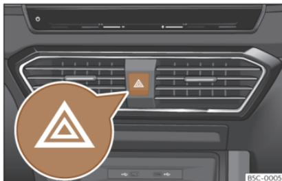
**Fig. 97** Tablero de instrumentos: conmutador de los intermitentes de emergencia.
