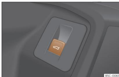
Fig. 88 En la puerta del conductor: tecla para abrir y cerrar el portón trasero.
