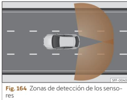
Fig. 164 Zonas de detección de los sensores
