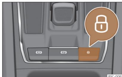
**Fig. 80** En consola central: conmutador del cierre centralizado
