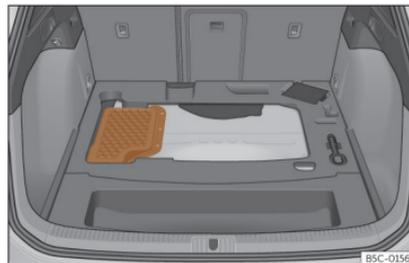
**Fig. 227** Vehículos híbridos (PHEV): ubicación de la batería en el maletero
