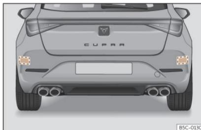
Fig. 163 Vista trasera del vehículo: zonas de los sensores de radar.
