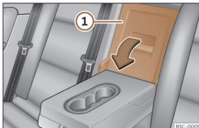
**Fig. 130** En el respaldo del asiento trasero: apertura de la trampilla.
