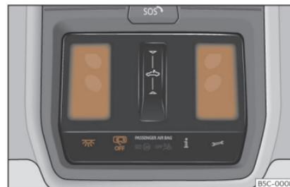
**Fig. 98** Detalle del revestimiento del techo: iluminación delantera del habitáculo.
