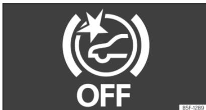
**Fig. 170** En la pantalla del cuadro de instrumentos: indicación de Front Assist desactivado.
