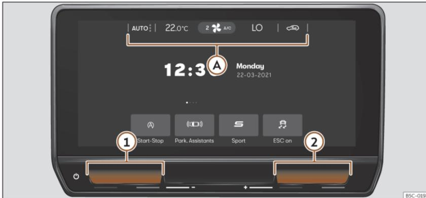
**Fig. 143** Representación esquemática: funciones de climatización
