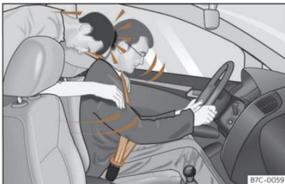
**Fig. 12** El ocupante del asiento trasero que no lleve puesto el cinturón de seguridad se verá lanzado hacia delante sobre el conductor que sí lleva el cinturón.
