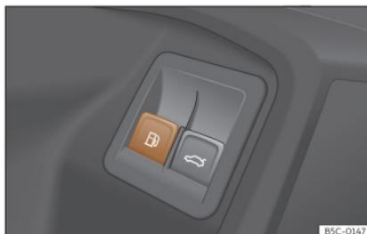
**Fig. 212** Puerta del conductor: desbloqueo de la tapa del depósito.
