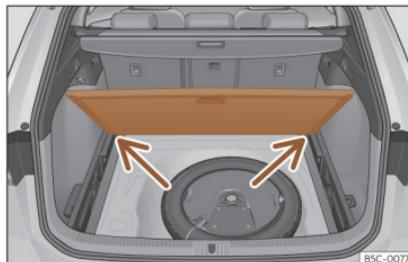
**Fig. 124** Suelo variable del maletero: posición inclinada.
