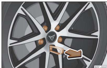
Fig. 39 Rueda: tornillos de la rueda con capuchones.
