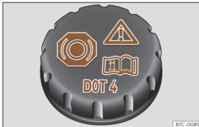
Fig. 225 Vano motor: tapón del depósito del líquido de frenos.
