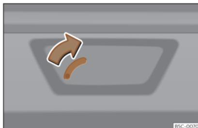
**Fig. 91** Detalle del maletero: desbloqueo de emergencia (Leon Sportstourer).
