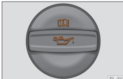
Fig. 221 Tapón de la boca de llenado de aceite del motor en el vano motor.
