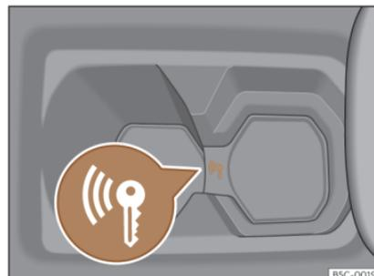
**Fig. 155** En la consola central: arranque de emergencia.
