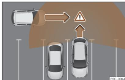
**Fig. 184** Representación esquemática del asistente de desaparcamiento: zona vigilada alrededor del vehículo que está desaparcando.
