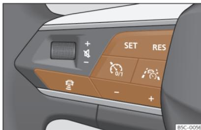
**Fig. 179** Lado izquierdo del volante multifunción: teclas para el manejo del Travel Assist.
