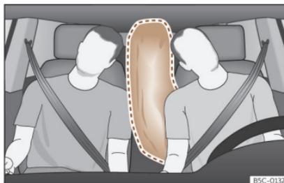
**Fig. 24** Airbag central completamente inflado (zona de despliegue).
