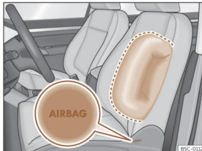
**Fig. 25** Airbag lateral en el asiento del conductor.
