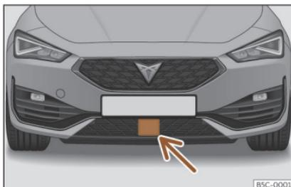
Fig. 160 En el paragolpes delantero: sensor de radar.
