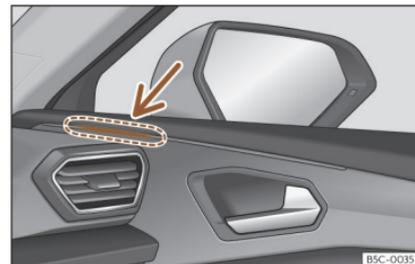
Fig. 181 Testigo de control del asistente de cambio de carril.
