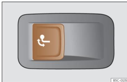
**Fig. 199** En el lado izquierdo del maletero: tecla para desbloquear el gancho de remolque.
