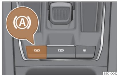
**Fig. 188** En la parte inferior de la consola central: tecla de la función Auto Hold.
