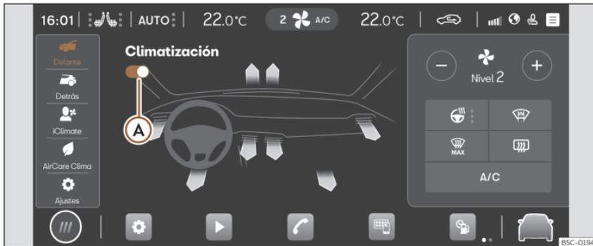
**Fig. 144** Representación esquemática: Menú climatización.
