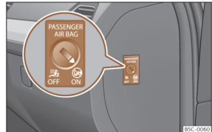
Fig. 19 Conmutador con llave para activar y desactivar el airbag del acompañante. BSC-0060
