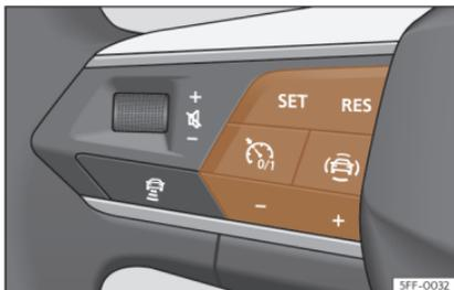
**Fig. 166** En el volante multifunción: botones para manejar el regulador de velocidad
