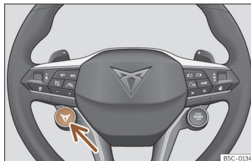
Fig. 161 Volante multifunción: botón para cambiar el perfil de conducción.
