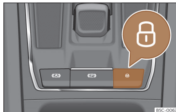
Fig. 81 En consola central: conmutador del cierre centralizado
