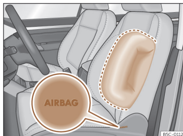
Fig. 25 Airbag lateral en el asiento del conductor.
