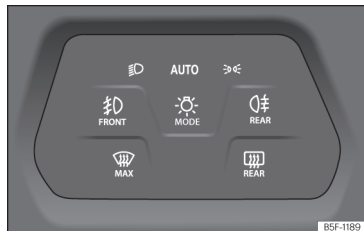
Fig. 96 Tablero de instrumentos: mando de las luces.
