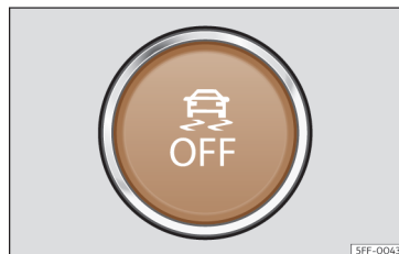
Fig. 191 En la parte inferior de la consola central: botón para conectar/desconectar el ESC
