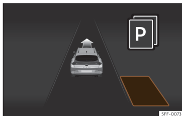
Fig. 192 En la pantalla del cuadro de instrumentos: visualización del sistema de aparcamiento asistido con visualización reducida.
