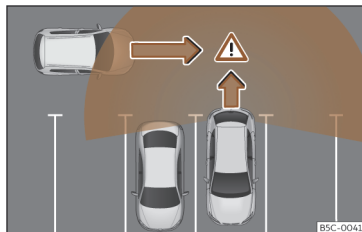
Fig. 186 Representación esquemática del asistente de desaparcamiento: zona vigilada alrededor del vehículo que está desaparcando.
