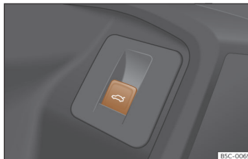
Fig. 89 En la puerta del conductor: tecla para abrir y cerrar el portón trasero.
