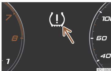
Fig. 234 Cuadro de instrumentos: aviso de pérdida de presión de los neumáticos.
