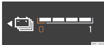
Fig. 63 Cuadro de instrumentos digital: indicador del nivel de batería.
