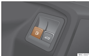
Fig. 214 Puerta del conductor: desbloqueo de la tapa del depósito.
