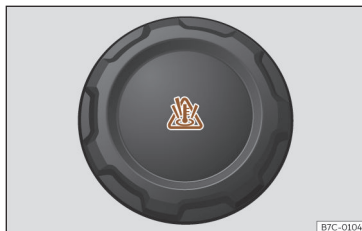
Fig. 226 Vano motor: tapón del depósito de expansión del líquido refrigerante.
