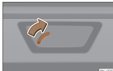
Fig. 92 Detalle del maletero: desbloqueo de emergencia (Leon Sportstourer).
