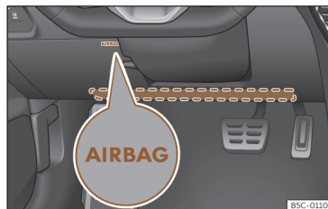
Fig. 21 En el lado del conductor: ubicación del airbag para las rodillas.
