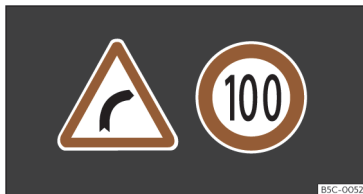
Fig. 59 En la pantalla del cuadro de instrumentos: ejemplos de señales reconocidas.
