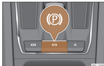
Fig. 189 En la parte inferior de la consola central: tecla del freno de estacionamiento electrónico.
