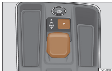
Fig. 159 En la consola central: mando selector.
