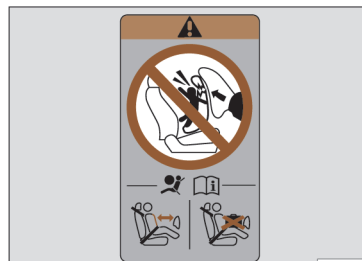
Fig. 30 Adhesivo del airbag: en el marco posterior de la puerta del acompañante
