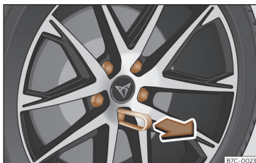
Fig. 40 Rueda: tornillos de la rueda con capuchones.
