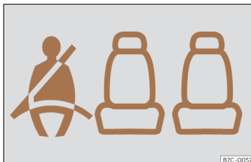
Fig. 9 Cuadro de instrumentos: indicación de plaza posterior izquierda ocupada y abrochado el cinturón correspondiente.
