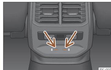
Fig. 155 Parte posterior consola central: conectores USB con función de toma de corriente.
