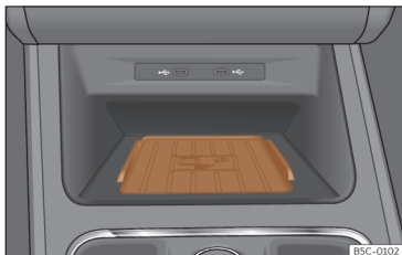
Fig. 153 En la consola central: alojamiento para la conexión del teléfono móvil.
