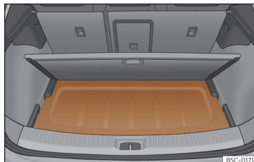
Fig. 120 En el maletero: colocación de la bandeja.
