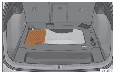
Fig. 229 Vehículos híbridos (PHEV): ubicación de la batería en el maletero
