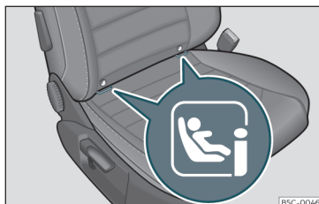
Fig. 32 Asiento pasajero delantero: anillas de sujeción ISOFIX/i-Size.
