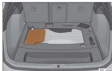
Fig. 217 Vehículos híbridos (PHEV): localización da batería no maleteiro
