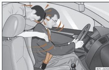
Fig. 22 O ocupante do asento traseiro que non leva posto o cinto de seguridade verase proxectado cara adiante sobre o condutor que si leva o cinto.
