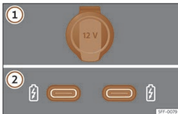
Fig. 163 Tomas de corrente de 12 voltios do vehículo.
