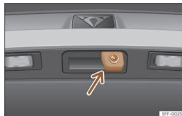
Fig. 127 Na asa do portón traseiro: localización da cámara do asistente para marcha atrás.
