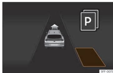
Fig. 150 Na pantalla do cadro de instrumentos: visualización do sistema de aparcamento asistido con visualización reducida.
