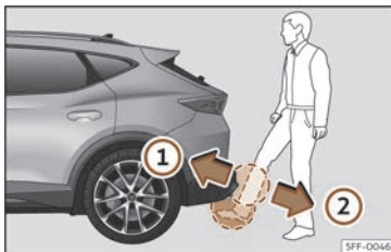
Fig. 78 Portón do maleteiro con apertura controlada por sensor (Easy Open).
