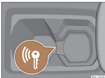
Fig. 113 Na consola central: arranque de emerxencia.
