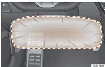
Fig. 37 No lado do condutor: radio de acción do airbag para os xeonllos.
