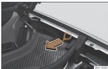
Fig. 59 Entre a á esquerda e a bisagra do capó do motor: Empuñadura para o desbloqueo manual de emerxencia do conector de carga.
