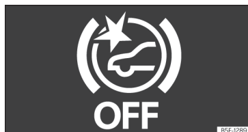
Fig. 137 Na pantalla do cadro de instrumentos: indicación de Front Assist desactivado.
