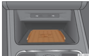
Fig. 174 Na consola central: aloxamento para a conexión do teléfono móbil.
