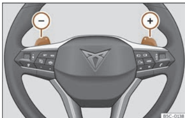
Fig. 117 Volante: pancas para cambio automático.
