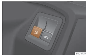
Fig. 194 Porta do condutor: desbloqueo da tapa do depósito.
