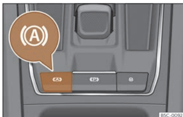
Fig. 147 Na parte inferior da consola central: tecla da función Auto Hold.
