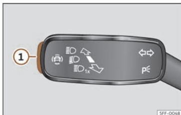
Fig. 120 Na panca de intermitentes e de luz de estrada: tecla para os sistemas de asistencia ao condutor (segundo versións).
