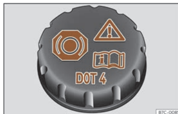
Fig. 213 Van do motor: tapa do depósito do líquido de freos.
