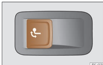
Fig. 189 No lado esquerdo do maleteiro: tecla para desbloquear o gancho de remolque.
