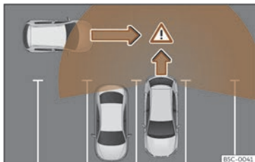
Fig. 159 Representación esquemática do asistente de desaparcamento: área vixiada en torno ao vehículo que está a desaparcar.
