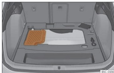
Fig. 219 Vehículos híbridos (PHEV): localización da batería no maleteiro
