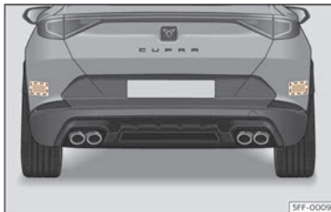
Fig. 125 Vista traseira do vehículo: áreas dos sensores de radar.
