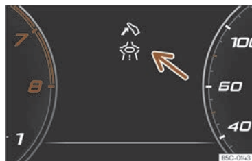
Fig. 10 Indicación da asistencia para unha condución ecoeficiente (representación esquemática).
