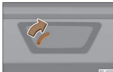
Fig. 80 Detalle do maleteiro: desbloqueo de emerxencia.
