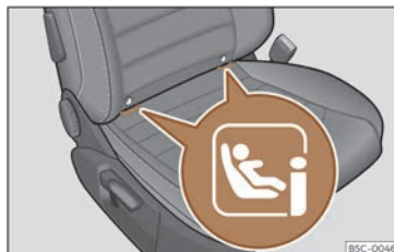
Fig. 42 Asento pasaxeiro dianteiro: localización dos aneis de fixación i-Size.
