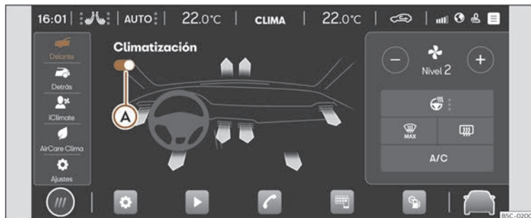
Fig. 109 Representación esquemática: Menú climatización.
