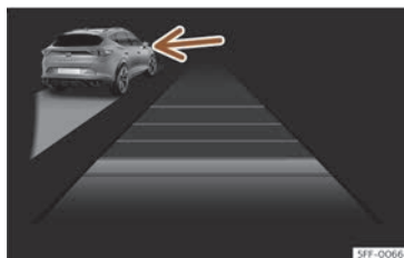
Fig. 132 Na pantalla do quadro de instrumentos: ACC activo, vehículo detectado pola esquerda.
