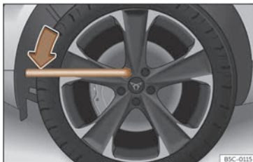
Fig. 228 Cambio de roda: afrouxar os parafusos de roda.
