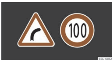
Fig. 9 Na pantalla do cadro de instrumentos: exemplos de sinais recoñecidos.
