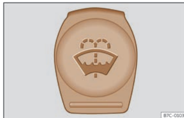
Fig. 214 No van motor: tapón de cor azul do depósito do limpacrstais.
