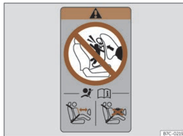
Fig. 40 Adhesivo do airbag: no marco posterior da porta do acompañante.
