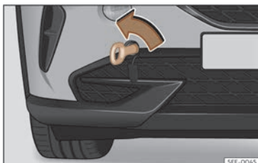
Fig. 202 Parte direita do parachoques dianteiro: argola de remolque enroscada.
