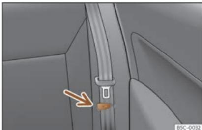
**Fig. 109** Asento traseiro: pinza para suxeitar o cinto de seguridade.
