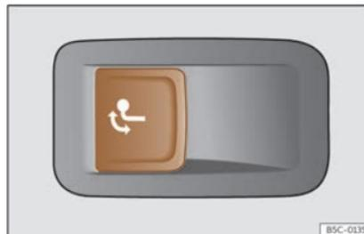
**Fig. 192** No lado esquerdo do maletreiro: tecla para desbloquear o gancho de remolque.
