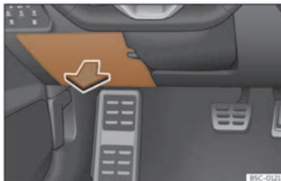
Fig. 48 No taboleiro de instrumentos do lado do condutor: tapa da caixa de fusibles.
