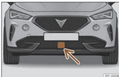
**Fig. 150** No parachoques dianteiro: sensor de radar.
