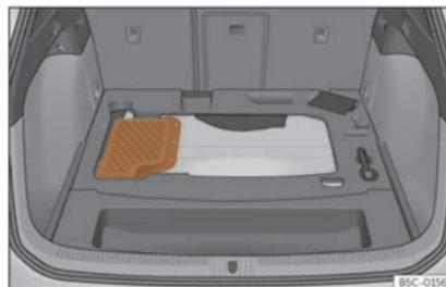
**Fig. 221** Vehículos híbridos (PHEV): localización da batería no maleteiro
