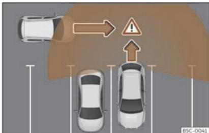
**Fig. 174** Representación esquemática do asistente de desaparcamento: zona vixiada ao redor do vehículo que está a desaparcarse.
