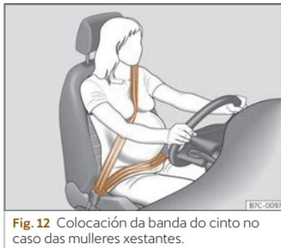
**Fig. 12** Colocación da banda do cinto no caso das mulleres xestantes.
