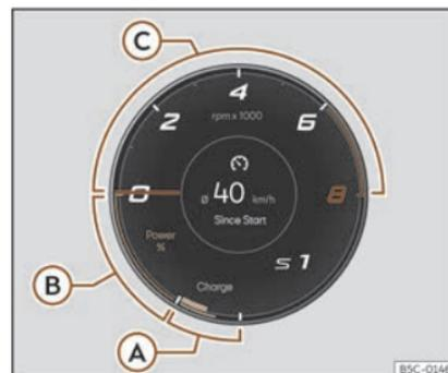
**Fig. 57** Cadro de instrumentos dixital: Powermeter (vista clásica)
