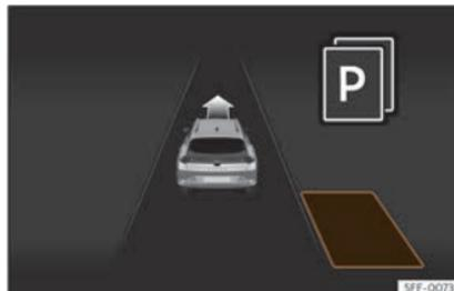
**Fig. 180** Na pantalla do cadro de instrumentos: visualización do sistema de aparcamento asistido con visualización reducida.
