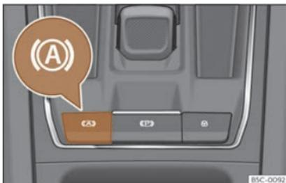
**Fig. 178** Na parte inferior da consola central: tecla da función Auto Hold.
