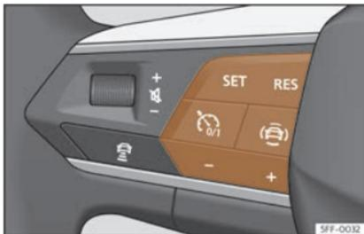
**Fig. 156** No volante multifunción: botóns para manexar o regulador de velocidade
