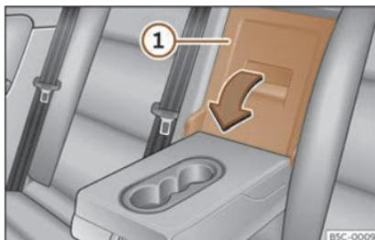
**Fig. 123** No respaldo do asento traseiro: apertura da trapela.
