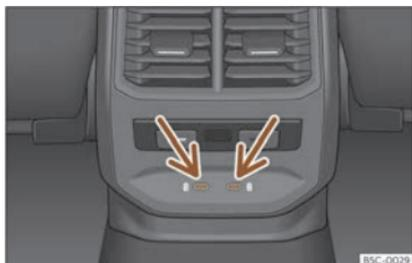
**Fig. 142** Parte posterior consola central: conectores USB con función de toma de corriente.
