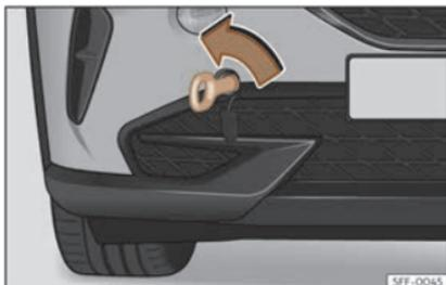
**Fig. 45** Parte dereita do parachoques dianteiro:argola de remolque roscada.
