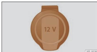
Fig. 129 Toma de corrente de 12 voltios: 1 No interior do reposabrazos dianteiro.
