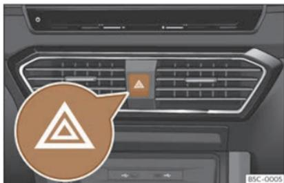
Fig. 94 Taboleiro de instrumentos: conmutador dos intermitentes de emerxencia.
