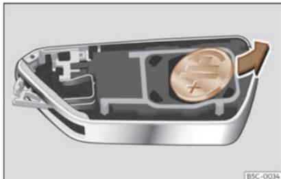
**Fig. 75** Chave do vehículo: extracción da pila.
