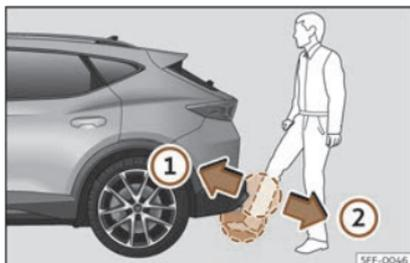
Fig. 86 Portón do maleteiro con apertura controlada por sensor (Easy Open).
