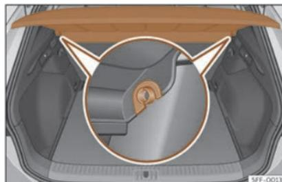
**Fig. 114** No maleteiro: desmontar e montar a bandexa.
