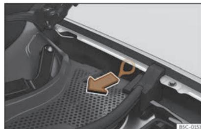
**Fig. 201** Entre a á esquerda e a bisagra do capó do motor: Empuñadura para o desbloqueo manual de emerxencia do conector de carga.
