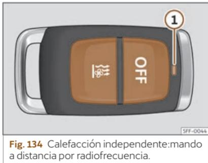
Fig. 134 Calefacción independente: mando a distancia por radiofrecuencia.
