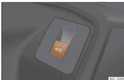
**Fig. 85** Na porta do condutor: tecla para abrir e pechar o portón traseiro.
