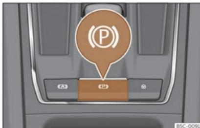
**Fig. 177** Na parte inferior da consola central: tecla do freo de estacionamento electrónico.
