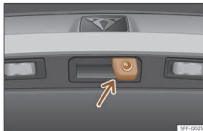
**Fig. 155** Na asa do portón traseiro:localización da cámara do asistente para marcha atrás.
