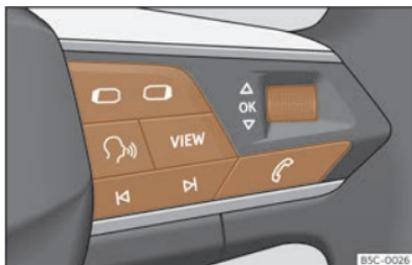
**Fig. 61** Lado derecho do volante multifunción:teclas para usar os menús e as indicacións informativas do cadro de instrumentos (segundo versións).
