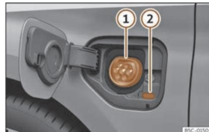
**Fig. 198** Detrás da tapa de carga da batería na parte dianteira esquerda: Toma de carga
