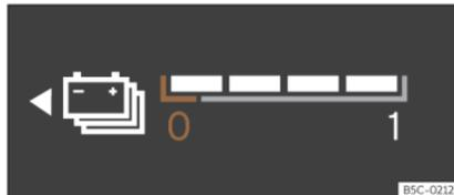
**Fig. 59** Cadro de instrumentos dixital: indicador do nivel de batería.
