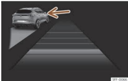
**Fig. 163** Na pantalla do cadro de instrumentos:ACC activo, vehículo detectado pola esquerda
