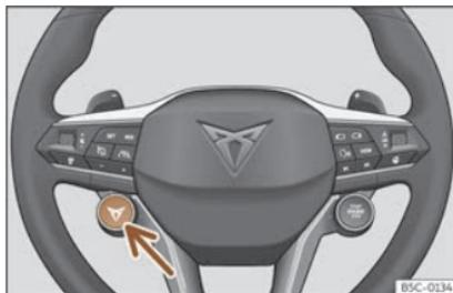
**Fig. 149** Volante multifunción: botón para cambiar o perfil de condución.
