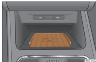
**Fig. 140** Na consola central: aloxamento para a conexión do teléfono móbil.
