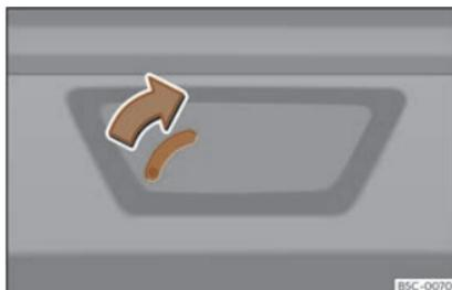
Fig. 88 Detalle do maletreiro: desbloqueo de emerxencia.
