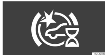
**Fig. 159** Na pantalla do cadro de instrumentos: indicación da auto-calibración inicial do sistema.
