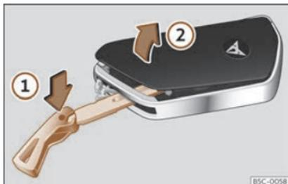
**Fig. 74** Chave do vehículo: abrir a tapa do compartimento da pila.
