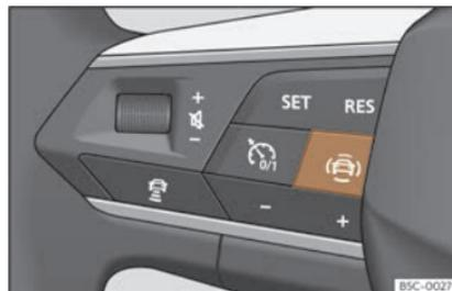
**Fig. 63** Lado esquerdo do volante multifunción:tecla para os sistemas de asistencia ao condutor (dependendo das versións).
