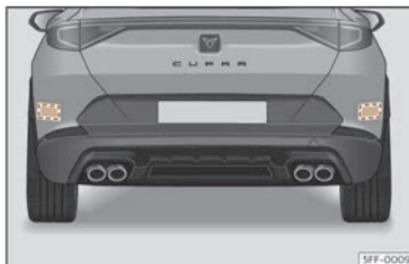
**Fig. 153** Vista traseira do vehículo: zonas dos sensores de radar.
