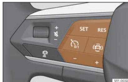
Fig. 157 No volante multifunción: Botóns para manexar o limitador de velocidade.
