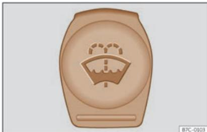
Fig. 220 No van motor: tapón de cor azul do depósito do limpacristais.
