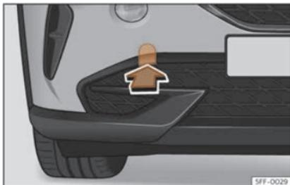
**Fig. 44** No lado dereito do parachoques dianteiro:retirar a tapa.
