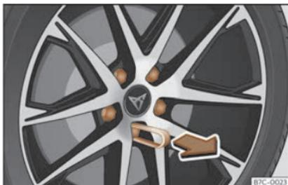
**Fig. 36** Roda:parafusos da roda con capuchóns.
