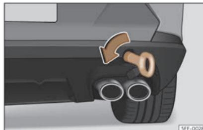
**Fig. 47** No lado dereito do parachoques traseiro:argola de remolque roscada.
