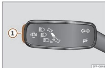
**Fig. 62** Na panca de intermitentes e de luz de estrada:tecla para os sistemas de asistencia ao condutor (dependendo das versións).
