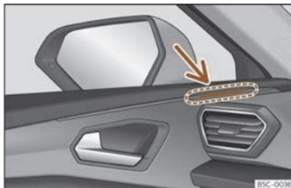
**Fig. 170** Indicador de control do asistente de cambio de carril.
