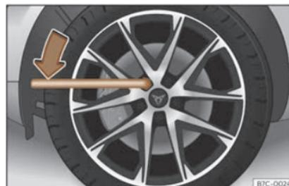
**Fig. 38** Cambio de roda:afrouxar os parafusos de roda.
