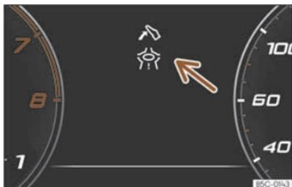
**Fig. 56** Indicación de asistencia para unha condución ecoeficiente (representación esquemática).
