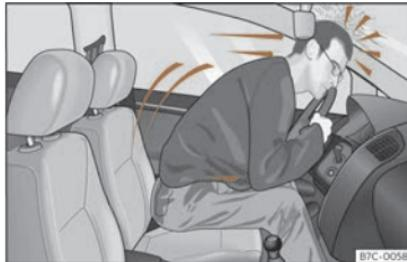
**Fig. 7** O conductor que non leve posto o cinto de seguridade será lanzado cara adiante.
