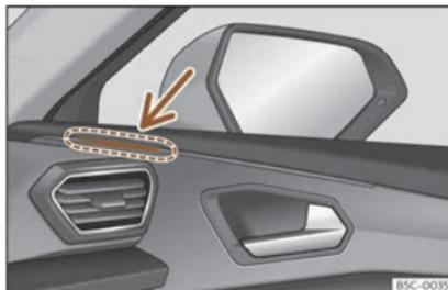
**Fig. 171** Indicador de control do asistente de cambio de carril.
