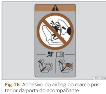
**Fig. 26** Adhesivo do airbag: no marco posterior da porta do acompañante
