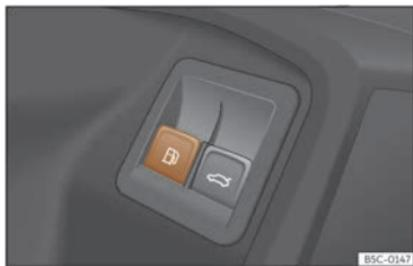
**Fig. 205** Porta do condutor:desbloqueo da tapa do depósito.
