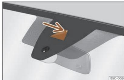
**Fig. 152** No parabrisas: área de campo visual do sistema de aviso de saída do carril. »
