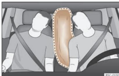
**Fig. 20** Airbag central completamente inflado (zona de despregamento).
