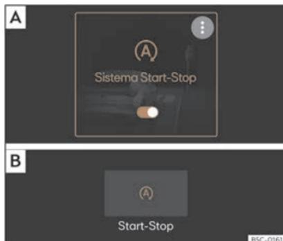
**Fig. 145** Na pantalla do sistema de Infotainment: Sistema Start-Stop conectado. **[A]** Vista no menú principal. **[B]** Vista co sistema de Infotainment apagado.
