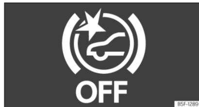
**Fig. 160** Na pantalla do cadro de instrumentos: indicación de Front Assist desactivado.
