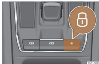
**Fig. 77** En consola central: conmutador do peche centralizado
