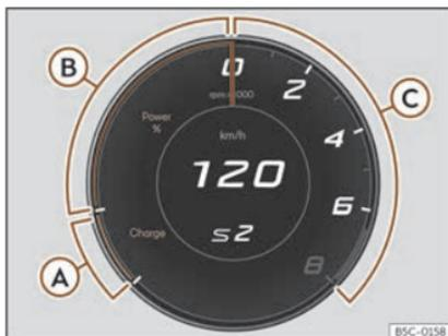
**Fig. 58** Cadro de instrumentos dixital: Powermeter (vista Cupra)
