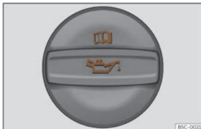
Fig. 215 Tapón da boca de carga de aceite do motor no van motor.
