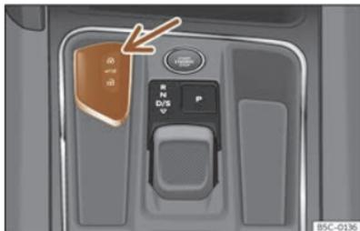
Fig. 72 Consola central: Aloxamento para a chave do vehículo.
