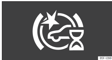
Fig. 149 Na pantalla do quadro de instrumentos: indicación da auto-calibración inicial do sistema.
