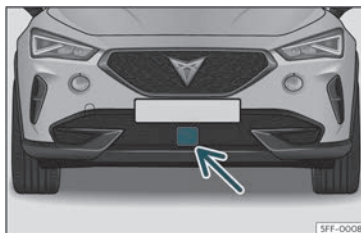
Fig. 140 No parachoques dianteiro: sensor de radar.
