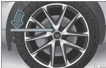
Fig. 37 Cambio de roda:afrouxar os parafusos de roda.
