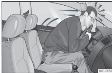
Fig. 7 O condutor que non leve posto o cinto de seguridade será lanzado cara adiante.
