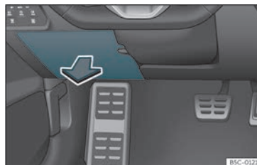
Fig. 47 No taboleiro de instrumentos do lado do condutor: tapa da caixa de fusibles.
