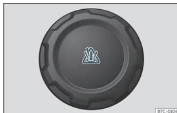
Fig. 189 Van motor: tapón do depósito de expansión do líquido refrigerante.
