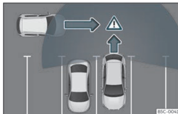
Fig. 164 Representación esquemática do asistente de desaparcamento: zona vixiada ao redor do vehículo que está a desaparcarse.
