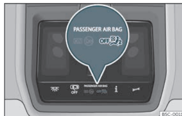
Fig. 16 Na consola do teito: indicador de control da desactivación do airbag do acompañante.
