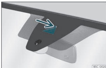
Fig. 142 No parabrisas: área de campo visual do sistema de aviso de saída do carril.
