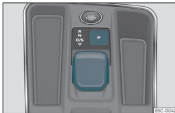
Fig. 137 Na consola central:mando selector.
