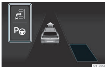
Fig. 170 Na pantalla do cadro de instrumentos: visualización do sistema de aparcamento asistido con visualización reducida.
