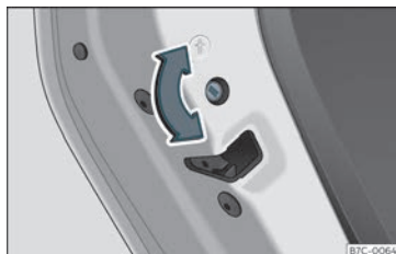
Fig. 76 Seguro para nenos da porta da esquerda.
