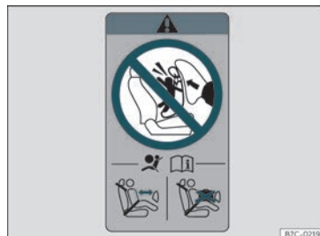
Fig. 26 Adhesivo do airbag: no marco posterior da porta do acompañante
