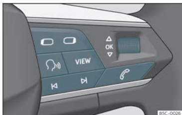
Fig. 56 Lado dereito do volante multifunción: teclas para usar os menús e as indicacións informativas do cadro de instrumentos.
