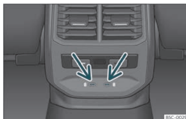
Fig. 133 Parte posterior consola central: conectores USB con función de toma de corrente.
