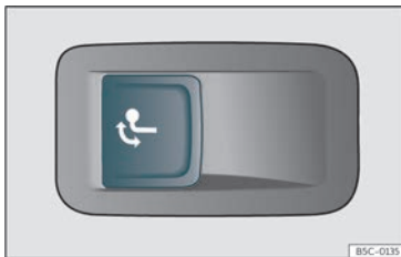
Fig. 179 No lado esquerdo do maleteiro: tecla para desbloquear o gancho de remolque.
