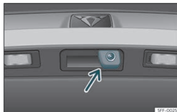
Fig. 145 Na asa do portón traseiro:localización da cámara do asistente para marcha atrás.
