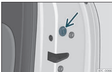
Fig. 75 Bloqueo de emerxencia da porta.
