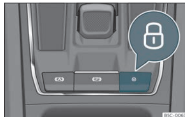
Fig. 71 En consola central:conmutador do peche centralizado
