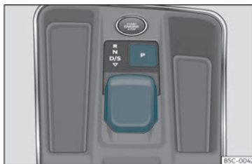
Fig. 137 Na consola central:mando selector.
