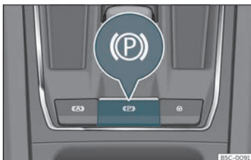
Fig. 167 Na parte inferior da consola central: tecla do freo de estacionamento electrónico.
