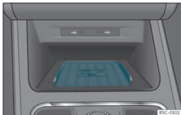
Fig. 131 Na consola central: aloxamento para a conexión do teléfono móbil.
