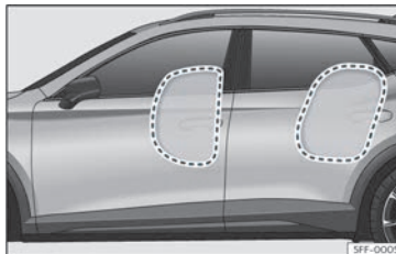
Fig. 22 Airbags laterais totalmente inflados no lado esquerdo do vehículo.
