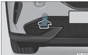
Fig. 43 No lado dereito do parachoques dianteiro: retirar a tapa.
