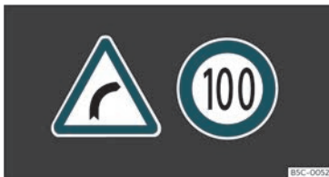
Fig. 53 Na pantalla do cadro de instrumentos: exemplos de sinais recoñecidos.
