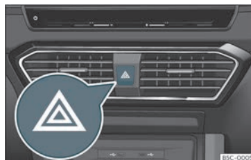
Fig. 87 Taboleiro de instrumentos: conmutador dos intermitentes de emerxencia.
