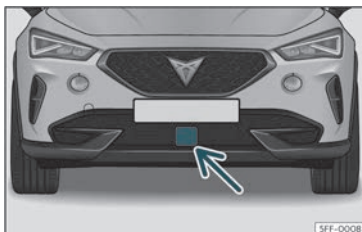
Fig. 140 No parachoques dianteiro: sensor de radar.
