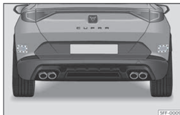
Fig. 143 Vista traseira do vehículo: zonas dos sensores de radar.
