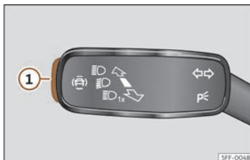
61 ir. Keinukarien eta argi luzeen palankan:gidariarentzako laguntza-sistemen tekla (bertsioen arabera).
