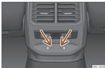
140 ir. Kotsola zentralaren atzeko atala:korrante-harguneko funtzioa duten USB konektoreak.
