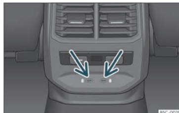
133 ir. Kontsola zentralaren atzeko atala:korronte-harguneko funtzioa duten USB konektoreak.
