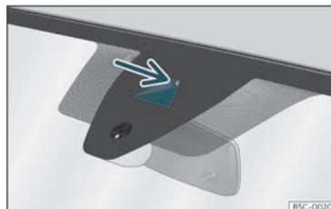
142 ir. Haizetakoa:erre-irteeraren abisu-sistemaren ikus-eremua.
