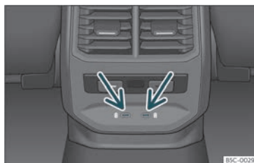
133 ir. Konsola zentralaren atzeko atala:korronte-harguneko funtzioa duten USB konektoreak.
