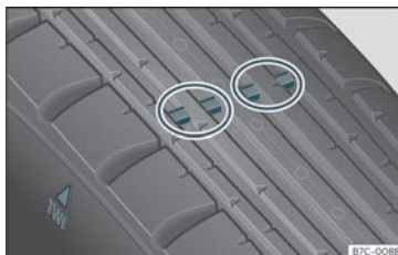
194 ir. Pneumatikoaren profila:higadura-seinaleak.
