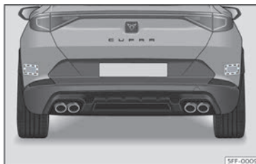
143 ir. Ibilgailuaren atzeko ikuspegia: radar-sentsoreen zona.
