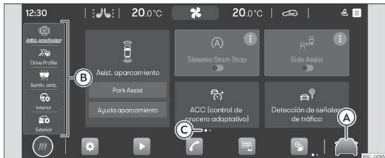
62 ir. Irudikapen eskematikoa: Ibilgailuaren laguntzaileak eta doikuntzak
