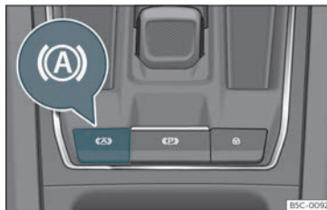
168 ir. Kontsola zentralaren beheko atalean: Auto Hold funtzioaren tekla.
