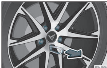
35 ir. Gurpila:gurpilaren torlojuak txanoekin.
