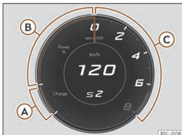
Fig. 7 Quadre d'instruments digital: Powermeter (vista Cupra)
