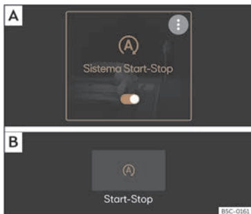
Fig. 114 A la pantalla del sistema d'Infotainment: sistema Start-Stop connectat. A) Vista al menú principal. B) Vista amb el sistema d'Infotainment apagat.
