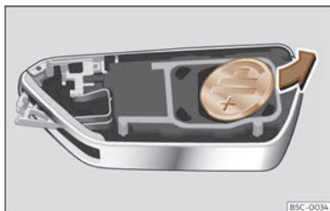
Fig. 67 Clau del vehicle: extracció de la pila.
