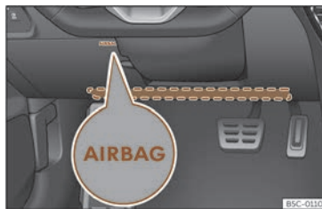
Fig. 36 Al costat del conductor: ubicació del coixí de seguretat per als genolls.
