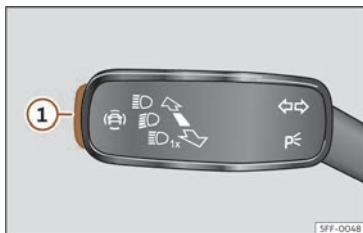
Fig. 120 A la palanca d'intermitents i de llum de carretera: tecla per als sistemes d'assistència al conductor (segons versions).
