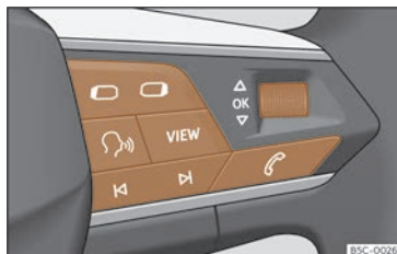
Fig. 11 Costat dret del volant multifunció: tecles per utilitzar els menús i les indicacions informatives del quadre d'instruments (segons versions).
