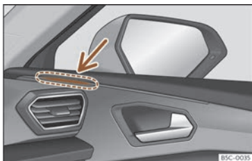
Fig. 143 Indicador de control de l'assistent de canvi de carril.
