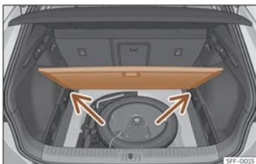
Fig. 180 Terra variable del maleter: posició inclinada.
