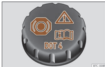
Fig. 213 Compartiment del motor: tap del dipòsit del líquid de frens.
