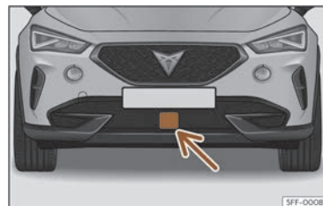
Fig. 122 Al para-xocs davant: sensor de radar.
