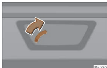
Fig. 80 Detall del maleter: desbloqueig d'emergència.
