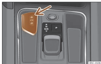
Fig. 64 Consola central: allotjament per a la clau del vehicle.
