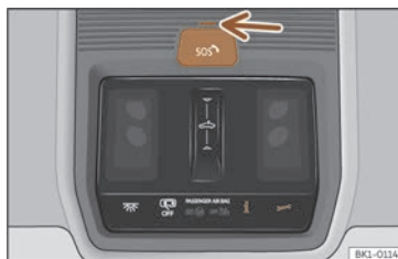
Fig. 50 A la consola del sostre: comandaments per als serveis de veu.
