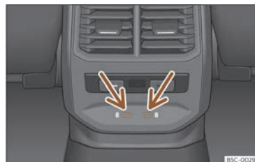
Fig. 168 Part posterior consola central: connectors USB amb funció de presa de corrent.
