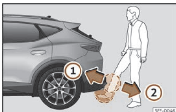
Fig. 78 Porta del maleter amb obertura controlada per sensor (Easy Open).
