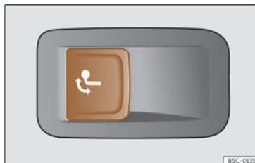
Fig. 189 Al costat esquerre del maleter: tecla per desbloquejar el ganxo de remolc.
