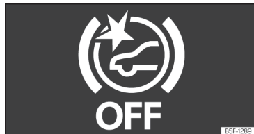
Fig. 137 A la pantalla del quadre d'instruments: indicació de Front Assist desactivat.
