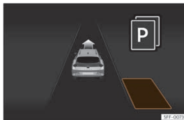
Fig. 150 A la pantalla del quadre d'instruments: visualització del sistema d'aparcament assistit amb visualització reduïda.
