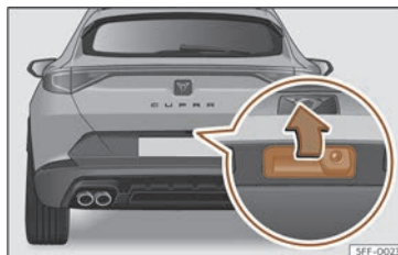
Fig. 75 Porta posterior: obertura des de fora.
