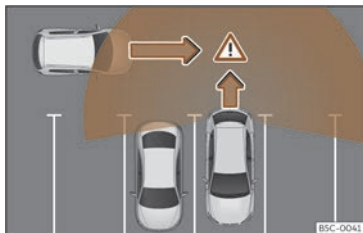
Fig. 159 Representació esquemàtica de l'assistent de sortida de l'aparcament: zona vigilada al voltant del vehicle que està sortint de l'aparcament.
