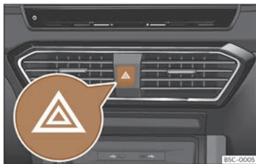
Fig. 49 Tauler d'instruments: commutador dels intermitents d'emergència.
