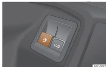
Fig. 194 Porta del conductor: desbloqueig de la tapa del dipòsit.
