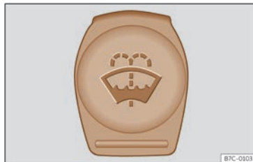
Fig. 214 Al compartiment del motor: tap de color blau del dipòsit de l'eixugavidres.
