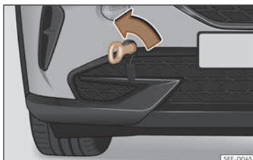
Fig. 202 Part dreta del para-xocs davanter: argolla de remolc enroscada.
