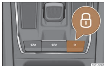
Fig. 71 A la consola central: commutador del tancament centralitzat
