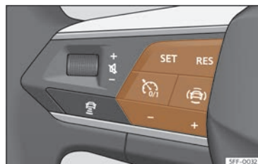
Fig. 128 Al volant multifunció: botons per controlar el regulador de velocitat.
