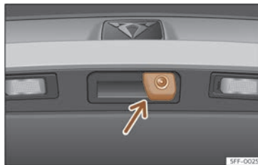
Fig. 127 A la maneta de la porta del darrere: ubicació de la càmera de l'assistent per a marxa enrere.
