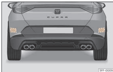
Fig. 125 Vista posterior del vehicle: zones dels sensors de radar.
