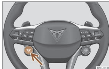
Fig. 118 Volant multifunció: botó per canviar el perfil de conducció.
