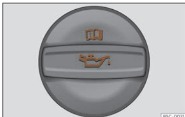
Fig. 218 Tapa de la boca d'ompliment d'oli del motor al compartiment del motor.
