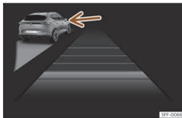
Fig. 132 A la pantalla del quadre d'instruments: ACC actiu, vehicle detectat per l'esquerra.
