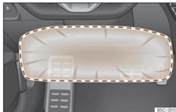
Fig. 37 Al costat del conductor: radi d'acció del coixí de seguretat per als genolls.
