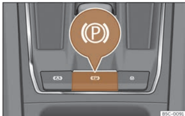
Fig. 146 A la part inferior de la consola central: tecla del fre d'estacionament electrònic.
