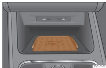
Fig. 174 A la consola central: allotjament per a la connexió del telèfon mòbil.
