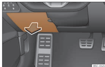
Fig. 47 En el tauler d'instruments del costat del conductor: tapa de la caixa de fusibles.
