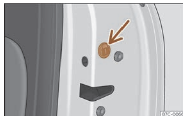
Fig. 80 Bloqueig d'emergència de la porta.
