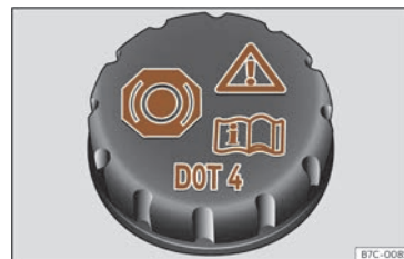
Fig. 215 Compartiment del motor: tap del dipòsit del líquid de frens.
