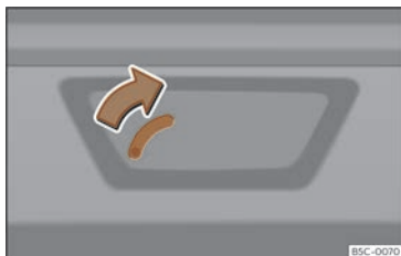
Fig. 87 Detall del maleter: desbloqueig d'emergència.
