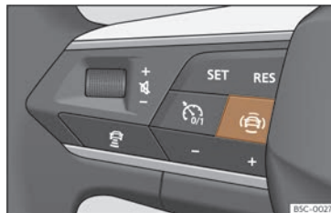
Fig. 62 Costat esquerre del volant multifunció: tecla per als sistemes d'assistència al conductor (segons versions).
