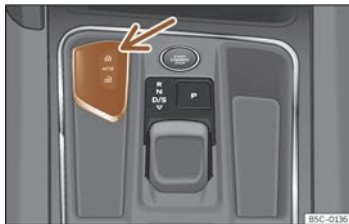
Fig. 71 Consola central: allotjament per a la clau del vehicle.
