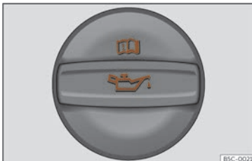
Fig. 211 Tap de la boca d'ompliment d'oli del motor al compartiment del motor.
