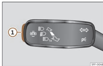
Fig. 61 A la palanca d'intermitents i de llum de carretera: tecla per als sistemes d'assistència al conductor (segons versions).
