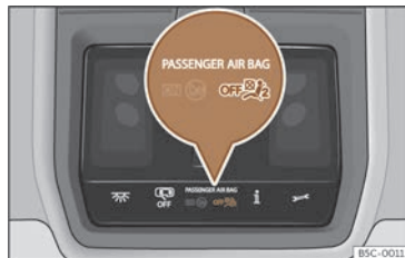
Fig. 16 A la consola del sostre: indicador de control de la desactivació del coixí de seguretat de l'acompanyant.
