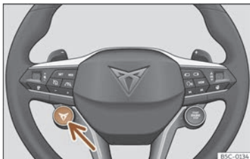
Fig. 147 Volant multifunció: botó per canviar el perfil de conducció.
