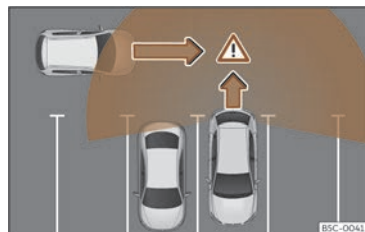
Fig. 172 Representació esquemàtica de l'assistent de sortida de l'aparcament: zona vigilada al voltant del vehicle que està sortint de l'aparcament.
