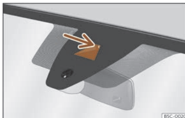
Fig. 150 Al parabrisa: àrea de camp visual del sistema d'avís de sortida del carril.
