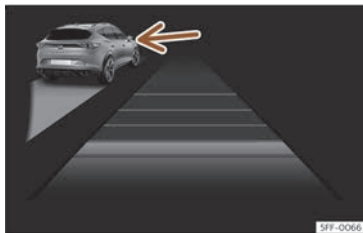
Fig. 161 A la pantalla del quadre d'instruments: ACC actiu, vehicle detectat per l'esquerra
