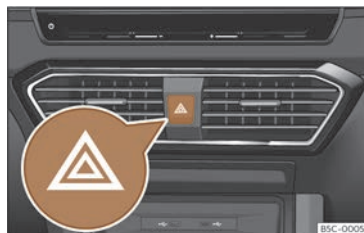
Fig. 93 Tauler d'instruments: commutador dels intermitents d'emergència
