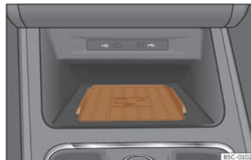
Fig. 138 A la consola central: allotjament per a la connexió del telèfon mòbil.
