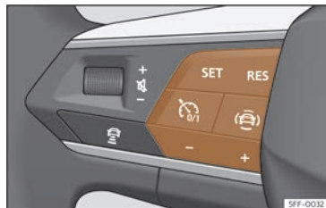
Fig. 154 Al volant multifunció: botons per controlar el regulador de velocitat
