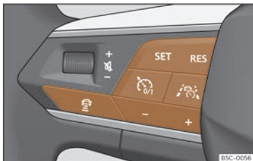
Fig. 167 Costat esquerre del volant multifunció: tecles per fer servir el Travel Assist.
