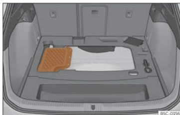
Fig. 217 Vehicles híbrids (PHEV): ubicació de la bateria al maleter
