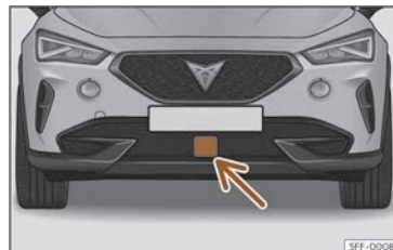
Fig. 148 En el para-xocs davant: sensor de radar.
