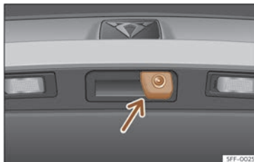
Fig. 153 A la maneta de la porta posterior: ubicació de la càmera de l'assistent per a marxa enrere.
