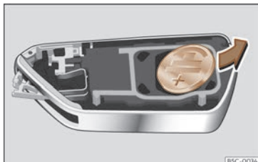
Fig. 74 Clau del vehicle: extracció de la pila.
