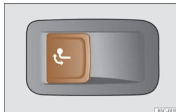
Fig. 188 Al costat esquerre del maleter: tecla per desbloquejar el ganxo de remolc.
