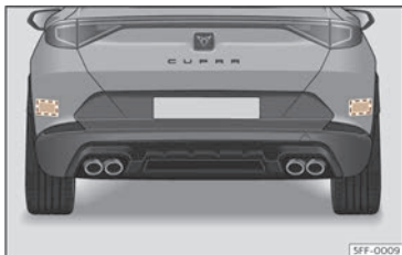
Fig. 151 Vista posterior del vehicle: zones dels sensors de radar.
