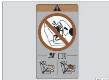
Fig. 26 Adhesiu del coixí de seguretat: en el marc posterior de la porta de l'acompanyant
