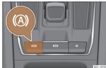
Fig. 176 A la part inferior de la consola central: tecla de la funció Auto Hold.
