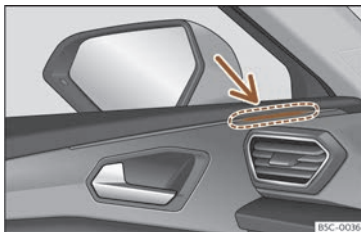
Fig. 168 Indicador de control de l'assistent de canvi de carril.
