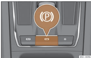
Fig. 175 A la part inferior de la consola central: Commutador del fre d'estacionament electrònic.
