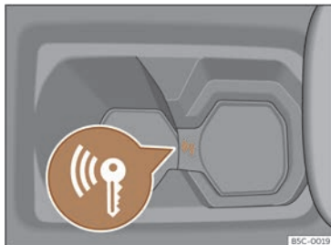
Fig. 142 A la consola central: arrencada d'emergència.
