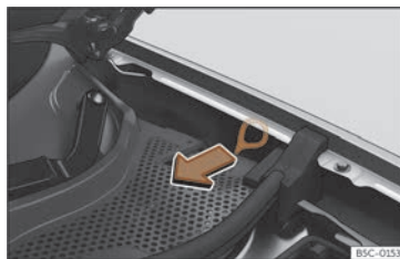
Fig. 197 Entre l'aleta esquerra i la frontissa del capó del motor: Tirador per al desbloqueig manual d'emergència del connector de càrrega.
