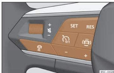
Fig. 159 Al volant multifunció: botons per fer servir l'ACC
