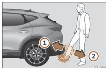
Fig. 85 Porta del maleter amb obertura controlada per sensor (Easy Open).
