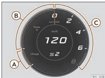
Fig. 57 Quadre d'instruments digital: Powermeter (vista Cupra)
