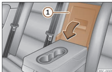
Fig. 121 Al respall del seient posterior: obertura de la trapa.
