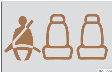
Fig. 5 Quadre d'instruments: indicació de placa posterior esquerra ocupada i cordat el cinturó corresponent.
