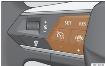
Fig. 155 Al volant multifunció: botons per controlar el limitador de velocitat
