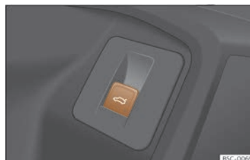
Fig. 84 A la porta del conductor: tecla per obrir i tancar la porta posterior.
