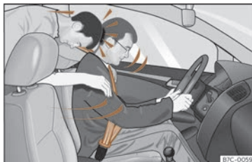
Fig. 8 L'ocupant del seient posterior que no porti el cinturó de seguretat es veurà llançat cap endavant sobre el conductor que sí que porta el cinturó.
