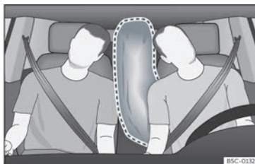
Fig. 20 Coixí de seguretat central completament inflat (zona de desplegament).
