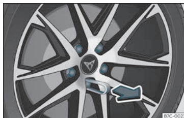
Fig. 35 Roda amb caragols de la roda amb caputxons.
