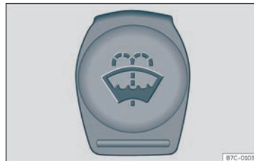
Fig. 191 Al compartiment del motor: tap del dipòsit de l'eixugavidres.
