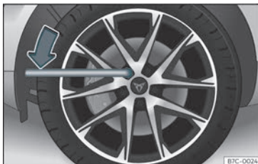
Fig. 37 Canvi de roda: afluixar els caragols de roda.
