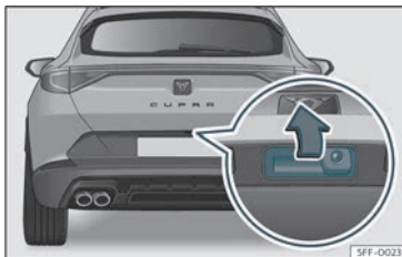
Fig. 77 Porta posterior:obertura des de fora.
