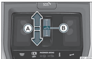
Fig. 83 En el revestiment interior del sostre:tecla del sostre de vidre.
