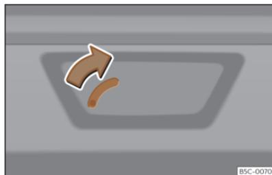
**Fig. 80** Detalle del maletero: desbloqueo de emergencia.
