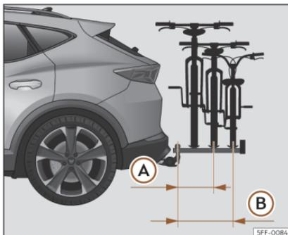
**Fig. 189** Representación esquemática del voladizo máximo de la carga en un portabicicletas para dos o tres bicicletas.
