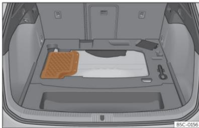
**Fig. 217** Vehículos híbridos (PHEV): ubicación de la batería en el maletero
