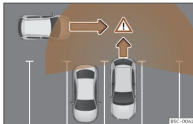
**Fig. 157** Representación esquemática del asistente de desahparcamiento: zona vigilada alrededor del vehículo que está desahparcando.
