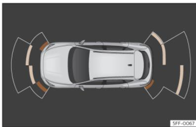
**Fig. 149** Visualización de ayuda al aparcamiento en la pantalla del sistema de infotainment.
