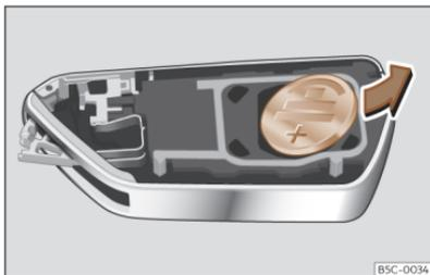
**Fig. 67** Llave del vehículo: extracción de la pila.
