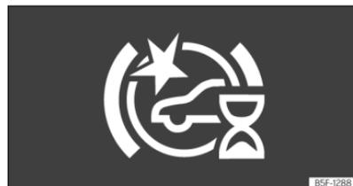
**Fig. 136** En la pantalla del cuadro de instrumentos: indicación de autocalibración inicial del sistema.
