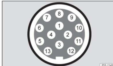
**Fig. 186** Representación esquemática: asignación de los pines de la toma de corriente para remolque.
