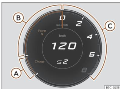
**Fig. 7** Cuadro de instrumentos digital: Powermeter (vista Cupra)
