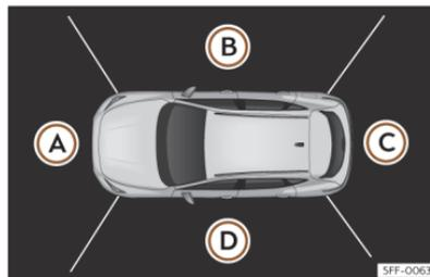
**Fig. 156** Visualización del sistema de visión periférica: perspectiva aérea.
