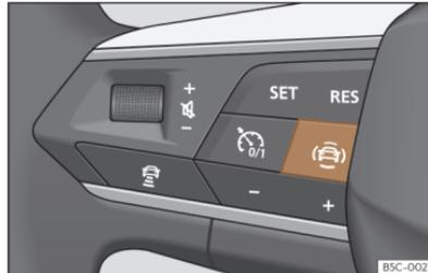
**Fig. 121** Lado izquierdo del volante multifunción: tecla para los sistemas de asistencia al conductor (según versiones).
