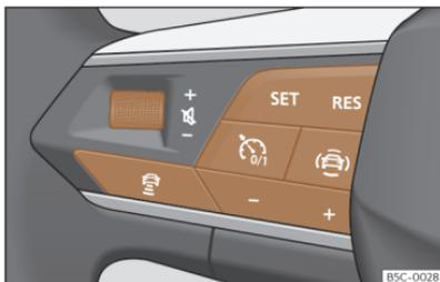
**Fig. 131** En el volante multifunción: botones para manejar el ACC.
