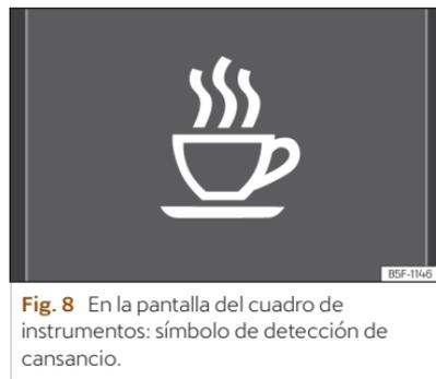
**Fig. 8** En la pantalla del cuadro de instrumentos: símbolo de detección de cansancio.
