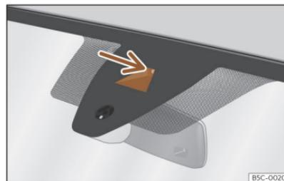
Fig. 124 En el parabrisas: área de campo visual del sistema de aviso de salida del carril.
