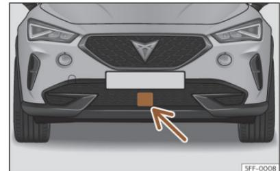
**Fig. 122** En el paragolpes delantero: sensor de radar.
