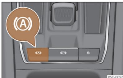
**Fig. 147** En la parte inferior de la consola central: tecla de la función Auto Hold.
