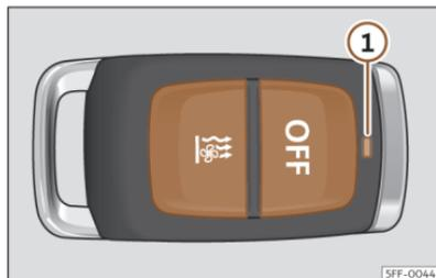
Fig. 111 Calefacción independiente: mando a distancia por radiofrecuencia.
