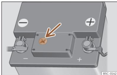
**Fig. 218** Mirilla en la parte superior de la batería de 12 voltios (representación esquemática).
