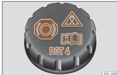
**Fig. 211** Vano motor: tapón del depósito del líquido de frenos.
