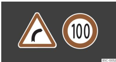
**Fig. 9** En la pantalla del cuadro de instrumentos: ejemplos de señales reconocidas.
