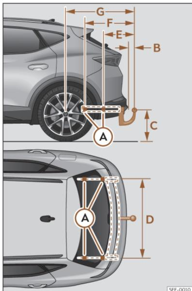
**Fig. 190** Cotas y puntos de fijación para el montaje posterior de un dispositivo de remolque.
