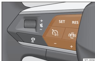
**Fig. 129** En el volante multifunción: botones para manejar el limitador de velocidad.
