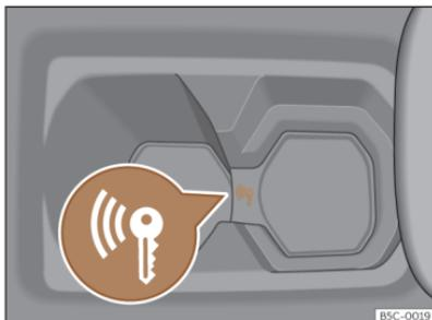
**Fig. 113** En la consola central: arranque de emergencia.
