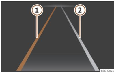
**Fig. 138** En la pantalla del cuadro de instrumentos: indicaciones del sistema de aviso de salida del carril.
