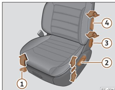
**Fig. 87** Asientos delanteros: ajuste manual del asiento.
