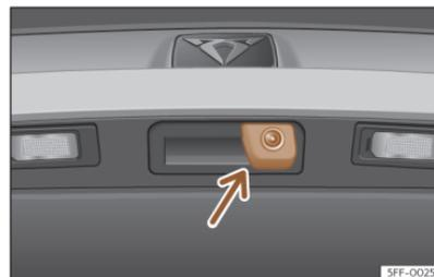
**Fig. 127** En la manecilla del portón trasero: ubicación de la cámara del asistente para marcha atrás.
