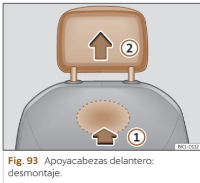
Fig. 93 Apoyacabezas delantero: desmontaje.
