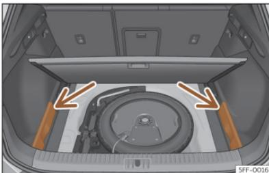
**Fig. 175** En el maletero: tapas para guardar la bandeja.
