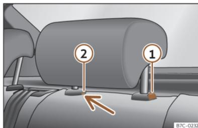
Fig. 94 Apoyacabezas trasero: desmontaje.
