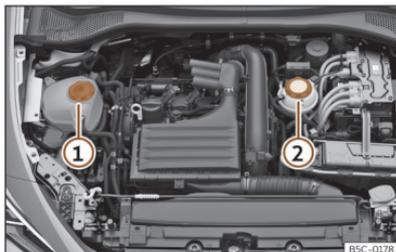
**Fig. 208** Vano motor: Depósitos de líquido refrigerante
