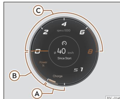
Fig. 6 Cuadro de instrumentos digital: Powermeter (vista clásica)
