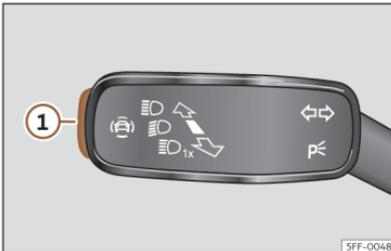
**Fig. 120** En la palanca de intermitentes y de luz de carretera: tecla para los sistemas de asistencia al conductor (según versiones).
