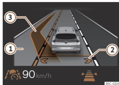
**Fig. 141** En la pantalla del cuadro de instrumentos: visualización del cambio de carril asistido (representación esquemática).
