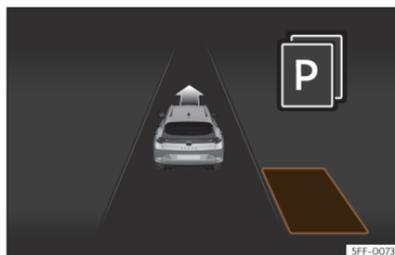
**Fig. 150** En la pantalla del cuadro de instrumentos: visualización del sistema de aparcamiento asistido con visualización reducida.
