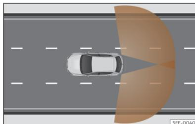
**Fig. 126** Zonas de detección de los sensores.
