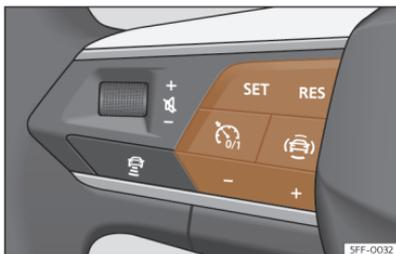
**Fig. 128** En el volante multifunción: botones para manejar el regulador de velocidad.
