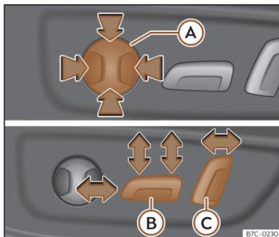
**Fig. 88** Asiento del conductor: ajuste eléctrico del asiento.
