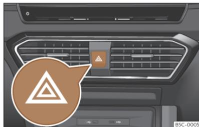
**Fig. 49** Tablero de instrumentos: conmutador de los intermitentes de emergencia.
