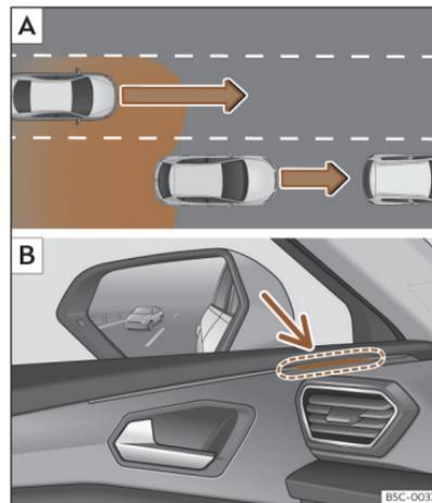
**Fig. 144** Representación esquemática: **A**) Adelantamiento con tráfico en la parte trasera. **B**) Indicación del asistente de cambio de carril en el lado izquierdo.
