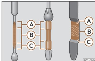
**Fig. 215** Varilla de medición del nivel de aceite.
