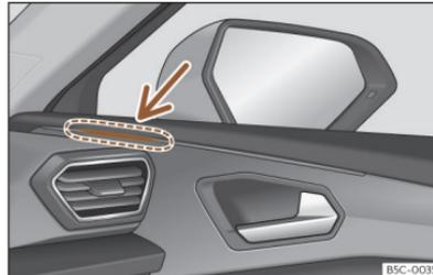
**Fig. 143** Testigo de control del asistente de cambio de carril.
