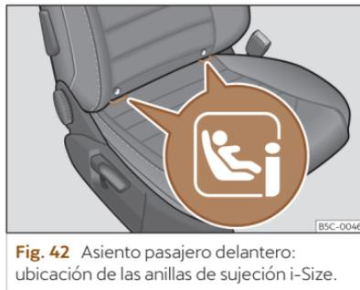
**Fig. 42** Asiento pasajero delantero: ubicación de las anillas de sujeción i-Size.
