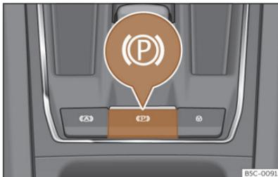
**Fig. 146** En la parte inferior de la consola central: tecla del freno de estacionamiento electrónico.
