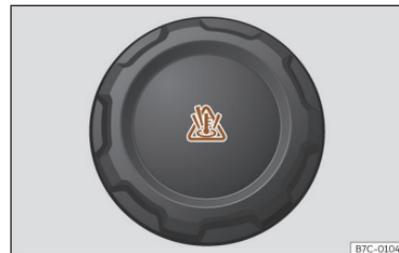
**Fig. 210** Vano delantero: tapón del depósito de expansión del líquido refrigerante.
