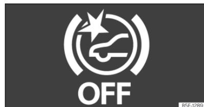
**Fig. 137** En la pantalla del cuadro de instrumentos: indicación de Front Assist desactivado.
