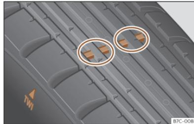
Fig. 220 Perfil del neumático: indicadores de desgaste.
