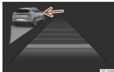
**Fig. 132** En la pantalla del cuadro de instrumentos: ACC activo, vehículo detectado por la izquierda.
