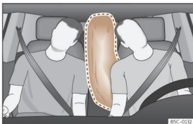
**Fig. 32** Airbag central completamente inflado (zona de despliegue).
