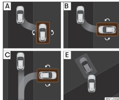
**Fig. 151** En la pantalla del sistema de infotainment: indicación de los modos de aparcamiento.
