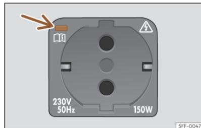
**Fig. 164** En el maletero: toma de corriente de 230 voltios.
