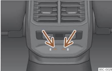
**Fig. 166** Parte posterior consola central: conectores USB con función de toma de corriente.
