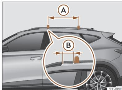
**Fig. 185** Puntos de fijación de las barras longitudinales para el portaequipajes del techo.
