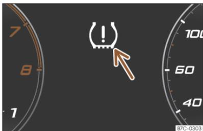
**Fig. 229** Cuadro de instrumentos: aviso de pérdida de presión de los neumáticos.
