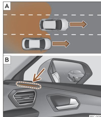
**Fig. 145** Representación esquemática: **A**) Adelantamiento en el carril central e incorporación posterior al carril derecho. **B**) Indicación del asistente de cambio de carril en el lado derecho.
