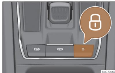
Fig. 71 En consola central: conmutador del cierre centralizado
