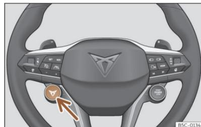
**Fig. 118** Volante multifunción: botón para cambiar el perfil de conducción.
