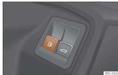
**Fig. 192** Puerta del conductor: desbloqueo de la tapa del depósito.
