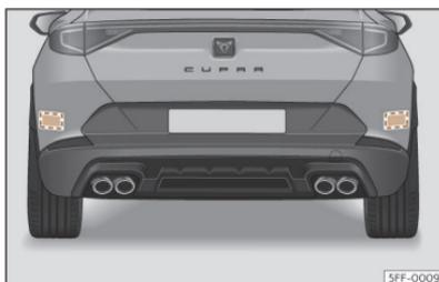
**Fig. 125** Vista trasera del vehículo: zonas de los sensores de radar.
