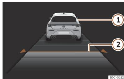
**Fig. 130** En la pantalla del cuadro de instrumentos: ACC activo.
