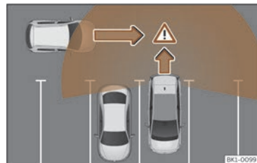
Fig. 154 Representación esquemática do asistente de desaparcamento: área vixiada en torno ao vehículo que está a desaparcar.
