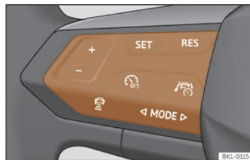
Fig. 124 No volante multifunción: botóns para manexar o limitador de velocidade.
