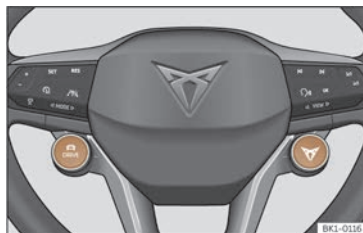
Fig. 117 Volante multifunción: Botóns DRIVE e CUPRA para seleccionar e cambiar o perfil de condución.
