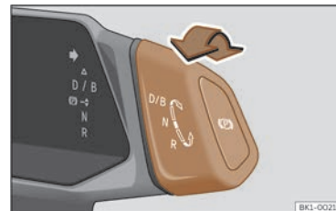
Fig. 116 Selector de marchas coa tecla do freo de estacionamento electrónico.
