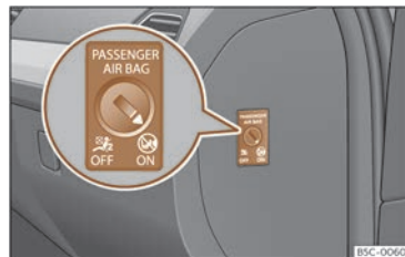
Fig. 43 Conmutador con chave para activar e desactivar o airbag do acompañante.
