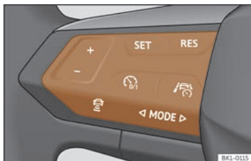
Fig. 135 Lado esquerdo do volante multifunción.
