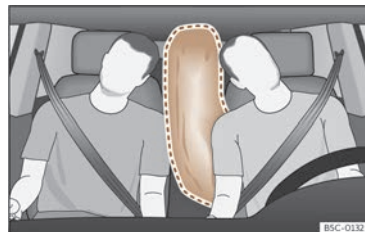
Fig. 46 Airbag central totalmente inflado (zona de despregue).
