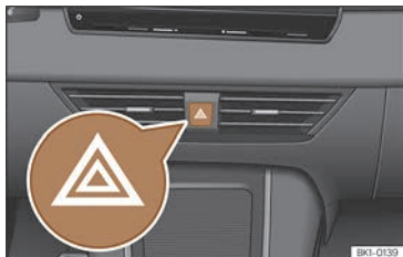
Fig. 60 Taboleiro de instrumentos: conmutador dos intermitentes de emerxencia.
