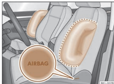
Fig. 47 Airbag lateral no asento do condutor e do acompañante.
