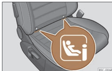
Fig. 53 Asento pasaxeiro dianteiro: localización dos aneis de fixación i-Size.
