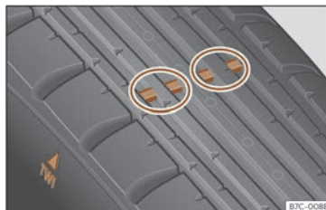
Fig. 196 Perfil do pneumático: indicadores de desgaste.
