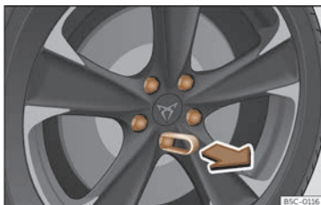
Fig. 198 Roda: parafusos da roda con capuchóns.
