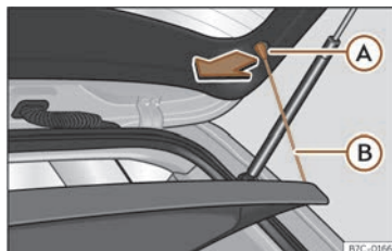
Fig. 168 No maletreiro: desmontar e montar a bandexa.
