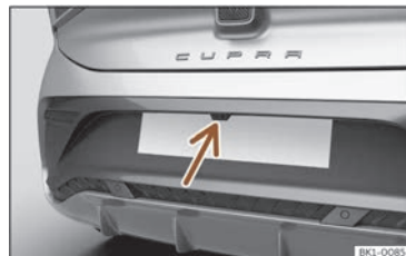
Fig. 123 No parachoques traseiro: localización da cámara do asistente para marcha atrás.
