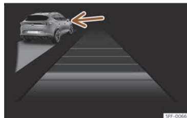
Fig. 127 Na pantalla do cadro de instrumentos: ACC activo, vehículo detectado pola esquerda.
