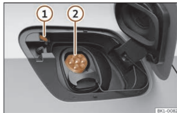
Fig. 68 Detrás da tapa de carga da batería na parte traseira dereita: Toma de carga.
