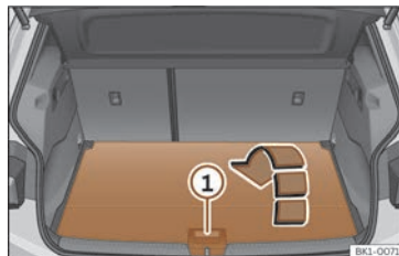
Fig. 171 No maleteiro: abrir o segundo piso do maleteiro.
