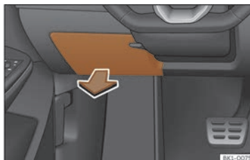
Fig. 185 No taboleiro de instrumentos do lado do condutor: tapa da caixa de fusibles.
