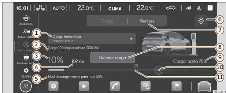
Fig. 74 No sistema de infotainment: menú Xestor enerxía nos axustes do vehículo.
