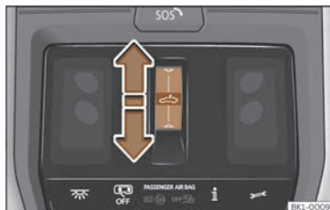
Fig. 112 No revestimento interior do teito: botón de función para manexar a cortina parasol.
