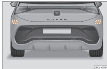
Fig. 121 Vista traseira do vehículo: áreas dos sensores de radar.
