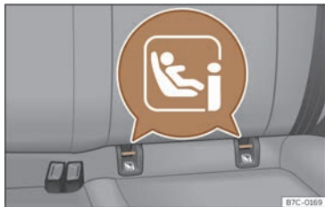
Fig. 52 Asento traseiro: localización dos aneis de fixación ISOFIX ou i-Size.
