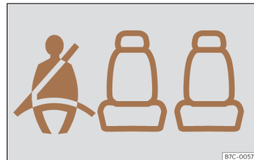
Fig. 34 Cadro de instrumentos: indicación do estado dos cintos de seguridade das prazas traseiras.
