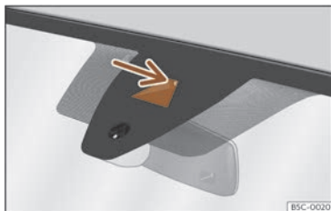
Fig. 120 No parabrisas: área de campo visual do sistema de aviso de saída de carril.
