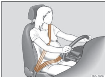
Fig. 40 Colocación da banda do cinto no caso das mulleres xestantes.
