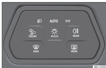
Fig. 103 Taboleiro de instrumentos: mando das luces.
