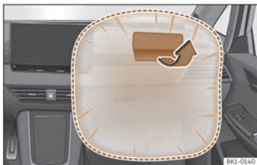
Fig. 42 Airbag do acompañante no taboleiro de instrumentos.
