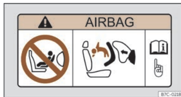
Fig. 51 Adhesivo do airbag: no parasol do lado do acompañante.
