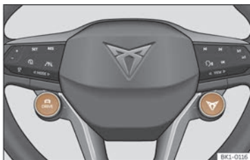
Fig. 117 Volante multifunción: Botóns DRIVE e CUPRA para seleccionar e cambiar o perfil de conducción.
