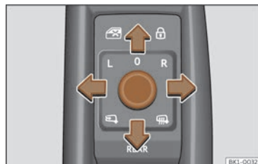
Fig. 110 Detalle da porta do condutor: mando para o retrovisor exterior.
