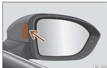
Fig. 138 Indicador de control do asistente de cambio de carril.
