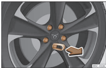
Fig. 198 Roda: parafusos da roda con capuchóns.
