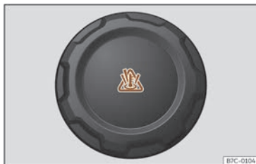
Fig. 192 Van dianteiro: tapón do depósito de expansión do líquido refrixerante.
