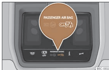
44. irudia Sabaiko kontsolan: gidarikidearen airbaga desaktibatzea izana adierazten duen kontrol-argia.
