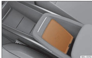
167. irudia Kontsola zentrolean: telefono mugikorraren konexiorako tokia.
