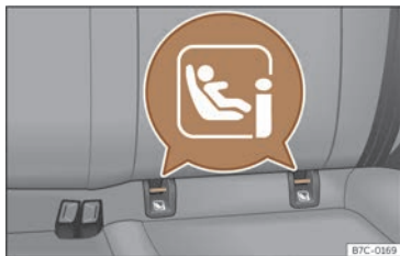
52. irudia Atzealdeko eserlekua: ISOFIX edo i-Size sistemaren finkatze-uztaien kokapena.
