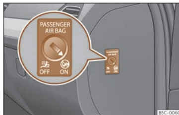
43. irudia Giltza duen komutadorearen gidarikidearen airbaga aktibatzea eta desaktibatzea.
