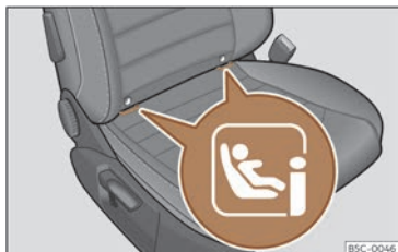
53. irudia Gidarikidearen eserlekua: i-Size sistemaren finkatze-uztaien kokapena.
