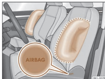
47. irudia Alboko airbaga gidariaren eta gidarikidearen eserlekuetan.
