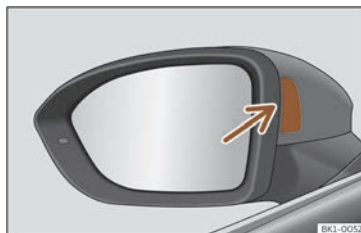
137. irudia Errei-aldaketarako laguntzailearen kontrol-argia.
