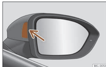
138. irudia Errei-aldaketarako laguntzailearen kontrol-argia.
