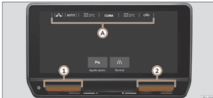
113. irudia Irudikapen eskematikoa: klimatizazio-funtzioak.
