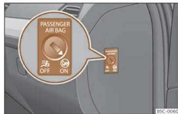
Fig. 43 Commutador amb clau per activar i desactivar el coixí de seguretat de l'acompanyant.
