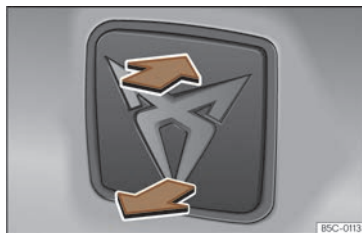
Fig. 89 Porta posterior: obertura des de fora.
