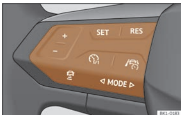
Fig. 124 Al volant multifunció: botons per controlar el limitador de velocitat.
