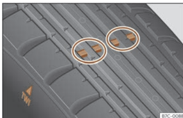
Fig. 196 Perfil del pneumàtic: indicadors de desgast.
