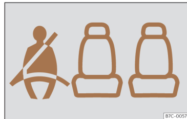
Fig. 34 Quadre d'instruments: indicació de l'estat dels cinturons de seguretat de les places del darrere.
