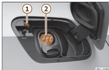
Fig. 68 Darrere de la tapa de càrrega de la bateria a la part posterior dreta: Presa de càrrega.
