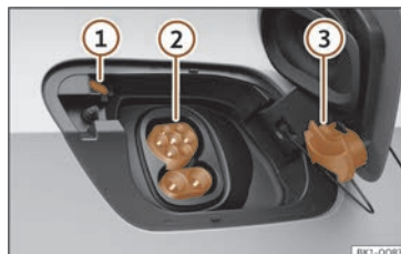
Fig. 69 Darrere de la tapa de la presa de càrrega de la bateria, a la part posterior dreta: presa de càrrega
