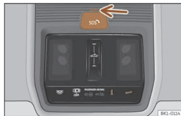
Fig. 61 A la consola del sostre: comandaments per als serveis de veu.
