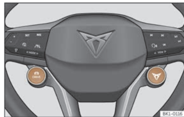
Fig. 117 Volant multifunció: Botons DRIVE i CUPRA per seleccionar i canviar el perfil de conducció.
