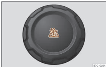
Fig. 192 Obertura davantera: tap del dipòsit d'expansió del líquid refrigerant.
