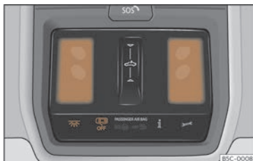
Fig. 105 Detall del revestiment del sostre: il·luminació davantera de l'habitacle.
