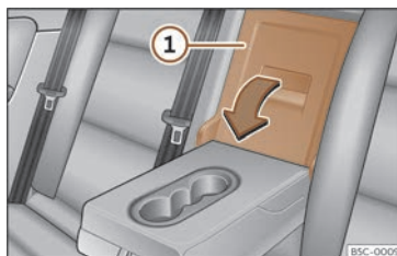
Fig. 175 Al respall del seient del darrere: obertura de la trapa.
