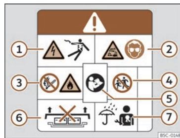
Fig. 64 Rètol d'avertiment a la bateria d'alt voltatge.
