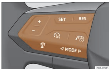
Fig. 126 Al volant multifunció: botons per fer servir l'ACC.
