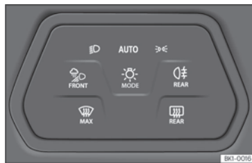
Fig. 103 Tauler d'instruments: comandament dels llums.
