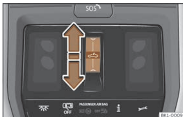
Fig. 112 Al revestiment interior del sostre: botó de funció per controlar la cortineta para-sol.
