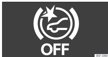
Fig. 132 A la pantalla del quadre d'instruments: indicació de Front Assist desactivat.
