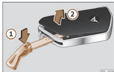
Fig. 80 Clau del vehicle: obrir la tapa del compartiment de la pila.
