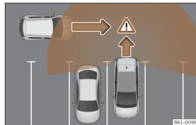
**Fig. 154** Representación esquemática del asistente de desaparcamiento: zona vigilada alrededor del vehículo que está desaparcando.
