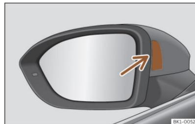
Fig. 156 En el retrovisor: testigo de advertencia.
