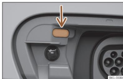
**Fig. 70** Detrás de la tapa de la toma de carga de la batería: indicador del proceso de carga.
