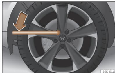
**Fig. 200** Cambio de rueda: aflojar los tornillos de rueda.
