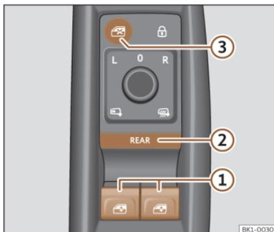
**Fig. 91** Detalle de la puerta del conductor: mandos para las ventanillas.
