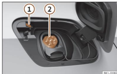
**Fig. 68** Detrás de la tapa de carga de la batería en la parte trasera derecha: Toma de carga.
