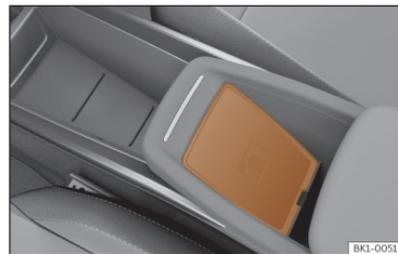
**Fig. 167** En la consola central: alojamiento para la conexión del teléfono móvil.
