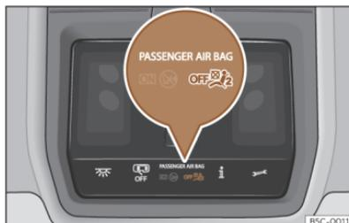
**Fig. 44** En la consola del techo: testigo de control de la desactivación del airbag del acompañante.
