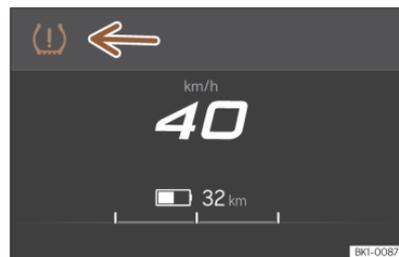
**Fig. 203** Cuadro de instrumentos: aviso de pérdida de presión de los neumáticos.
