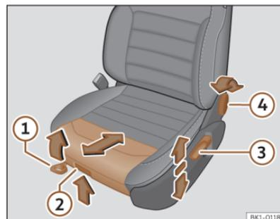
Fig. 95 Asientos delanteros: ajuste manual del asiento.
