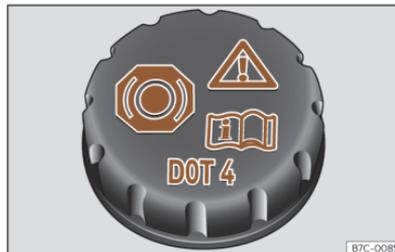
**Fig. 193** Vano delantero: tapón del depósito del líquido de frenos.
