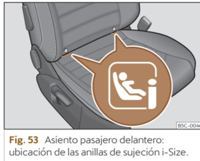
**Fig. 53** Asiento pasajero delantero: ubicación de las anillas de sujeción i-Size.
