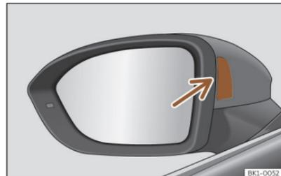
**Fig. 137** Testigo de control del asistente de cambio de carril.
