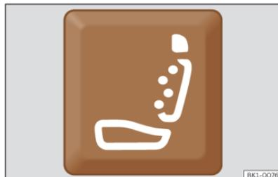
**Fig. 102** En la parte lateral inferior del asiento del conductor y acompañante: tecla de la función masaje.
