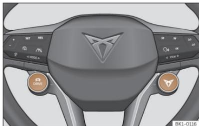
**Fig. 117** Volante multifunción: Botones DRIVE y CUPRA para seleccionar y cambiar el perfil de conducción.
