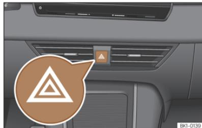
**Fig. 60** Tablero de instrumentos: conmutador de los intermitentes de emergencia.
