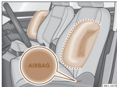
**Fig. 47** Airbag lateral en el asiento del conductor y del acompañante.
