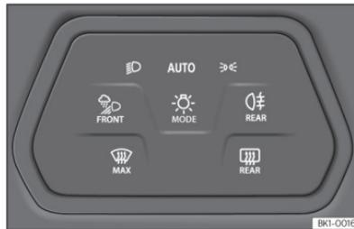
**Fig. 103** Tablero de instrumentos: mando de las luces.
