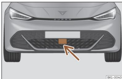
**Fig. 118** En el paragolpes delantero: sensor de radar.
