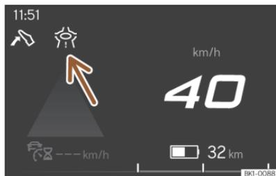
**Fig. 25** Indicación de la asistencia para una conducción ecoeficiente (representación esquemática).
