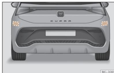
**Fig. 121** Vista trasera del vehículo: zonas de los sensores de radar.
