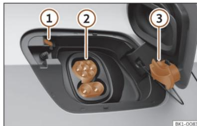
**Fig. 69** Detrás de la tapa de la toma de carga de la batería, en la parte trasera derecha: toma de carga.
