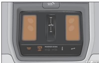
**Fig. 105** Detalle del revestimiento del techo: iluminación delantera del habitáculo.
