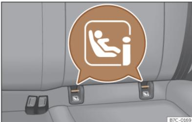
**Fig. 52** Asiento trasero: ubicación de las anillas de sujeción ISOFIX o i-Size.
