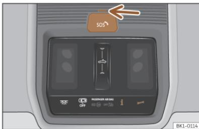
**Fig. 61** En la consola del techo: mandos para los servicios de voz.
