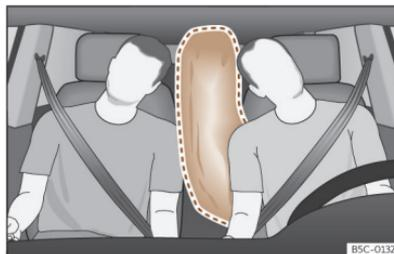
**Fig. 46** Airbag central completamente inflado (zona de despliegue).
