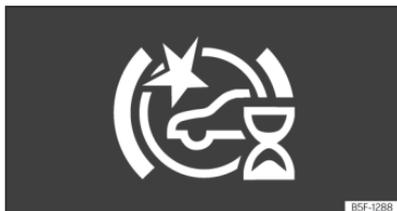
**Fig. 131** En la pantalla del cuadro de instrumentos: indicación de autocalibración inicial del sistema.
