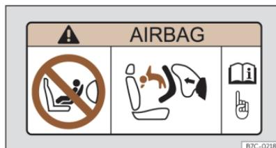
**Fig. 51** Adhesivo del airbag: en el parasol del lado del acompañante.
