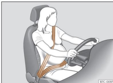
**Fig. 40** Colocación de la banda del cinturón en el caso de mujeres embarazadas.
