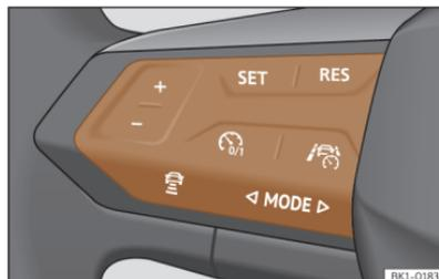
**Fig. 126** En el volante multifunción: botones para manejar el ACC.
