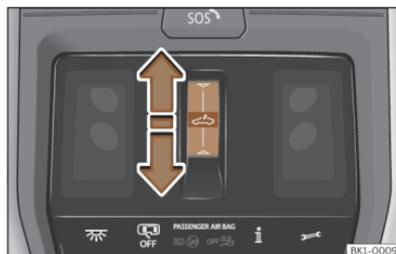
**Fig. 112** En el revestimiento interior del techo: botón de función para manejar la cortinilla parasol.
