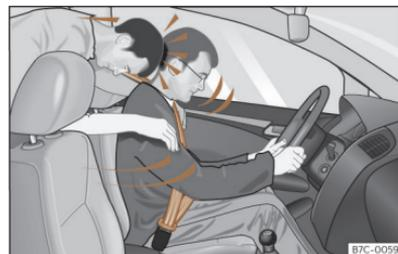
**Fig. 36** El ocupante del asiento trasero que no lleve puesto el cinturón de seguridad se verá proyectado hacia delante sobre el conductor que sí lleva el cinturón.
