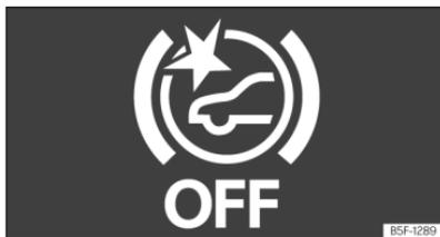
**Fig. 132** En la pantalla del cuadro de instrumentos: indicación de Front Assist desactivado.
