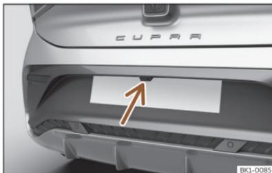
**Fig. 123** En el parachoques trasero: ubicación de la cámara del asistente para marcha atrás.
