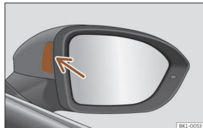
**Fig. 138** Testigo de control del asistente de cambio de carril.
