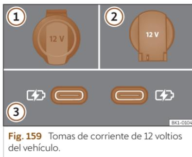
**Fig. 159** Tomas de corriente de 12 voltios del vehículo.
