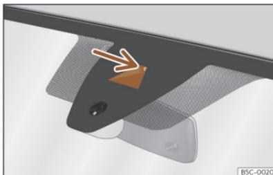
**Fig. 120** En el parabrisas: área de campo visual del sistema de aviso de salida del carril.
