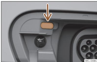
**Fig. 18** LED indicador del proceso de carga.
