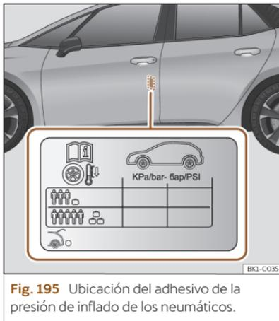
**Fig. 195** Ubicación del adhesivo de la presión de inflado de los neumáticos.
