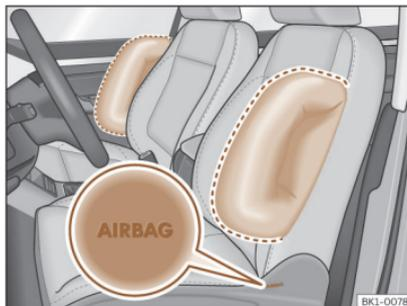
Fig. 29 Airbag lateral en el asiento del conductor y del acompañante.
