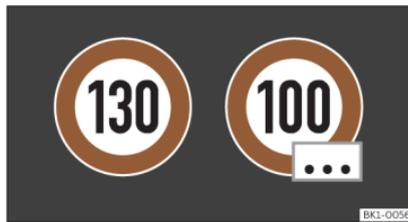
**Fig. 7** En la pantalla del cuadro de instrumentos: ejemplo de limitaciones de velocidad con panel complementario genérico.
