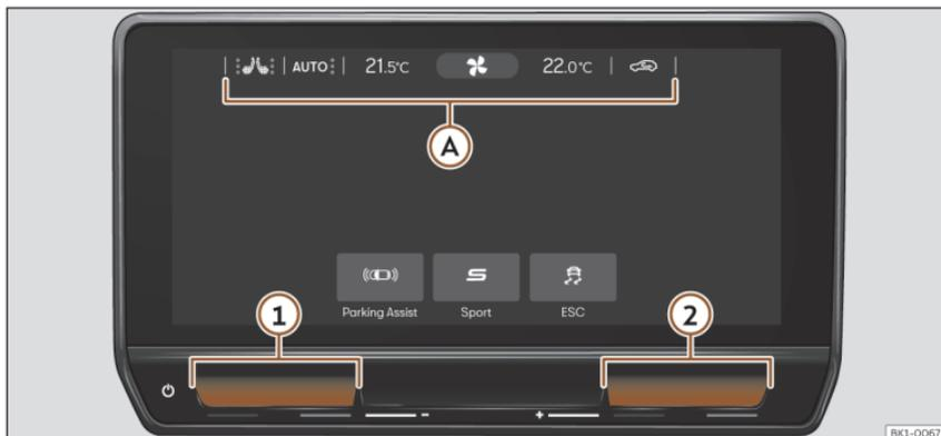
**Fig. 91** Representación esquemática: funciones de climatización
