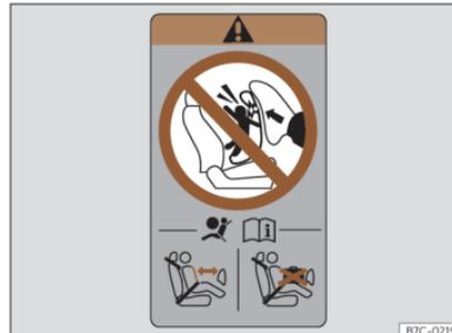
Fig. 34 Adhesivo del airbag: en el marco posterior de la puerta del acompañante
