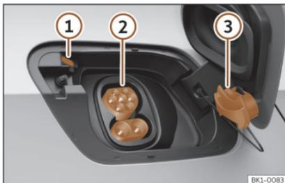
**Fig. 49** Detrás de la tapa de la toma de carga de la batería, en la parte trasera de la derecha: toma de carga.
