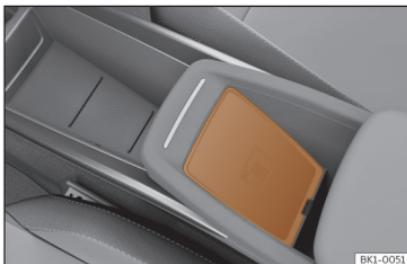
**Fig. 133** En la consola central: alojamiento para la conexión del teléfono móvil.
