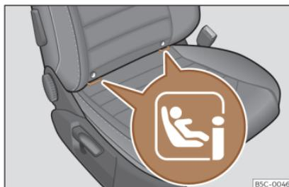
**Fig. 36** Asiento pasajero delantero: anillas de sujeción i-Size.
