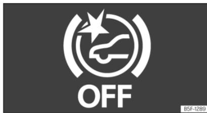
**Fig. 109** En la pantalla del cuadro de instrumentos: indicación de Front Assist desactivado.
