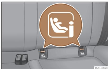
**Fig. 35** Asiento trasero: anillas de sujeción ISOFIX o i-Size.
