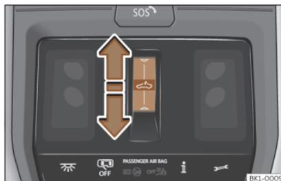
Fig. 90 En el revestimiento interior del techo: botón de función para manejar la cortinilla parasol.
