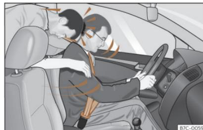
**Fig. 18** El ocupante del asiento trasero que no lleve puesto el cinturón de seguridad se verá proyectado hacia adelante sobre el conductor que sí lleva el cinturón.
