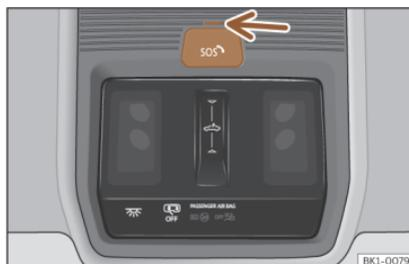
**Fig. 41** En la consola del techo: mandos para los servicios de voz
