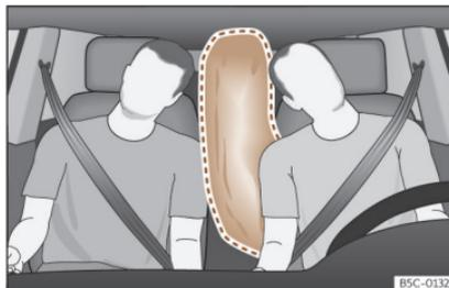
**Fig. 28** Airbag central completamente inflado (zona de despliegue).
