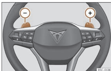
Fig. 94 Volante: pancas para cambio automático.
