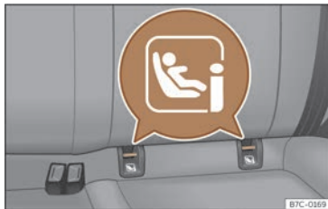
Fig. 35 Asento traseiro: localización dos aneis de fixación ISOFIX ou i-Size.
