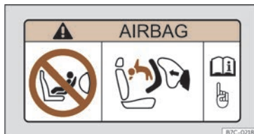
Fig. 33 Adhesivo do airbag: no parasol do lado do acompañante.
