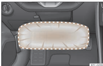
Fig. 31 No lado do condutor: radio de acción do airbag para os xeonllos.
