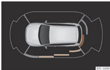
Fig. 129 Visualización de axuda ao aparcamento na pantalla do sistema de Infotainment.
