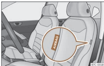
Fig. 27 Airbag lateral no asento do condutor.
