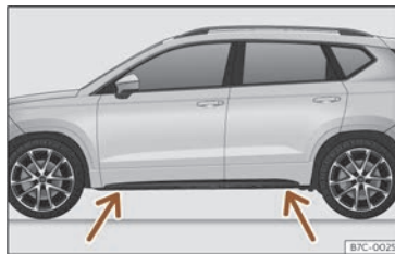
Fig. 210 Puntos de apoio do gato.
