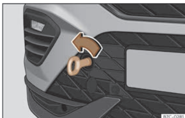
Fig. 184 Parte dereita do parachoques dianteiro: argola de remolque enroscada.
