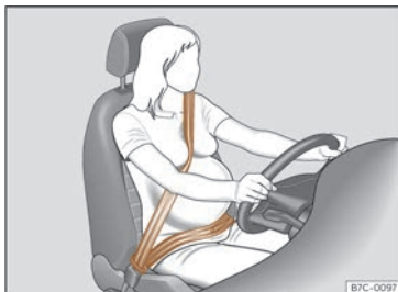
Fig. 22 Colocación da banda do cinto no caso das mulleres xestantes.
