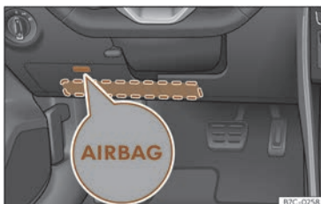
Fig. 30 No lado do condutor: localización do airbag para os xeonllos.
