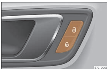
Fig. 49 Na porta do condutor: conmutador do peche centralizado.
