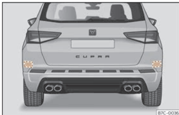
Fig. 104 Vista traseira do vehículo: áreas dos sensores de radar.
