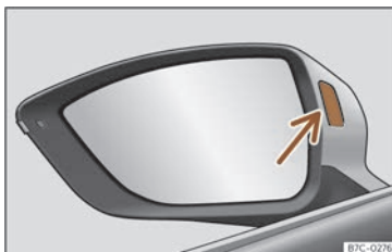
Fig. 120 Indicador de control do asistente de cambio de carril.
