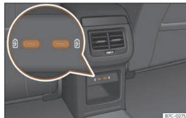
Fig. 150 Parte posterior consola central: conectores USB con función de toma de corrente.
