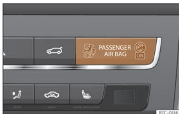
Fig. 26 Taboleiro de instrumentos: indicador de control da desactivación do airbag do acompañante.
