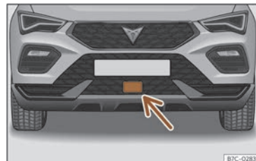
Fig. 101 No parachoques dianteiro: sensor de radar.
