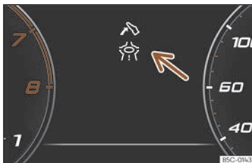
Fig. 7 Indicación da asistencia para unha condución ecoeficiente (representación esquemática).
