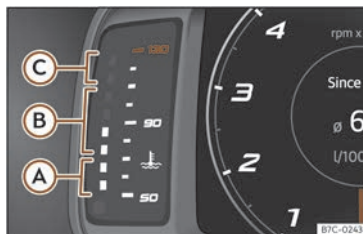
Fig. 4 Indicador de temperatura do líquido refrixerante do motor.
