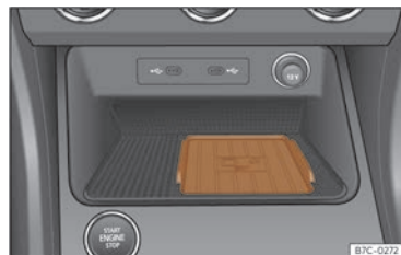
Fig. 156 Na consola central: aloxamento para a conexión do teléfono móbil.
