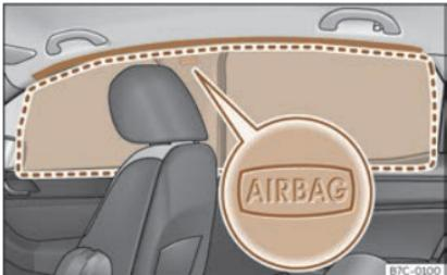
**Fig. 21** Localización dos airbags para a cabeza.
