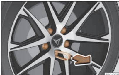
**Fig. 32** Rueda:parafusos da rueda con capuchóns.
