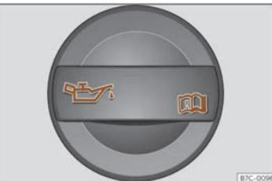
**Fig. 198** Tapón da boca de carga de aceite do motor no van motor.
