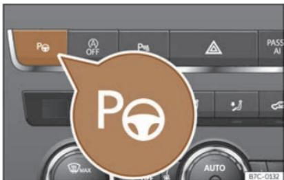
**Fig. 170** Na parte superior da consola central: tecla para conectar o sistema de aparcamento asistido.
