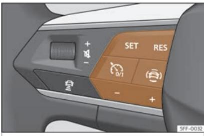
**Fig. 149** No volante multifunción:botóns para manexar o regulador de velocidade
