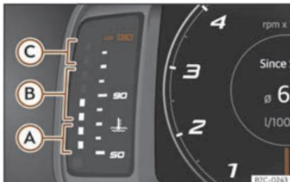
**Fig. 55** Indicador de temperatura do líquido refrixeante do motor.
