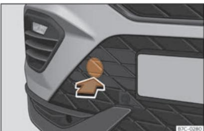
Fig. 41 No lado derecho do parachoques dianteiro:retirar a tapa.
