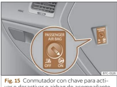
Fig. 15 Comutador con chave para activar e desactivar o airbag do acompañante.
