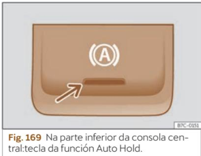
**Fig. 169** Na parte inferior da consola central:tecla da función Auto Hold.
