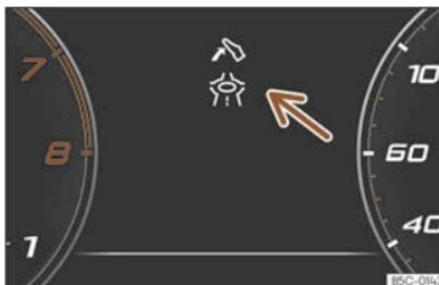
Fig. 53 Indicación de asistencia para unha conducción ecoeficiente (representación esquemática).
