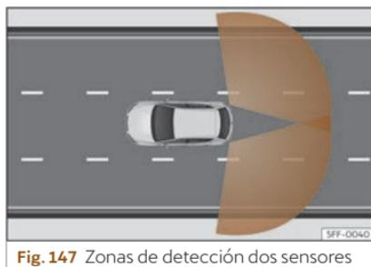
**Fig. 147** Zonas de detección dos sensores
