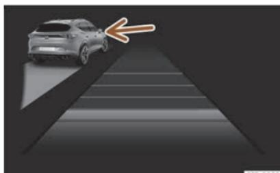
**Fig. 156** Na pantalla do cadro de instrumentos:ACC activo, vehículo detectado pola esquerda
