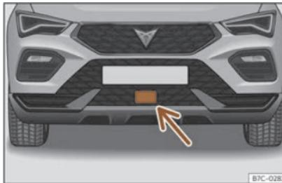
Fig. 143 No parachoques dianteiro:sensor de radar.
