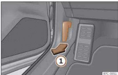
**Fig. 192** Panca de desbloqueo no espazo repousapés do condutor.
