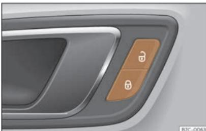
**Fig. 70** Porta do condutor:comutador do peche centralizado.
