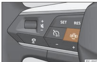
**Fig. 58** Lado esquerdo do volante multifunción:tecla para os sistemas de asistencia ao condutor (dependendo das versións).
