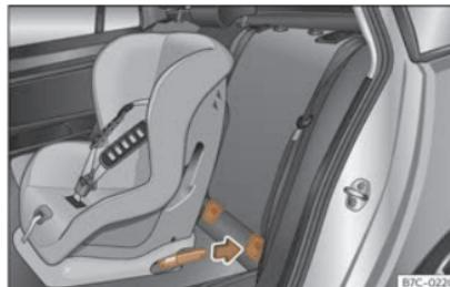
**Fig. 26** Asentos traseiros:colocación do asento para nenos con sistema ISOFIX.
