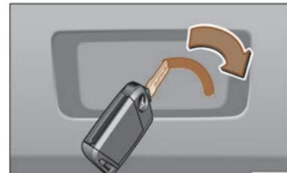
Fig. 82 Detalle do maleteiro:desbloqueo de emergencia.
