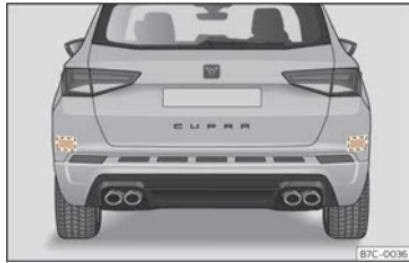
**Fig. 146** Vista traseira do vehículo:zonas dos sensores de radar.
