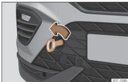
Fig. 42 No lado derecho do parachoques dianteiro:argola de remolque rosada.
