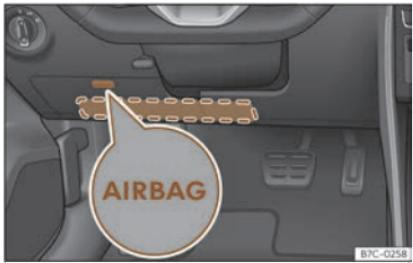
**Fig. 17** No lado do condutor:localización do airbag para os xeonllos.
