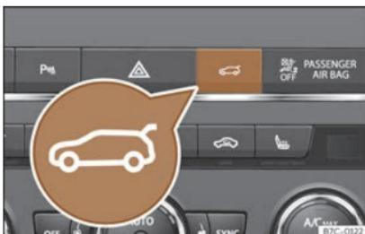
**Fig. 79** Consola central:tecla para abrir e pechar o portón traseiro.
