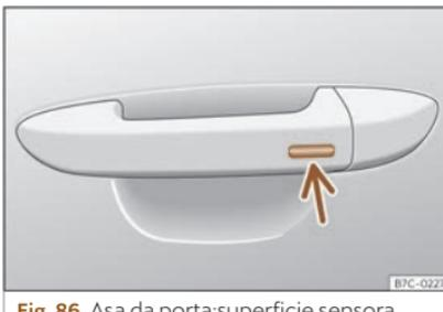
Fig. 86 Asa da porta:superficie sensora.
