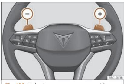
**Fig. 139** Volante:pancas para o cambio automático.
