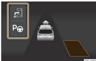
**Fig. 171** Na pantalla do cadre de instrumentos:visualización do sistema de aparcamiento asistido con visualización reducida.
