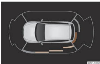
**Fig. 178** Visualización da axuda ao aparcamiento na pantalla do sistema de Infotainment.
