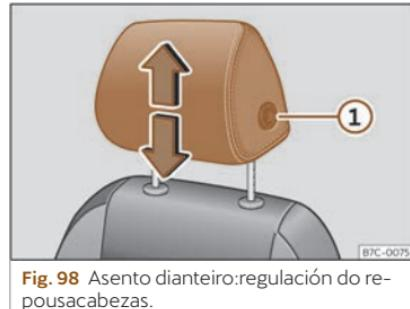
Fig. 98 Asento dianteiro:regulación do repousacabezas.
