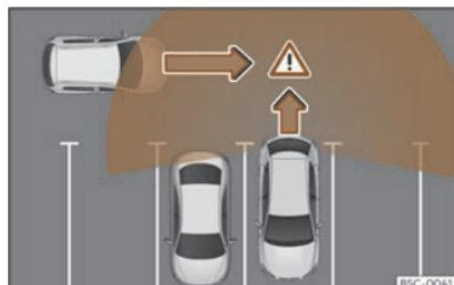
**Fig. 167** Representación esquemática do asistente de desaparcamento: zona vixida ao redor do vehículo que está a desaparcar.
