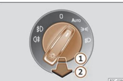
Fig. 88 Taboleiro de instrumentos:mando das luces.
