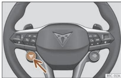
**Fig. 142** Volante multifunción:botón para cambiar o perfil de conducción.
