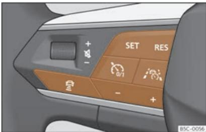
**Fig. 162** Lado esquerdo do volante multifunción: teclas para o manexo do Travel Assist.
