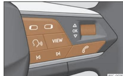
**Fig. 56** Lado derecho do volante multifunción:teclas para usar os menús e as indicacións informativas do cadre de instrumentos (segundo versión).
