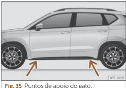
Fig. 35 Puntos de apoio do gato.
