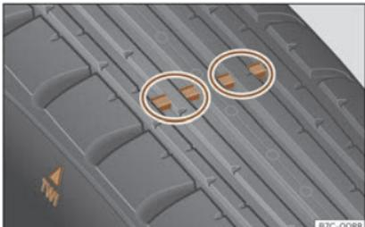
**Fig. 205** Perfil do pneumático:indicadores de desgaste.
