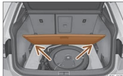
**Fig. 110** Piso variable do maleteiro:posición inclinada.
