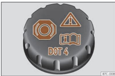
Fig. 201 Van motor:tapón do depósito do líquido de freos.
