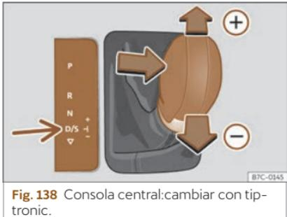
**Fig. 138** Consola central:cambiar con tiptronic.
