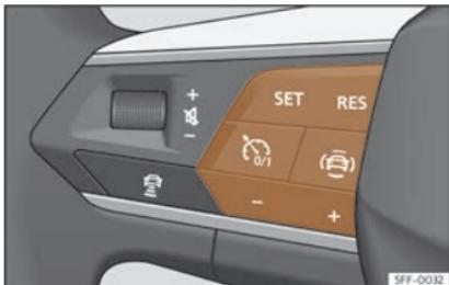
**Fig. 150** No volante multifunción:Botóns para manexar o limitador de velocidade.
