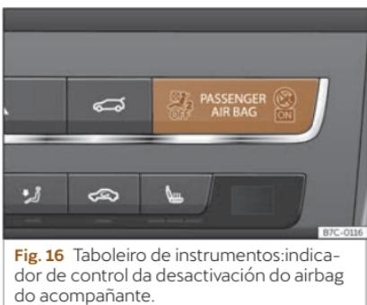
Fig. 16 Tablero de instrumentos: indicador de control da desactivación do airbag do acompañante.
