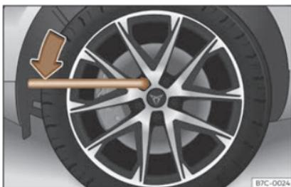
Fig. 34 Cambio de roda: afrouxar os parafusos de roda.
