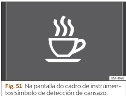
**Fig. 51** Na pantalla do cadro de instrumentos:símbolo de detección de cansazo.
