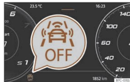
**Fig. 152** Na pantalla do cuadro de instrumentos:indicación de Front Assist desactivado.
