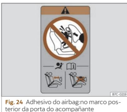
**Fig. 24** Adhesivo do airbag: no marco posterior da porta do acompañante
