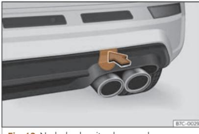
**Fig. 43** No lado dereito do parachoques traseiro: retirar a tapa.
