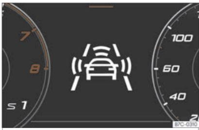
**Fig. 151** Na pantalla do cadro de instrumentos:indicacións de preaviso.
