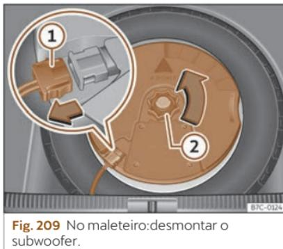
**Fig. 209** No maleteiro:desmontar o subwoofer.
