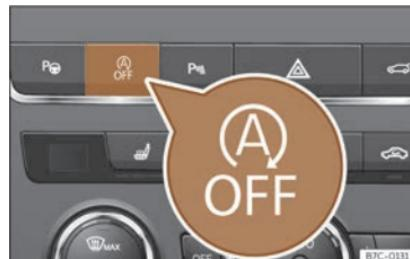
**Fig. 136** Consola central:tecla do sistema Start-Stop.
