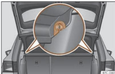
**Fig. 106** No maleteiro:desmontar e montar a bandexa.
