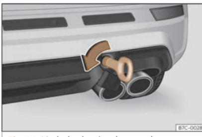
**Fig. 44** No lado dereito do parachoques traseiro: argola de remolque rosada.
