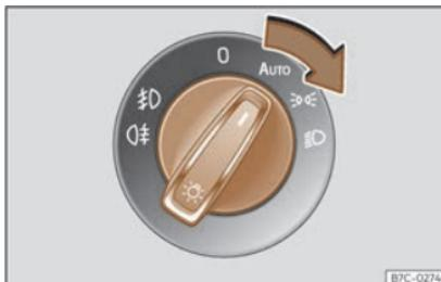
Fig. 87 Taboleiro de instrumentos:mando das luces.
