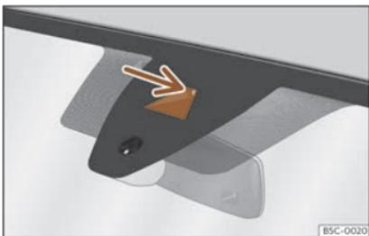
**Fig. 145** No parabrisas: área de campo visual do sistema de aviso de saída do carril.
