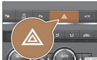
Fig. 90 Taboleiro de instrumentos:comutador dos intermitentes de emergencia.
