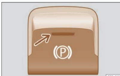
Fig. 168 Na parte inferior da consola central: tecla do freo de estacionamento electrónico.
