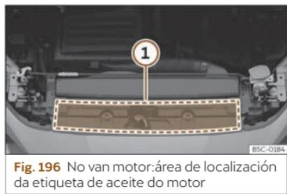
**Fig. 196** No van motor:área de localización da etiqueta de aceite do motor
