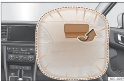
Fig. 14 Airbag do acompañante no tablero de instrumentos.
