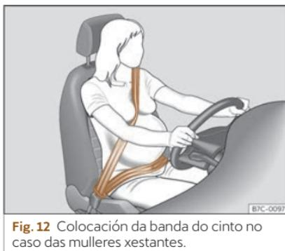
**Fig. 12** Colocación da banda do cinto no caso das mulleres xestantes.
