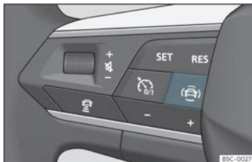
Fig. 64 Lado esquerdo do volante multifunción: tecla para os sistemas de asistencia ao condutor (dependendo das versións).
