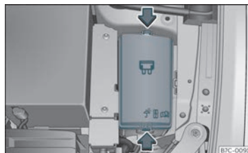
Fig. 47 No van motor: tapa da caixa de fusibles.
