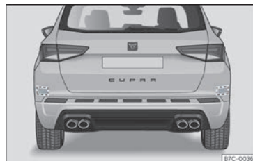
Fig. 151 Vista traseira do vehículo: zonas dos sensores de radar.
