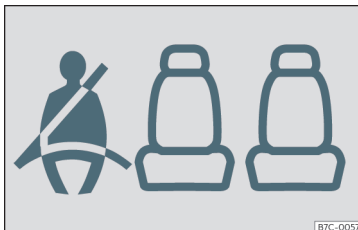
Fig. 5 Cadro de instrumentos: indicación de praza posterior esquerda ocupada e abrochado o cinto correspondente.
