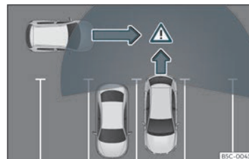
Fig. 174 Representación esquemática do asistente de desaparcamento: zona vixiada ao redor do vehículo que está a desaparecer.
