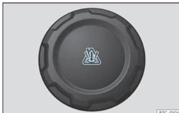
Fig. 205 Van motor: tapón do depósito de expansión do líquido refrixerante.
