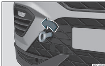
Fig. 42 No lado dereito do parachoques dianteiro: argola de remolque roscada.
