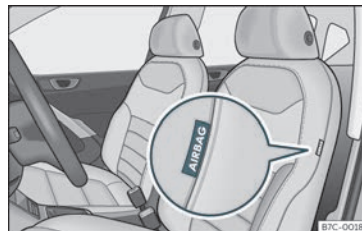
Fig. 19 Airbag lateral no asento do condutor.
