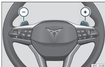
Fig. 144 Volante: palancas para o cambio automático.
