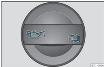
Fig. 203 Tapón da boca de carga de aceite do motor no van motor.
