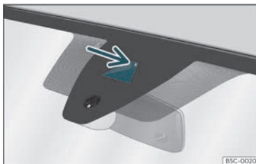
Fig. 150 No parabrisas: área de campo visual do sistema de aviso de saída do carril.
