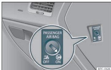
Fig. 15 Conmutador con chave para activar e desactivar o airbag do acompañante.
