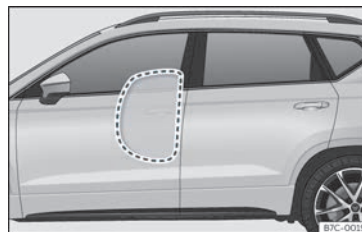
Fig. 20 Airbags laterais totalmente inflados no lado esquerdo do vehículo.
