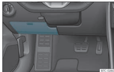
Fig. 45 Vehículos con volante á esquerda: tapa da caixa de fusibles debaixo do taboleiro de instrumentos do lado do condutor
