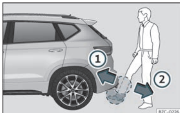
Fig. 85 Portón do maleteiro con apertura controlada por sensor (Easy Open).
