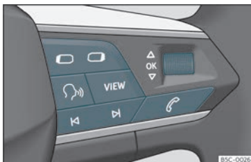
Fig. 62 Lado dereito do volante multifunción: teclas para usar os menús e as indicacións informativas do cadro de instrumentos.
