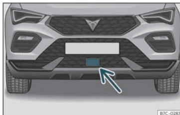
Fig. 148 No parachoques dianteiro: sensor de radar.
