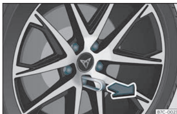
Fig. 32 Roda:parafusos da roda con capuchóns.
