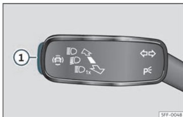
Fig. 63 Na panca de intermitentes e de luz de estrada: tecla para os sistemas de asistencia ao condutor (dependendo das versións).
