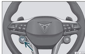
Fig. 147 Volante multifunción*: botón para cambiar o perfil de condución.
