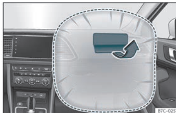
Fig. 14 Airbag do acompañante no taboleiro de instrumentos.
