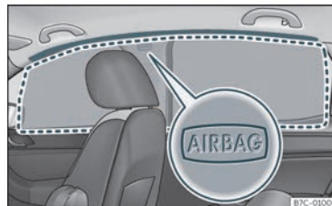
Fig. 21 Localización dos airbags para a cabeza.
