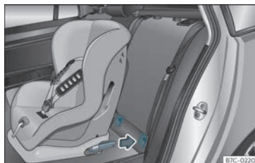
Fig. 26 Asentos traseiros: colocación do asento para nenos co sistema ISOFIX.
