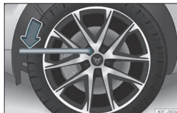
Fig. 33 Cambio de roda:afrouxar os parafusos de roda.
