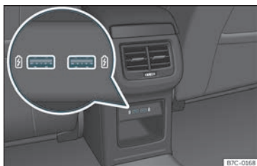
Fig. 196 Parte posterior consola central: conectores USB.
