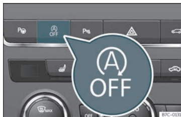
Fig. 200 Consola central: tecla do sistema Start-Stop.
