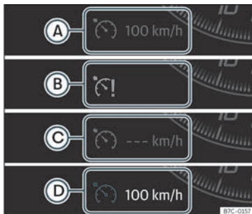
Fig. 206 Pantalla do cadro de instrumentos: indicacións de estado do GRA.
