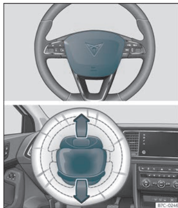
Fig. 13 Airbag do condutor no volante.
