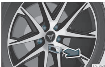
Fig. 31 Roda:parafusos da roda con capuchóns.
