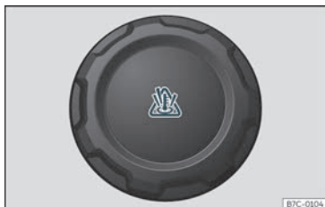
Fig. 261 Van motor: tapón do depósito de expansión do líquido refrixerante.
