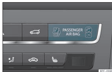
Fig. 16 Taboleiro de instrumentos: indicador de control da desactivación do airbag do acompañante.
