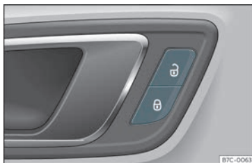
Fig. 71 Porta do condutor: conmutador do peche centralizado.
