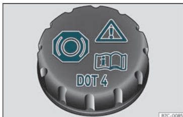
Fig. 262 Van motor: tapón do depósito do líquido de freos.
