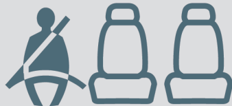
Fig. 5 Cadro de instrumentos: indicación de praza posterior esquerda ocupada e abrochado o cinto correspondente.
