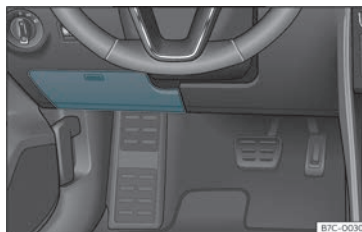
Fig. 44 Vehículos con volante á esquerda: tapa da caixa de fusibles debaixo do taboleiro de instrumentos do lado do condutor
