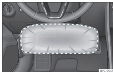
Fig. 18 No lado do condutor: radio de acción do airbag para os xeonllos.
