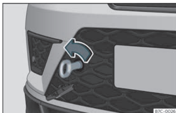
Fig. 41 No lado dereito do parachoques dianteiro: argola de remolque roscaada.
