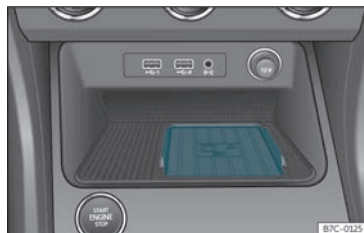
Fig. 197 Na consola central: aloxamento para a conexión do teléfono móbil.
