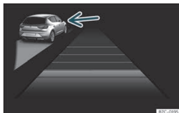
Fig. 220 Na pantalla do cadro de instrumentos: ACC activo, vehículo detectado pola esquerda
