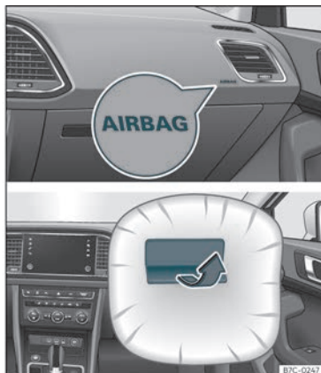
Fig. 14 Airbag do acompañante no taboleiro de instrumentos.
