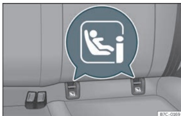
Fig. 25 Asento traseiro: aneis de suxeición ISO-FIX/i-Size.
