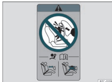
Fig. 24 Adhesivo do airbag: no marco posterior da porta do acompañante
