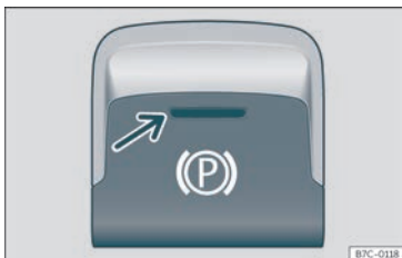
Fig. 231 Na parte inferior da consola central: tecla do freo de estacionamento electrónico.
