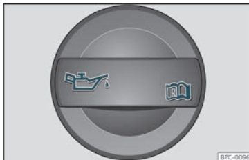
Fig. 259 Tapón da boca de carga de aceite do motor no van motor.
