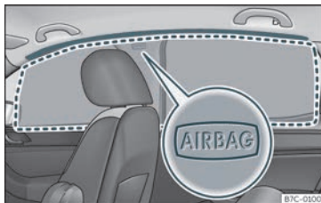
Fig. 21 Localización dos airbags para a cabeza.
