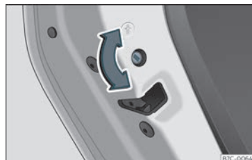
Fig. 77 Seguro para nenos da porta da esquerda.
