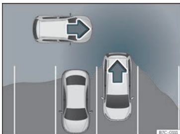
Fig. 230 Representación esquemática do asistente de desaparcamento: zona vixiada ao redor do vehículo que está a desaparcarse.
