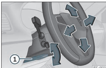
Fig. 4 Panca na parte inferior do lado esquerdo da columna de dirección.
