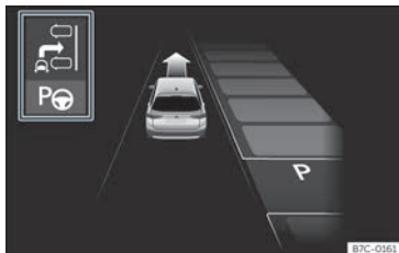
Fig. 234 Na pantalla do cadro de instrumentos: visualización do sistema de aparcamento asistido con visualización reducida.
