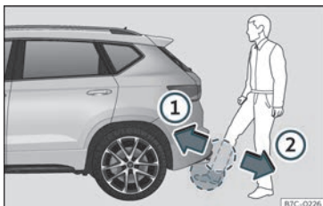
Fig. 81 Portón do maleteiro con apertura controlada por sensor (Easy Open).
