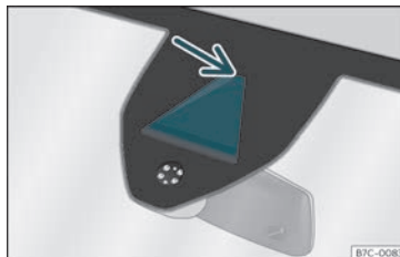
Fig. 223 No parabrisa: área de campo visual do sistema de aviso de saída do carril.
