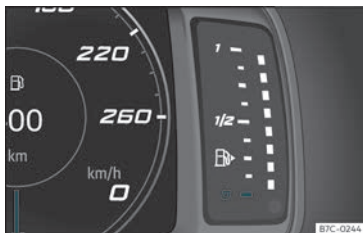
Fig. 60 Indicador do nivel de combustible.
