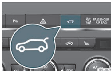
Fig. 80 Consola central: tecla para abrir e pechar o portón traseiro.
