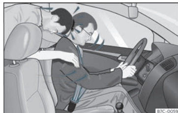
Fig. 8 O ocupante do asento traseiro que non leve posto o cinto de seguridade será lanzado cara adiante sobre o condutor que leva o cinto.
