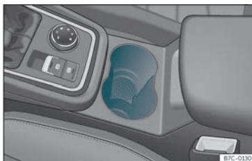
Fig. 120 Consola central:portabebidas dianteiro.
