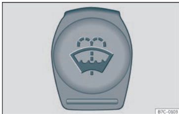
Fig. 263 No van motor: tapón do depósito de limpacristais.
