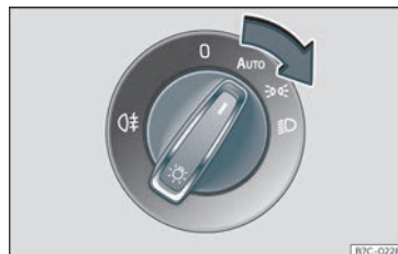
Fig. 88 Taboleiro de instrumentos: mando das luces.
