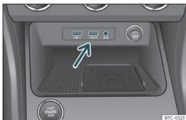
Fig. 195 Consola central: entrada USB/AUX-IN.
