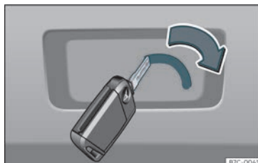
Fig. 83 Detalle do maleteiro: desbloqueo de emerxencia.
