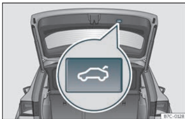
Fig. 79 Portón traseiro: tecla para pechar o portón.
