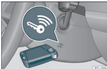
Fig. 199 Á dereita da columna de dirección::arranque de emerxencia
