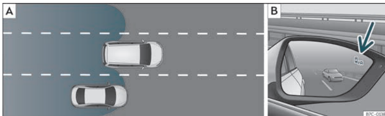
Fig. 229 Representación esquemática: A Situación nun adelantamento e posterior incorporación ao carril dereito. B Indicación do asistente de ángulo morto no retrovisor exterior dereito.
