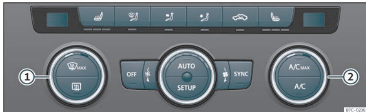
Fig. 123 Na consola central:mandos do Climatronic.
