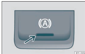
Fig. 232 Na parte inferior da consola central: tecla da función Auto Hold.
