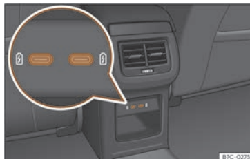
133 ir. Kotsola zentralaren atzeko atala: korrante-harguneko funtzioa duten USB konektoreak.
