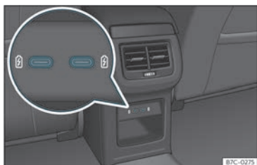
138 ir. Kotsola zentralaren atzeko atala:korronte-harguneko funtzioa duten USB konektoreak.
