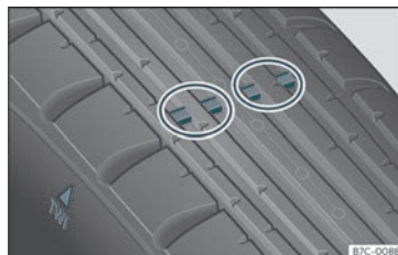
210 ir. Pneumatikoen profila:higadura-seinaleak.
