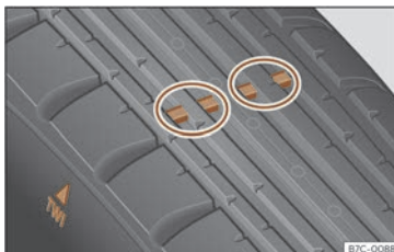
Fig. 203 Perfil del pneumàtic: indicadors de desgast.
