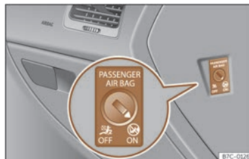
Fig. 25 Commutador amb clau per activar i desactivar el coixí de seguretat de l'acompanyant.
