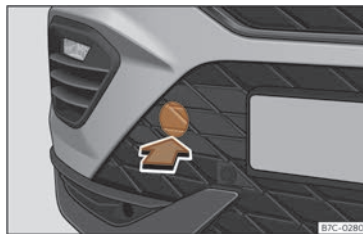
Fig. 183 A la part dreta del para-xocs davanter: retirar la tapa.
