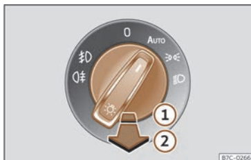
Fig. 79 Tauler d'instruments: comandament dels llums.
