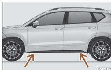
Fig. 210 Punts de suport del gat.
