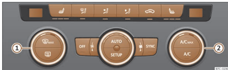
Fig. 86 A la consola central: comandaments del Climatronic.
