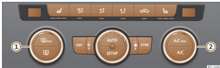
Fig. 125 A la consola central: comandaments del Climatronic
