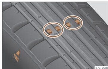
Fig. 208 Perfil del pneumàtic: Indicadors de desgast.
